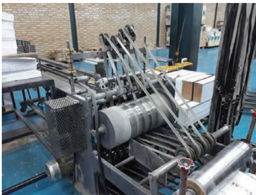
شکل ۴۸- سیلندر پرس و دسته کن (Stacker)
