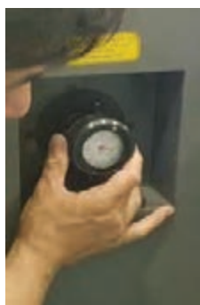
شکل ۳۸- گیج تغییر زاویه سیلندر ترانسفر
