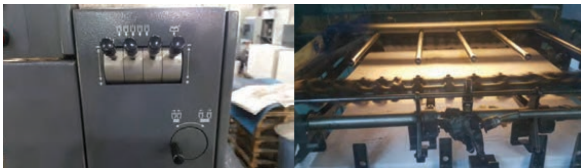
شکل ۴۸- دستگیره‌های تنظیم دمنده
