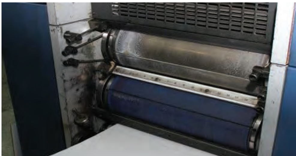
شکل ۶۸- سیلندر آماده بستن پلیت
