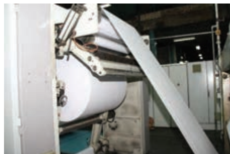
شکل ۹- سیستم عملکرد تغذیه بدون توقف (Splicer)
