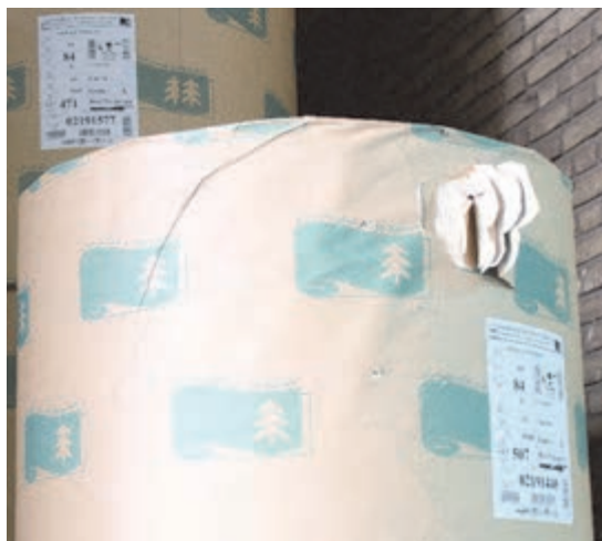
شکل ۶- خراش و پارگی روی بدنه رول
