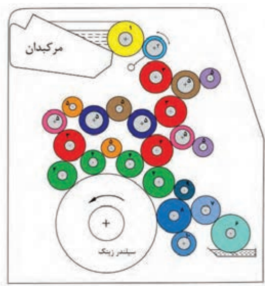
شکل ۱۵- نمایش نوردهای آب و مرکب در ماشین الکلی
