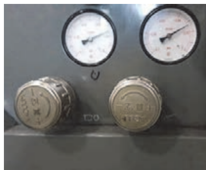
شکل ۴۲- شیر تنظیم مکش (شیر سمت چپ)
