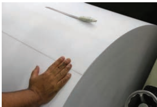
شکل ۱۶- تا کردن لبه رول
