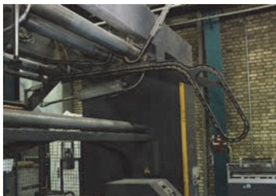
شکل ۲۶- سیستم کاغذ کشی زنجیری
