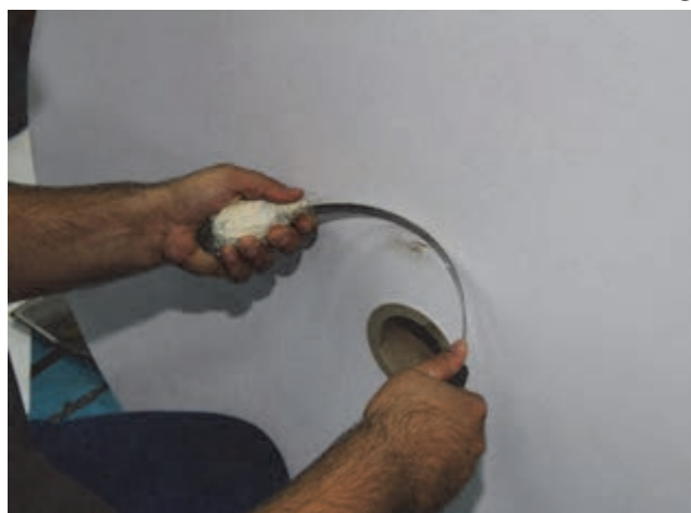
شکل ۵- برطرف کردن آسیب روی بدنه رول
