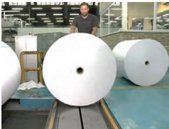
شکل ۱۵- انتقال رول از ریل به روی واگن
