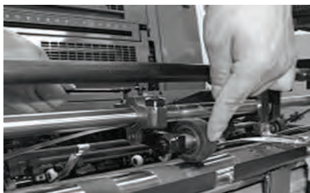
شکل ۳۲- تنظیم فشار قرقره
