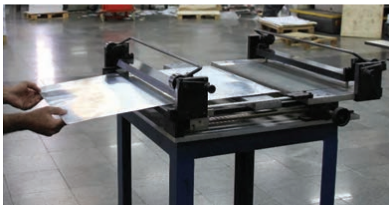
شکل ۶۲- قرار دادن پلیت در دستگاه خم‌کن
