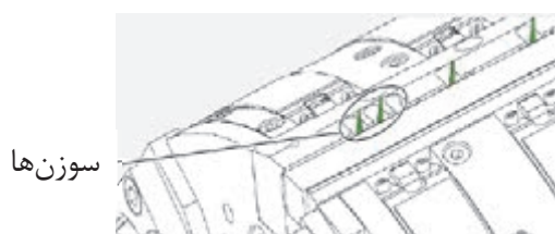
شکل ۳۸- سوزن‌های روی سیلندر
