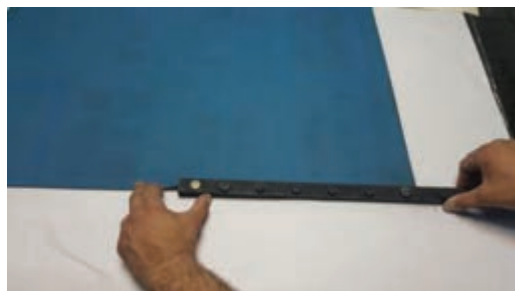
شکل ۵۹- نصب گیره لاستیک
