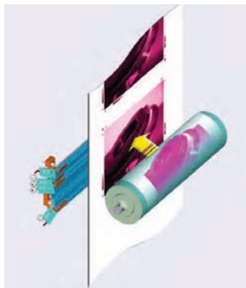
شکل ۳۵- انتقال تصویر روی سطح چاپ شونده
