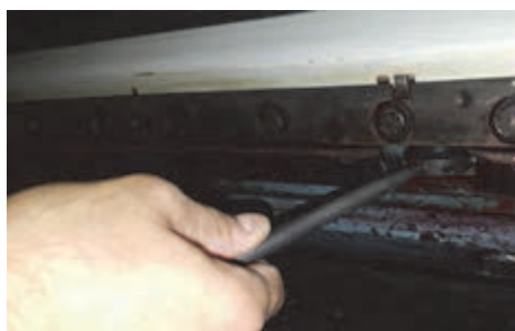
شکل ۸۱- پیچ تنظیم لبه کار
