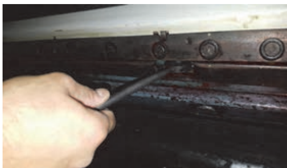
شکل ۸۴- پیچ تنظیم گیره
