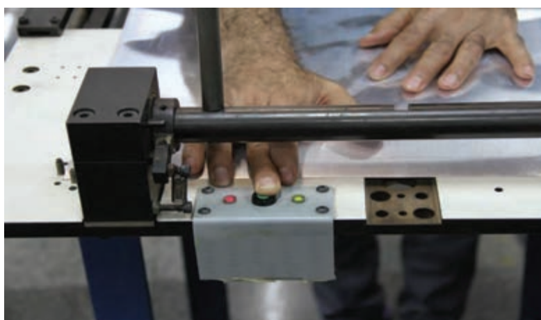
شکل ۶۰- حسگرهای لب کار پلیت
