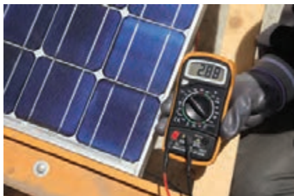
شکل ۷- ب - اثر سایه بر جریان اتصال کوتاه
