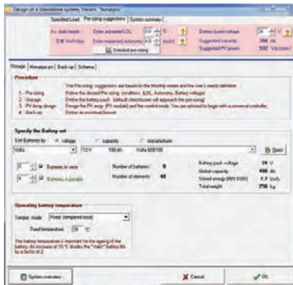
شکل ۳۷- تعریف و انتخاب صحیح باتری در نرم‌افزار
