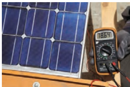
شکل ۷- الف - اثر سایه بر ولتاژ بی‌باری
