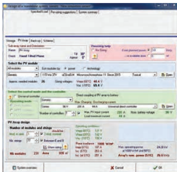
شکل ۳۸- مقادیر مدول PV، کنترل شارژ
