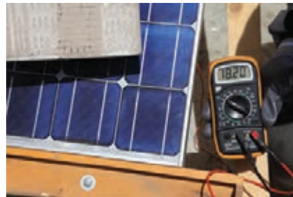
شکل ۷- الف - اثر سایه بر ولتاژ بی‌باری
