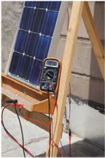
شکل ۱۵-۱- اندازه‌گیری ولتاژ بی‌باری
