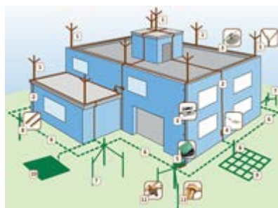
شکل ۳۸ – پراکنده کردن صاعقه در زمین
