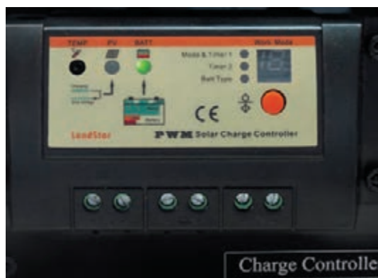
شکل ۳۶- با اتصال باتری LED روشن می شود.
