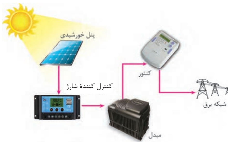
شکل ۵۱- نقشه ارتباط عناصر سیستم فتوولتائیک On_Grid
