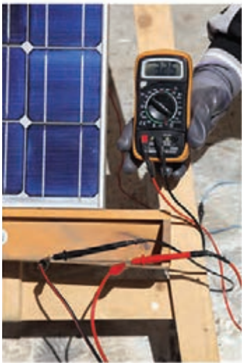
شکل ۱۵-۲- اندازه‌گیری جریان اتصال کوتاه
