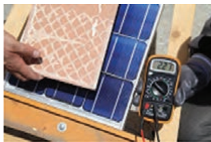
شکل ۷- ب - اثر سایه بر جریان اتصال کوتاه
