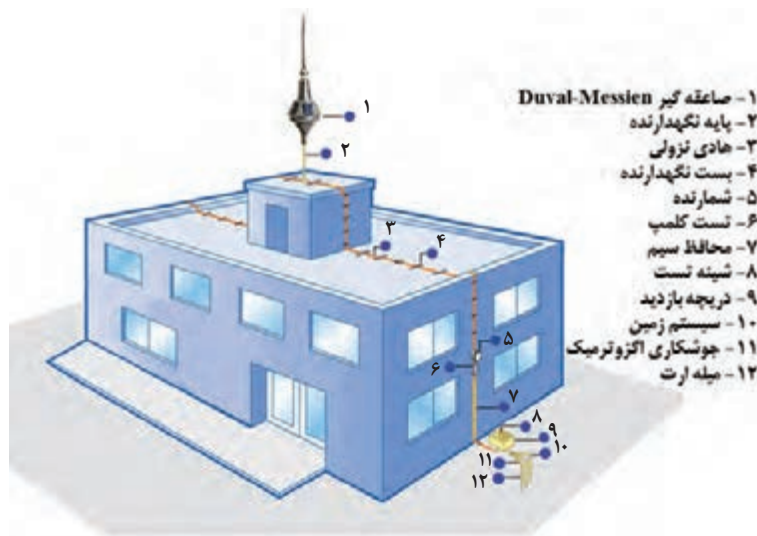
شکل ۴۱- تجهیزات صاعقه گیر
