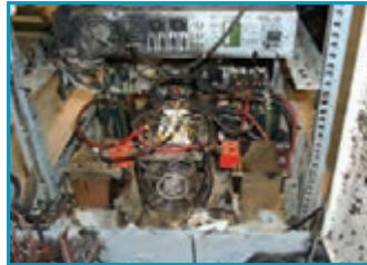
شکل ۳۴ – سوختگی در اثر صاعقه
