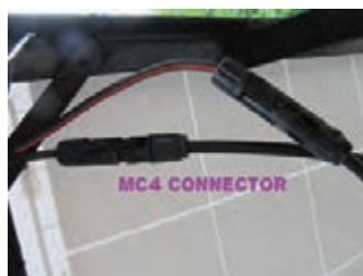
شکل ۲۸- اتصال کانکتور MC۴
