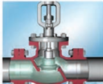
شیر کف فلزی (Globe Valve)
