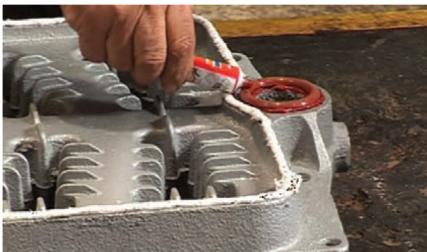
شکل ۲۰- استفاده از اورینگ به جای بوش
