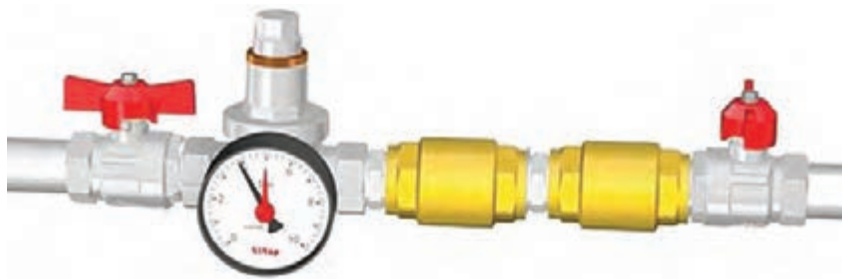
شکل ۱۷- مدار تغذیه سیستم گرمایش
