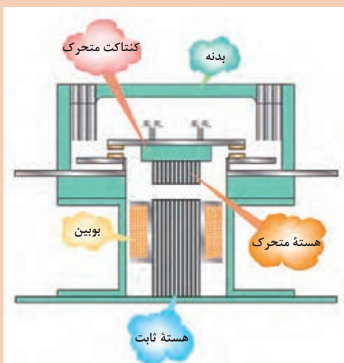
شکل ۵- کنتاکتور
