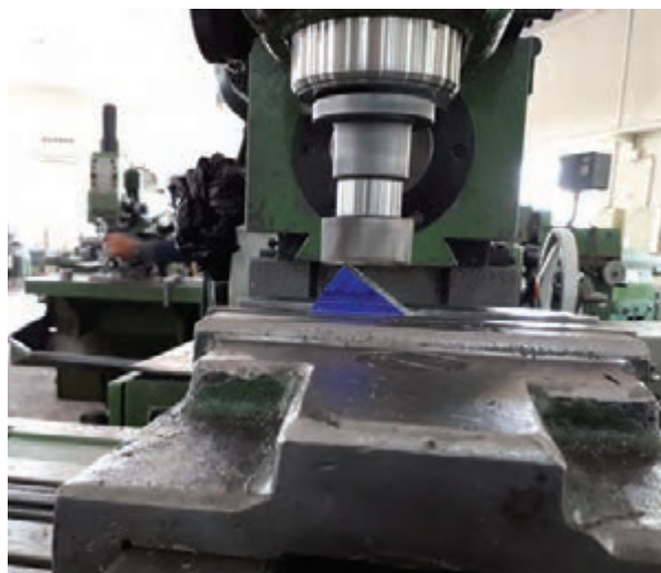
شکل ۱۸- خط کشی و بستن قطعه در گیره
