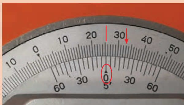
شکل ۱۱- اندازه‌گیری با زاویه‌سنج
