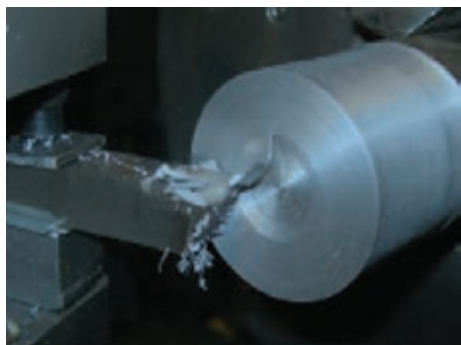
شکل ۲-۲۸- تراشکاری قطعات کوتاه
