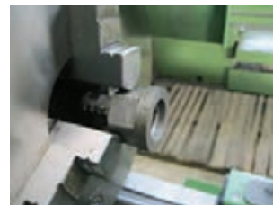
الف: بستن قطعه شش گوش در سه نظام
