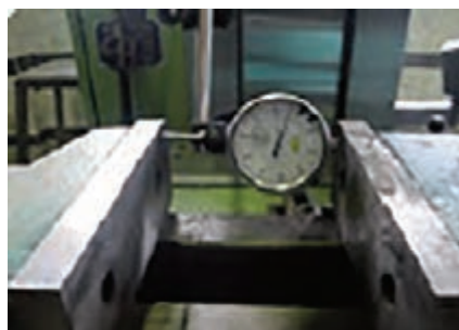
تنظیم گیره به کمک ساعت اندازه‌گیری
