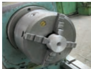
ب: بستن قطعه گرد در چهار نظام
