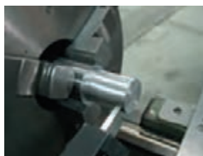
الف) مماس کردن رنده به پیشانی کار
