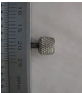
شکل ۲-۴۱- نمونه کار آج زنی
