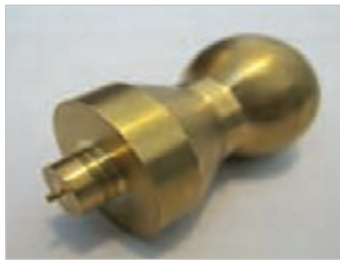
شکل ۲-۳۹- نمونه کار شیار و برش
