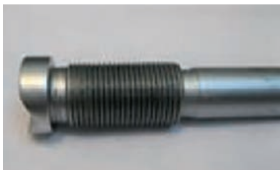
شکل ۲-۳۴- نمونه کار شیار تراشی
