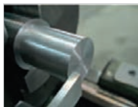
ب) حرکت طولی برای موقعیت شیار
