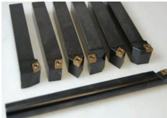
شکل ۲-۲۰ تیغچه بسته شده در نگه دارنده (هولدر)
