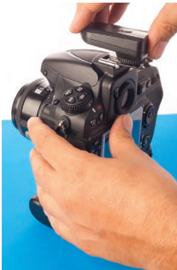
▲ اتصال ریموت فرستنده به دوربین | تصویر ۱۳۵
