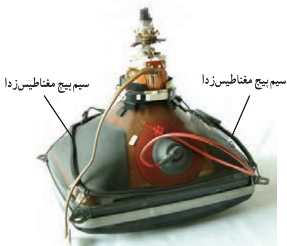
شکل ۱۰۵- مدار سیستم دگوسینگ در تلویزیون گروندیک
