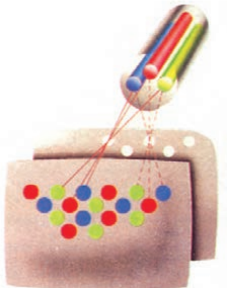
شکل ۲۰-۱ تفنگ الکترونی لامپ تصویر مثلثی ( \Delta )
