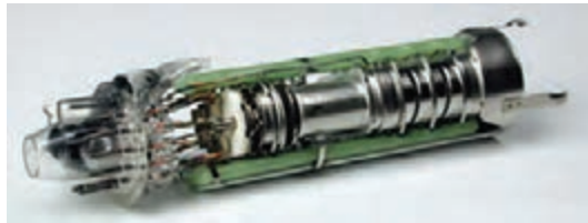
شکل ۱-۵ تفنگ الکترونی تلویزیون رنگی
