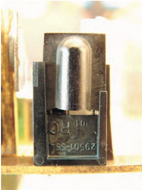
شکل ۳-۱۴ آی سی گیرنده مادون قرمز
