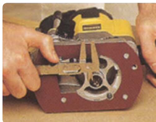
شکل ۶۸-۲ اندازه‌گیری قطر شفت اور فرز
