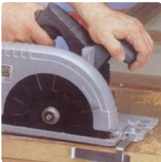
شکل ۲-۲۰ بکارگیری اره گرد دستی برقی
