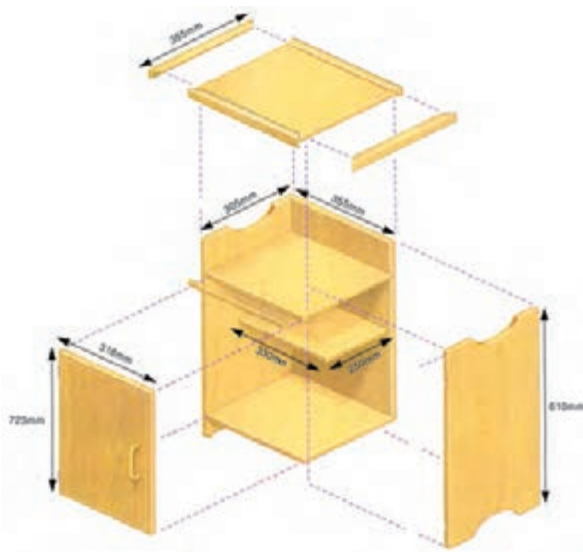
شکل ۸-۳۵ نقشه مونتاژ قطعات کابینت
