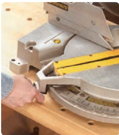
شکل ۲-۸ تنظیم زوایای مختلف برش
