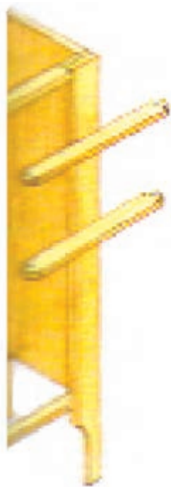
شکل ۸-۶۳ موقعیت قیدهای عرضی داخلی در کابینت پایه‌دار
