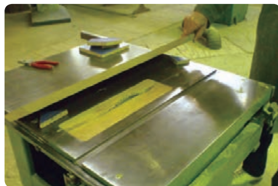
شکل ۳-۳۹ قراردادن دوعدد زیرسری برای ساخت گونیا
