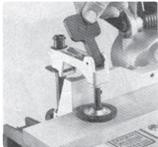
شکل ۲-۱۱- بستن قطعه کار با گیره
