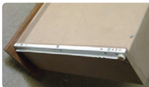
شکل ۶-۱۱۲ نصب ریل مکانیکی در زیر بدنه جعبه
