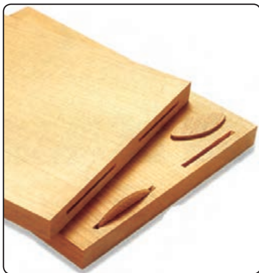
شکل ۸۲-۲ اتصال بیسکوییتی دوتایی
