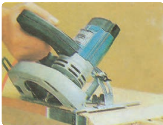
شکل ۳۷-۲ برش تحت زاویه به وسیله گونیای دستگاه
