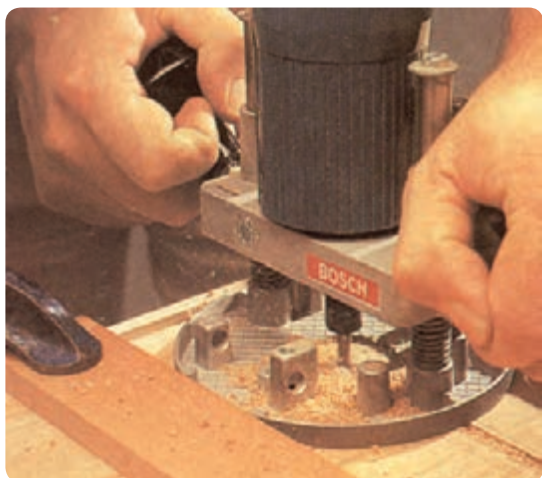
شکل ۶-۱۴۱ درآوردن کنشکاف روی بدنه جهت اتصال بدنه کابینت
