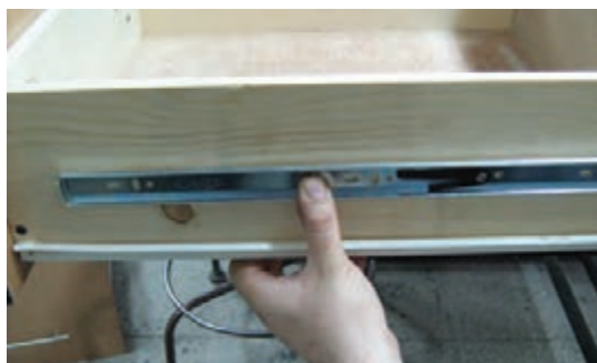
شکل ۷-۳۵ تعیین محل ریل بر روی بدنه کشو
