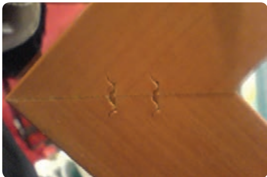
شکل ۹۴-۶ اتصال دوخت قاب
