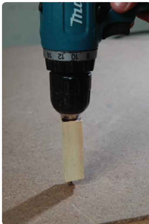
شکل ۳-۳۲ سوراخ دریل قطعه کنترل اندازه عمق
