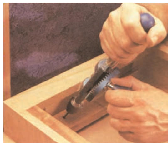
شکل ۶-۱۶۱ مونتاژ صفحه میز به قاب دراور
