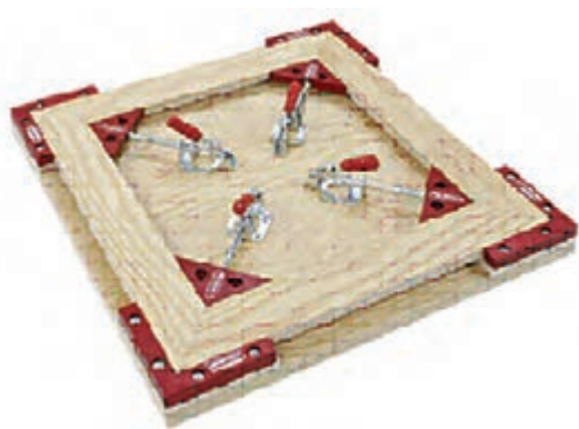
شکل ۳۵-۳ مونتاژ قاب
