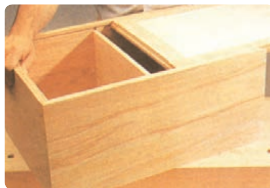
شکل ۱۴۳-۶ قرارگیری پشت بند در کنشکاف بدنه کابینت
