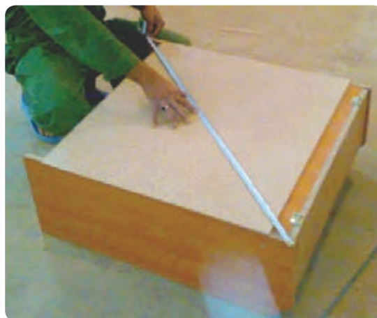
شکل ۶-۱۳۰ کنترل دویدگی کابینت
