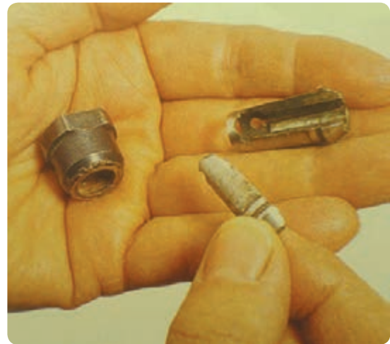
شکل ۴۱-۲ بوش تیغه اور فرز همراه با مهره سفت‌کننده تیغه روی شفت دستگاه
