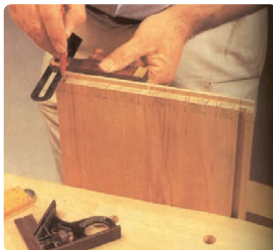
شکل ۶-۱۳۶ خط‌کشی اتصال دم‌چلچله دورو مخفی
