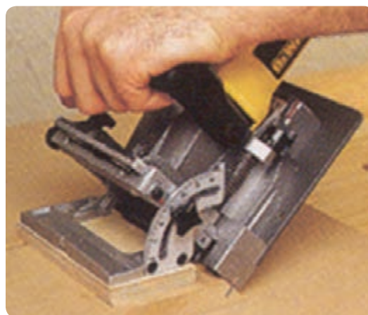
شکل ۹۰-۲ شیارزنی با زاویه ۴۵ درجه
