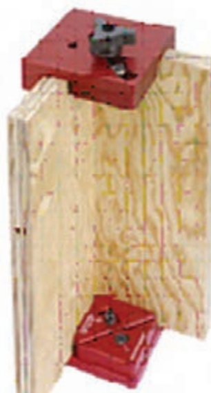
شکل ۳۶-۳ مونتاژ پانل‌های عمودی
