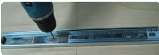
شکل ۷-۳۳ سوراخ‌کاری محل استقرار ریل روی بدنه فایل
