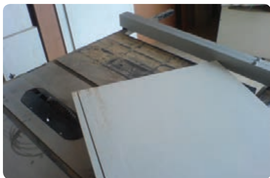
شکل ۶-۶۹- کنشکاف زدن جهت پشت بند
