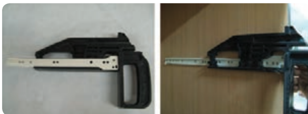
شکل ۷-۲۷ گونیای مخصوص نصب ریل
