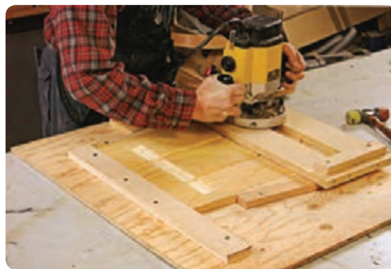
شکل ۳-۲۹ شابلون تسریع‌کننده و حفاظتی اورفرز
