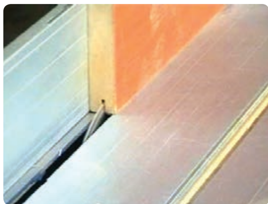
شکل ۶-۹۰ دو راهه‌کردن با ماشین اره مجموعه‌ای
