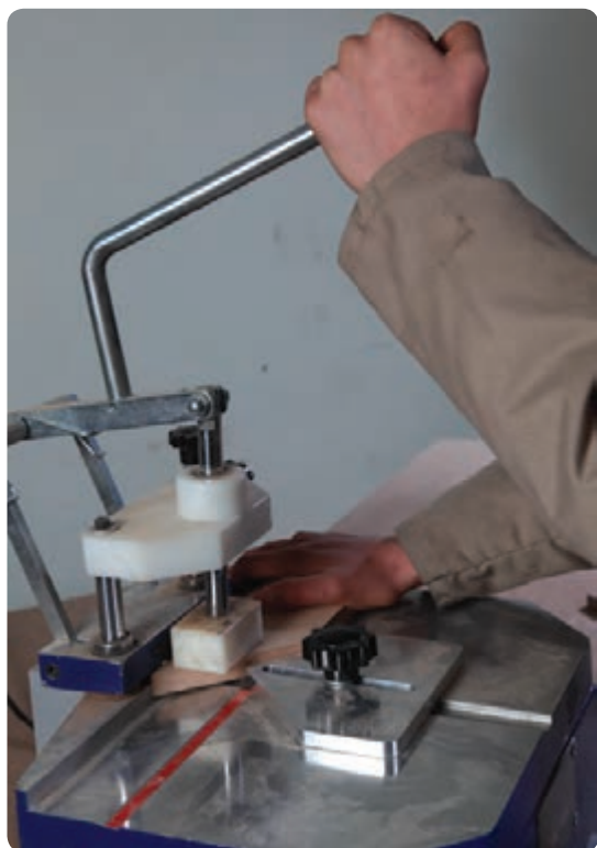
شکل ۹۳-۶ اتصال دم چلچله زن پروفیل
