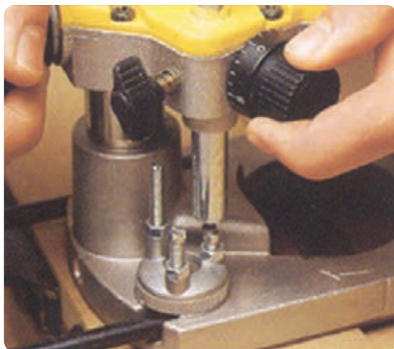
شکل ۷۲-۲ پیچ‌های تنظیم دستگاه
