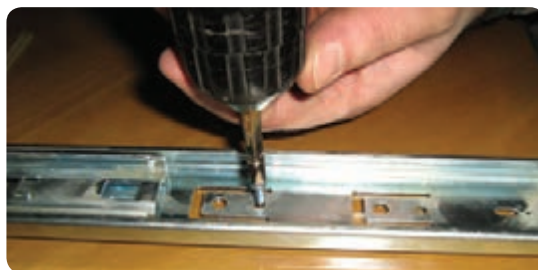
شکل ۷-۳۴ پیچ کردن ریل به بدنه فایل
