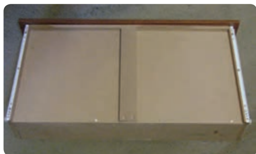
شکل ۶-۱۱۳ نصب قید کمرکش در کشوهای بزرگ
