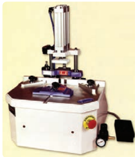
شکل ۱۰۶-۲ ماشین دم چلچله‌زن نیوماتیکی
