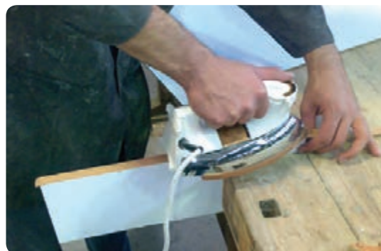
شکل ۸۱- لبه چسبانی روکش مصنوعی با اتو
