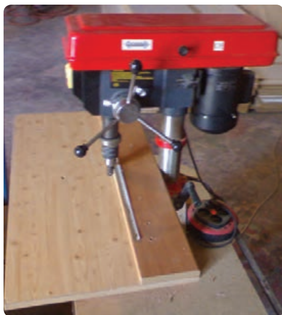
شکل ۶-۷۰- دریل ستونی همراه با شابلون جهت سوراخ‌کاری
