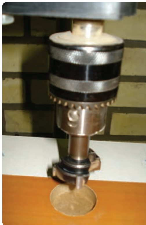
شکل ۶-۷۱ متنه کابینت جهت سوراخ کردن جای لولا
