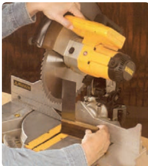
شکل ۲-۷ تنظیم عمود بودن تیغه پشت به صفحه
