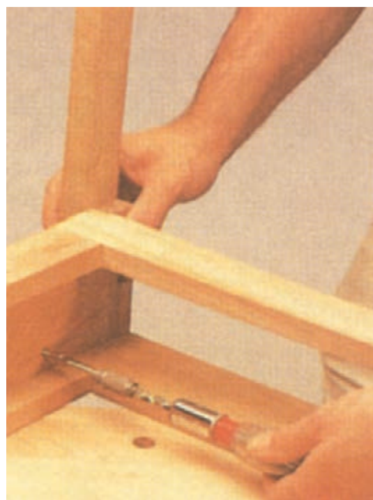
شکل ۱۵۹-۶ اتصال قاب دراور به قاب کناری
