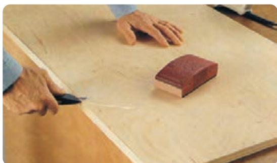
شکل ۸-۷۷ پرداخت لبه های اضافی روکش لبه چسبان
