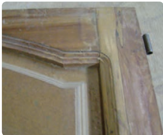
شکل ۶-۸۹ ابزار زدن قاب و تنکه
