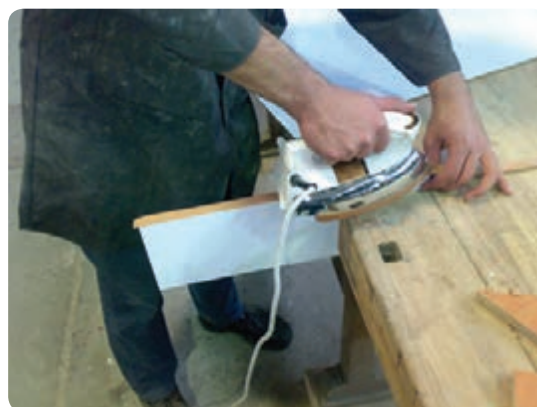
شکل ۱۴۷-۲ اتوکشی نوار روکش لبه‌چسبان
