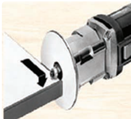
شکل ۱۵۵-۲ پرداخت لبه‌های اضافی روکش مصنوعی
