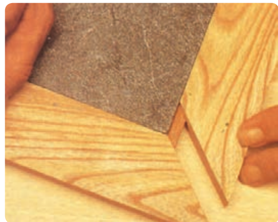
شکل ۶-۱۵۲ مونتاژ صفحه‌ میز
