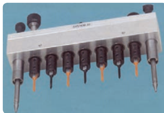
شکل ۲-۱۲۷ مجموعه مت‌ها جهت سوراخ کاری عمودی
