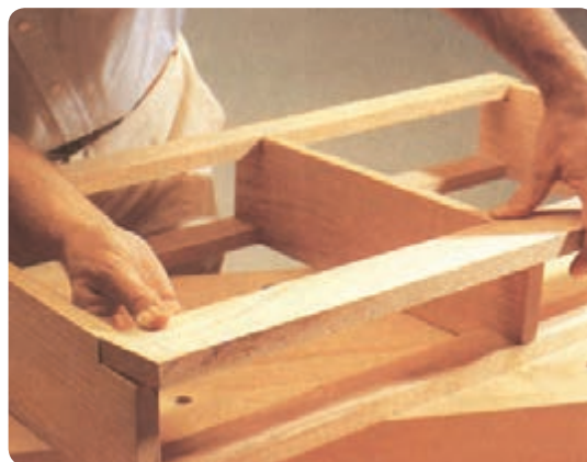
شکل ۶-۱۵۵ مونتاژ کلاف قاب دراور
