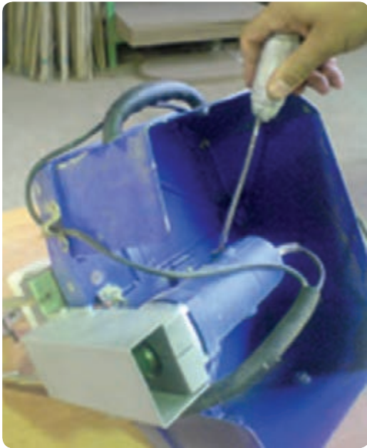
شکل ۲-۱۱۷ تصویر از زیر دستگاه گرفته شده است که در پوش پیچی زغال کلکتور جهت بازدید باز می شود
