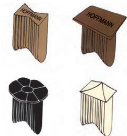
شکل ۱۱۰-۲ بین‌های اتصال دم چلچله
