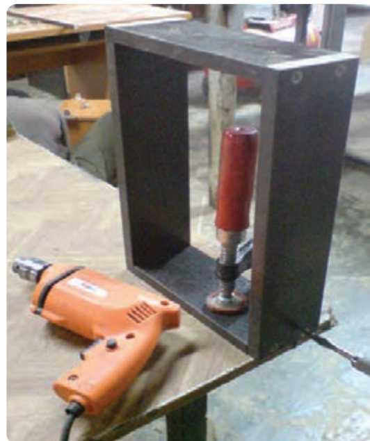
شکل ۱۰۸-۶ مونتاژ دستی جعبه کشو
