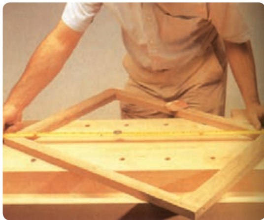
شکل ۱۵۰-۶ اطمینان از گونیی قاب
