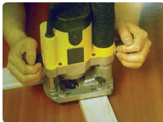
شکل ۵۹-۲ فرز کاری داخل قاب
