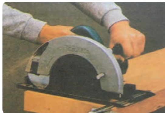
شکل ۳۶-۲ برش به وسیله گونیای دستگاه
