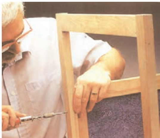
شکل ۱۶۰-۶ مونتاژ قاب پشت با قاب کناری
