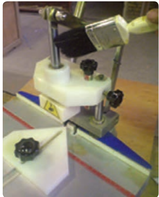
شکل ۲-۱۱۶ تمیز کردن مفصل های حرکتی ماشین دم چلچله زن
