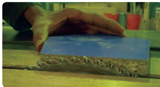
شکل ۳-۳۸ تنظیم ارتفاع تیغه اره
