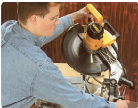
شکل ۲-۹ تنظیم زاویه چرخش اره گرد
