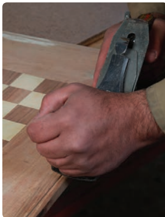
شکل ۶-۷۹ رنده کردن زهوار چوبی
