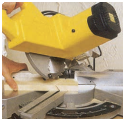
شکل ۱۴-۲ برش تحت زاویه
