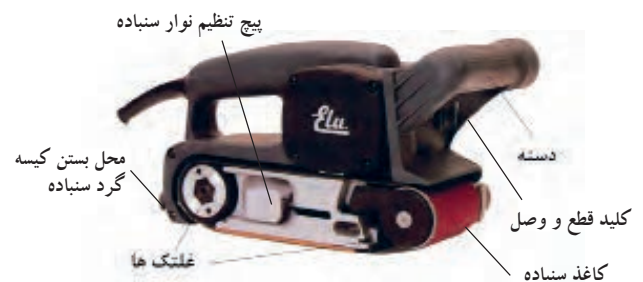
شکل ۷-۵- اجزای مهم و کاربردی دستگاه سنباده نواری.
