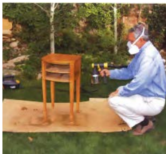
شکل ۴-۲۳. رنگ‌کاری با پیستوله (رنگ پوششی).
