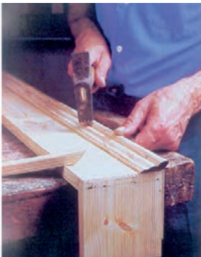
شکل ۱۳-۱۰. نصب زهوار با میخ.
