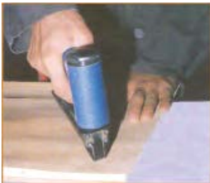
شکل ۵-۳۳. کار با دستگاه منگنه
