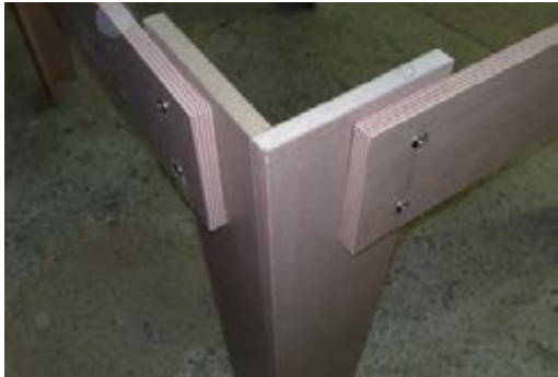
شکل ۱۲-۱۶- اتصال پایه به قید توسط پیچ فیکس.
