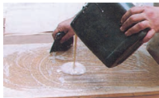
شکل ۴-۶. پفش کردن چسب به وسیله‌ی شانه‌ی چسب‌زنی.
