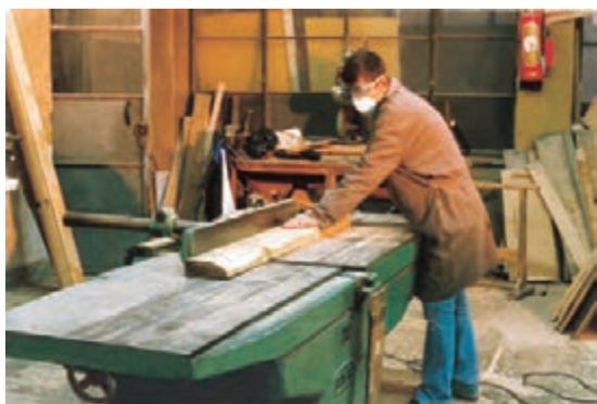
شکل ۹-۹- مقدار باز بودن زیاد گونیا، فطرآفرین است.
