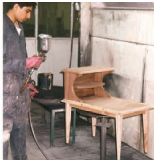
شکل ۴-۲۴. رنگ‌کاری با پیستوله (رنگ شفاف).
