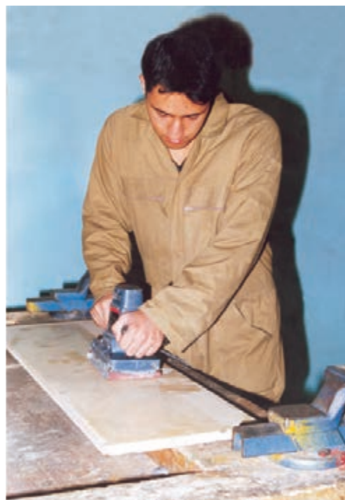
شکل ۷-۱۰. پیچونگی کنترل دستگاه سنباده لرزان.
