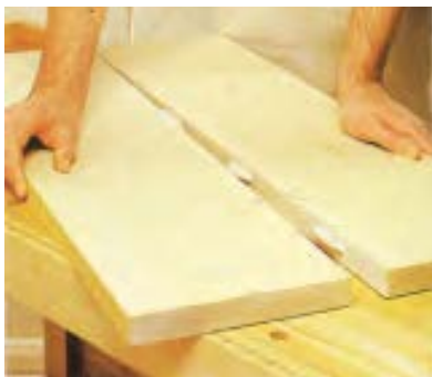
شکل ۹-۹۴- صفحه‌ی رویه، با اتصال بیسکویتی.
