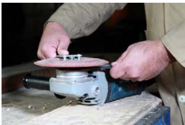
شکل ۷-۲۰- بستن ورق سنباده روی دیسک لاستیکی و ممکن کردن آن با مهره‌ی مخصوص.
