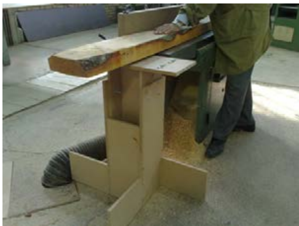
شکل ۹-۱۴- کاربرد میز کمکی برای ماشین کفرند.
