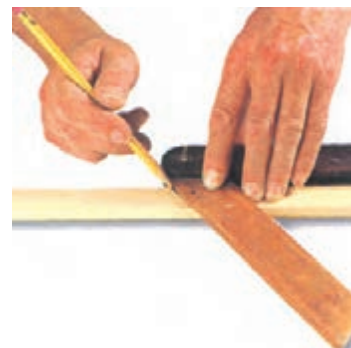
شکل ۱۰-۱۰. فطاکشی زهوار، با زاویه‌ی ۴۵ درجه.
