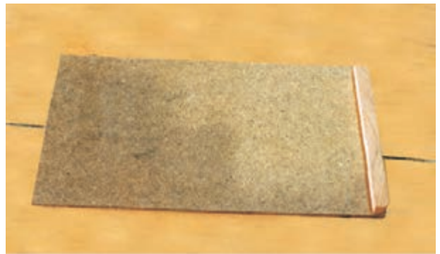
شکل ۹-۶۲- پسباندن زهوار به لبه‌ی کف جعبه.
