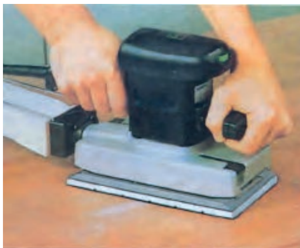
شکل ۳-۱۴- سنباده‌زنی با یک دستگاه سنباده لرزان کامل.
