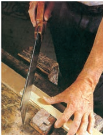
شکل ۱۱-۱۰. برش زهوار، با زاویه‌ی ۴۵ درجه.
