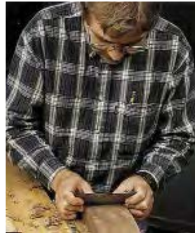
شکل ۲-۳۰. پرداخت سطوح قوس دار به وسیله لیسه.
