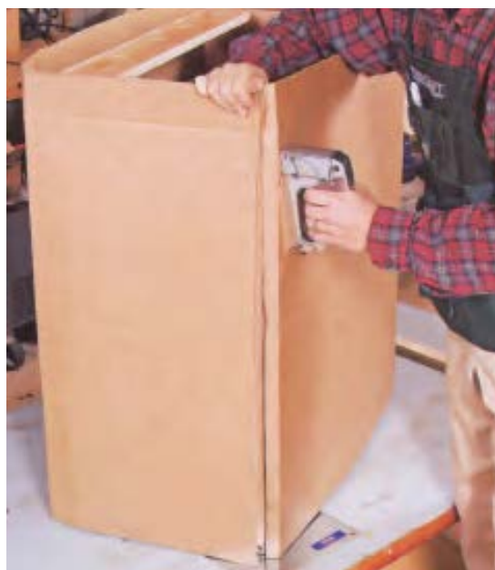
شکل ۸-۲۲- کاربرد منگنه‌ی دستی در بسته‌بندی کالاها.
