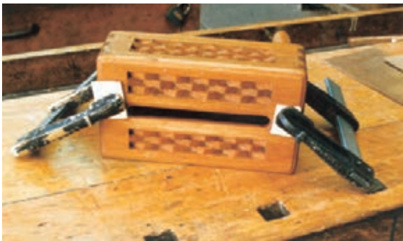
شکل ۹-۷۰- بستن سقف به بدنه‌ها.
