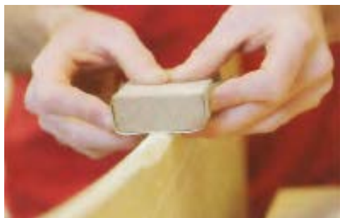
شکل ۳-۲۱. طریقه‌ی سنباده‌کاری نر قطعات با دو دست.
