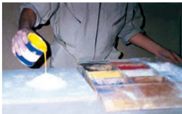
شکل ۴-۳- مواد تشکیل دهنده‌ی بتونه (روغنی).
