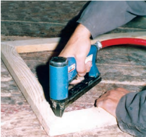
شکل ۱۶-۸. منگنه (زن روی درزهای ۴۵ درجه شده.
