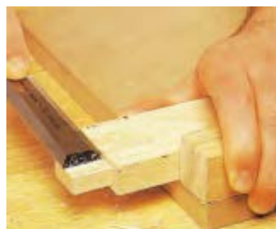
شکل ۹۸- اندازه کردن زبانه با مغار.
