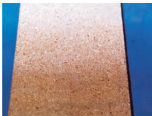
شکل ۴-۲- سطوح تخته فرده چوب، به دلیل خلل و فرج بسیار و شکل ظاهری بد، باید به صورت سرتاسری بتونه شود.
