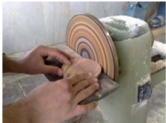
شکل ۱۹۱-۱۲. پرداخت قطعه چوب دایره شکل.
