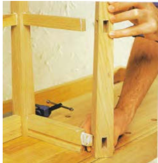
شکل ۹-۱۰۲- مونتاژ کار.
