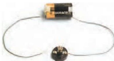
الف) مدار باز بدون کلید (شکل واقعی)
