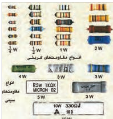
شکل ۶-۱۷- استانداردهای توان در مقاومت‌ها
