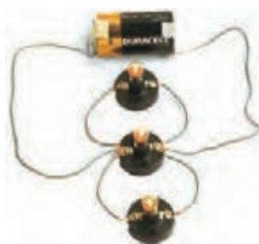
شکل ۵-۵۳ اتصال سه لامپ به صورت موازی
