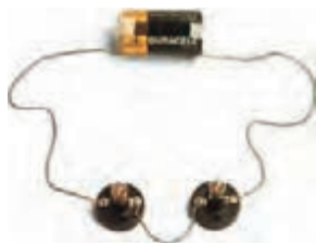
شکل ۵-۳- مدار واقعی دو لامپ به صورت سری
