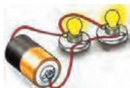
شکل ۵-۶۳- اتصال دو لامپ به صورت موازی
