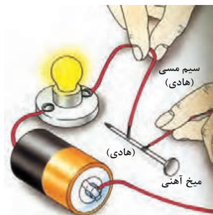
شکل ۲-۳- برقراری جریان الکتریکی در هادی‌ها
