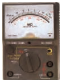
شکل ۵-۲۶ - یک نمونه اهم متر آزمایشگاهی
