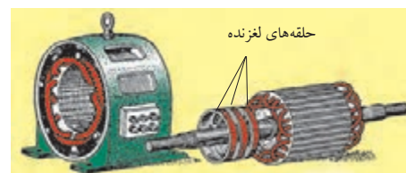
شکل ۴۶- اجزای موتور روتور سیم پیچی
