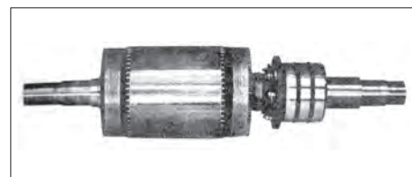
شکل ۱۵ - شکل واقعی روتور سیم پیچی شده
