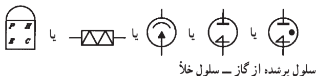
شکل ۲-۲۵- انواع علائم نشان دهنده ی فتوسل
