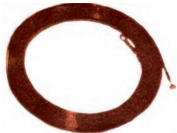
شکل ۳-۶- فنر سیم کشی
