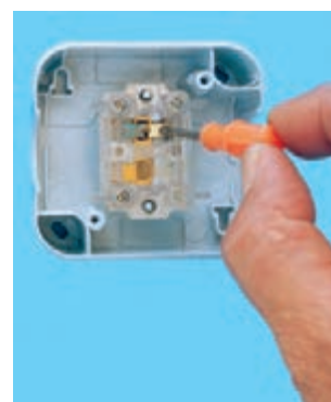
ج - برقراری اتصال پلاتین با کنتاکت غیرمشترک ۱
