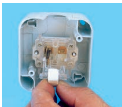
ب - شستی و فنر کلید تبدیل
