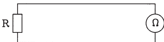
شکل ۵-۵۴- مدار اتصال اهم متر به مقاومت
