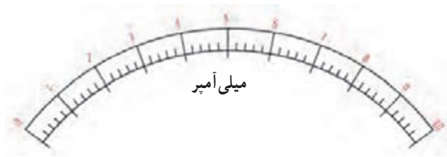
شکل ۵-۷ — درجه بندی میلی آمپر متر
