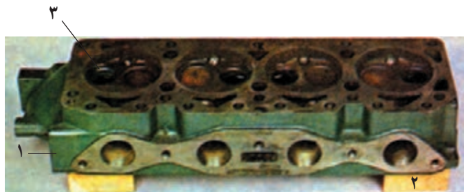
۱- سرسیلندر ۲- قطعه چوب ۳- نشیمنگاه شکل ۱۵-۸
