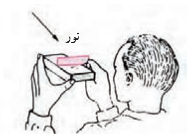
شکل ۱-۲۳- کنترل زاویه قائمه با گونیا
