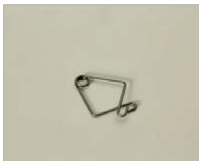
شکل ۳-۱۲۸ - سنجاق آویز بار (تا یک کیلوگرم)
