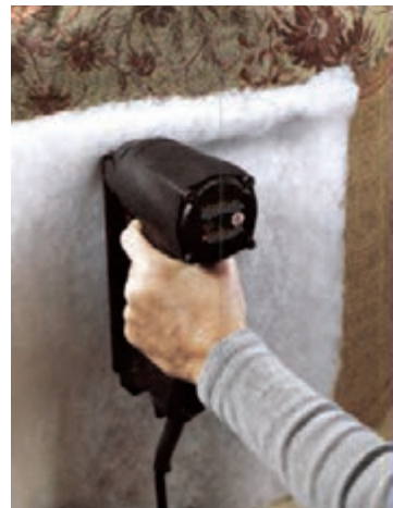
شکل ۴-۶۶- کوبیدن اسفنج بدنه
