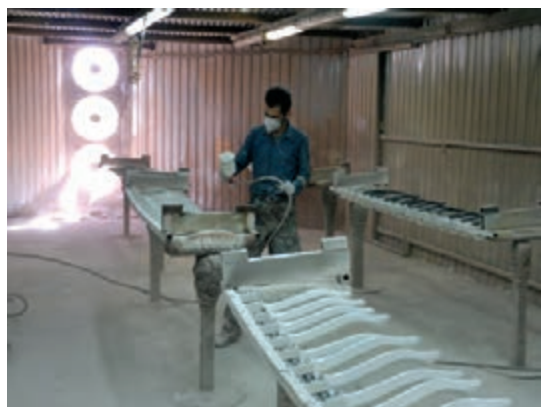
شکل ۳۶-۵ پاشیدن بتونه یا رنگ با پیستوله
