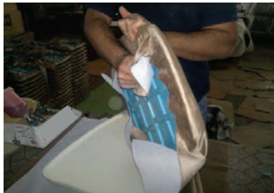
شکل ۵-۵۱ کشیدن و تنظیم پارچه
