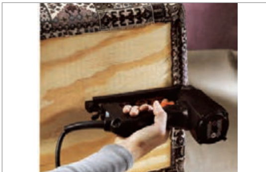
شکل ۴-۴۰- نصب پارچه در زیر صندوقچه
