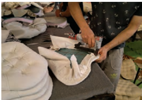
شکل ۵-۵۴ - منگنه زنی لبه‌های قطعه لمسه کاری شده
