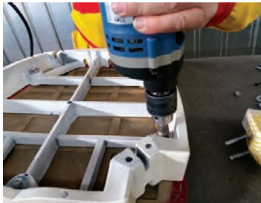
شکل ۵-۷۳- بستن شبکه زیر صندلی به کف
