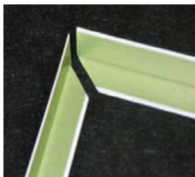
شکل ۱۰۹-۳ فارسی بر شدن نبشی تراز
