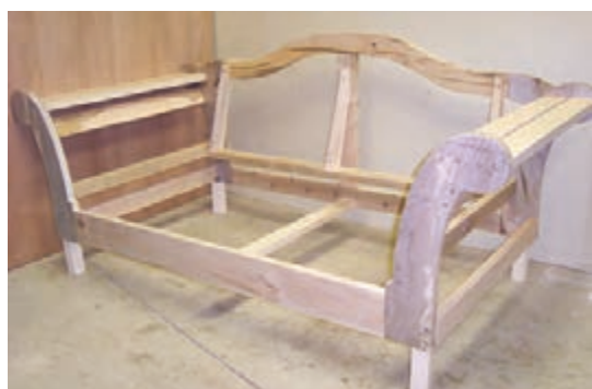
شکل ۴-۴ - تصویری از یک کلاف چوبی مبل پارچه‌ای
