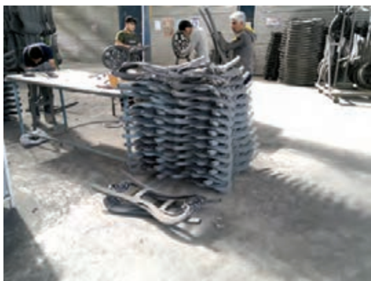
شکل ۵-۳۲ پرداخت کاری قطعات و چیدمان آنها
