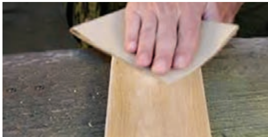
شکل ۴-۲۰- پرداخت با سنباده
