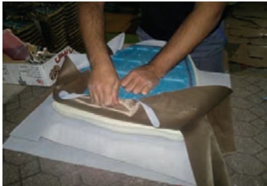
شکل ۵-۵۰ ثابت کردن پارچه از یک طرف
