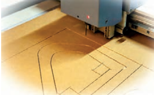
شکل ۵-۵۸- برش مقوا برای ساخت کارتن با سی‌ان‌سی
