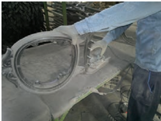
شکل ۵-۳۰ پرداخت با سنباده لرزان
