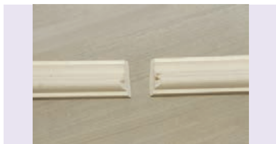
شکل ۲۲۸- ۱- برش فارسی بر قطعات کنج
