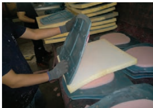
شکل ۵-۴۷- قراردادن کفی روی اسفنج بزرگ‌تر
