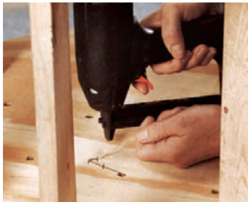
شکل ۴-۶۰- ثابت کردن نخ لمسه از پشت تخته
