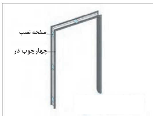
شکل ۱-۱۰۹- محل قرارگیری صفحات نصب در چهارچوب‌های فلزی شکل ۱-۱۱۰- مقدار B در حدود ۱/۵ سانتی‌متر می‌باشد
