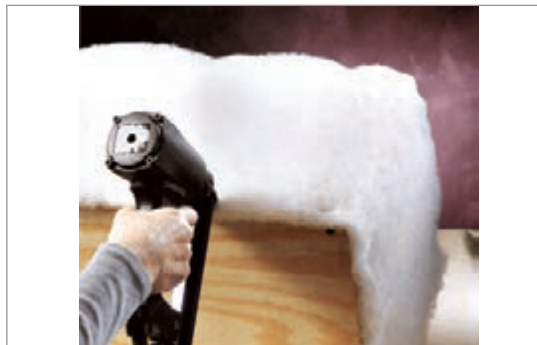
شکل ۴-۳۹- نصب اسفنج به بدنه صندوقچه
