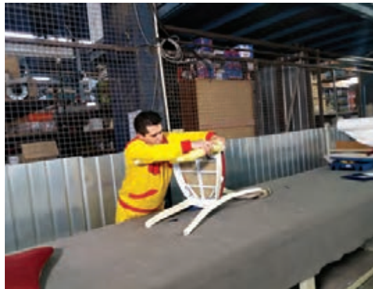
شکل ۷۷-۵- جا زدن و تنظیم پایه جلو
