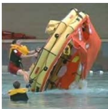
شکل ۴-۱۴ برگرداندن قایق بادی واژگون شده در آب
