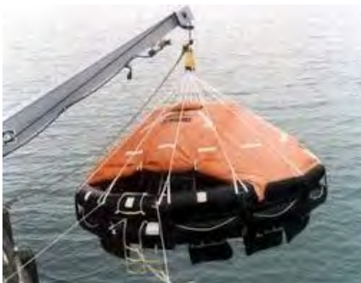
شکل ۴-۱۵ به آب‌اندازی با جرثقیل
