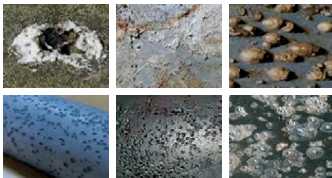
شکل ۸-۱- خوردگی آلومینیوم (ردیف بالا) و پس از زنگ زدایی (ردیف پایین)
