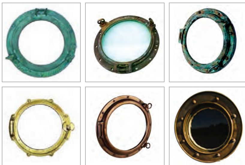
شکل ۹-۱- خوردگی برنج (ردیف بالا) و پس از زنگ‌زدایی (ردیف پایین)
