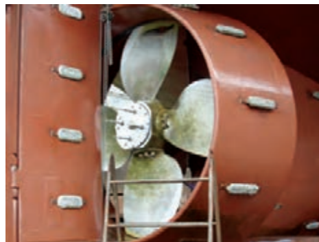
شکل ۱-۴- حفاظت قطبی از پروانه و مخزن آب توازن با استفاده از روی به عنوان فلز فداشونده
