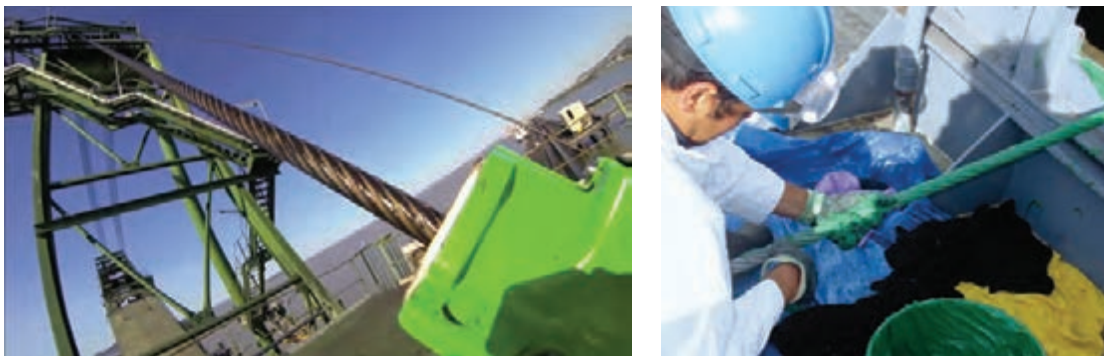
شکل ۱-۲۴- روان کاری طناب سیمی با گریس
