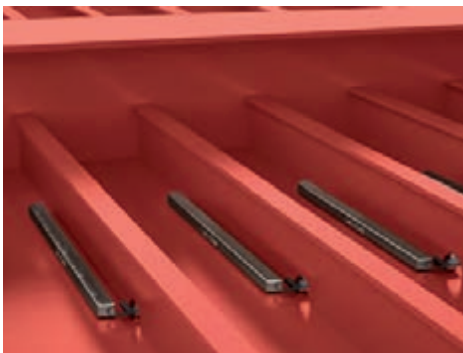
شکل ۱-۴- حفاظت قطبی از پروانه و مخزن آب توازن با استفاده از روی به عنوان فلز فداشونده
