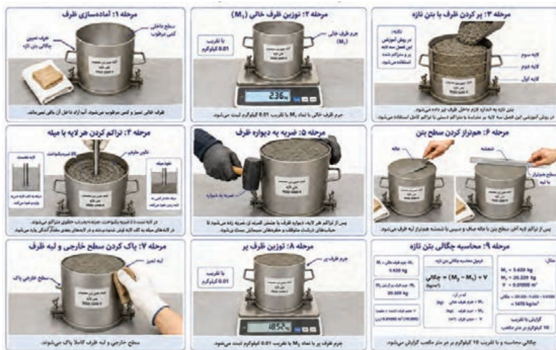
شکل ۴۱ - آزمایش تعیین وزن مخصوص بتن تازه
