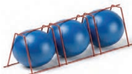
گوی‌های کروی (Eco-Line) برای سقف‌های به ضخامت ۳۵۰ تا ۶۰۰ میلی‌متر
