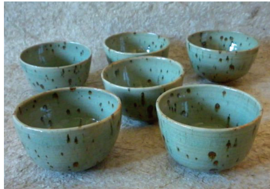
شکل ۵۶- اثر افزودن ۴ درصد بنتونیت در ترکیب لعاب
