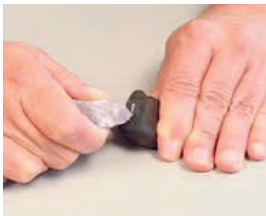
شکل ۱۹- روش‌های دستی و دستگاهی تعیین سختی
