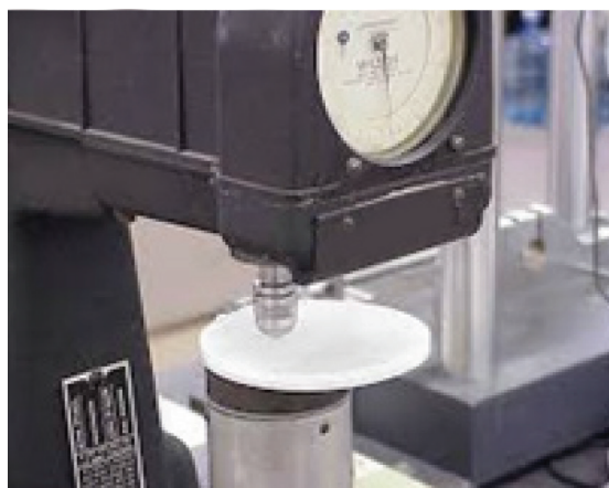
شکل ۱۹- روش‌های دستی و دستگاهی تعیین سختی
