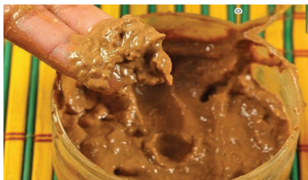
شکل ۵۵- بنتونیت آب جذب کرده و متورم شده
