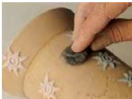
شکل ۱۲- پرداخت بدنه پس از قرار دادن طرح
