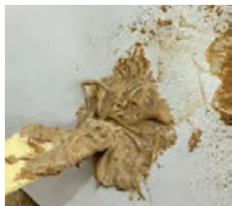
شکل ۳۸- مخلوط کردن چسب چوب و پودر بدنه
