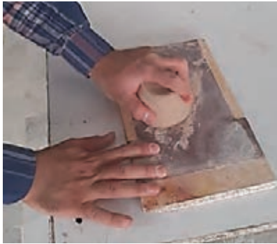
شکل ۱۳- یکدست کردن لبه کاسه با تخته سنباده
