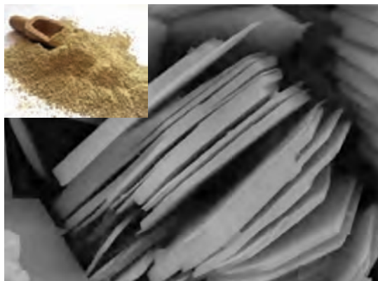
شکل ۱۵- تصویر میکروسکوپی ذرات رس
