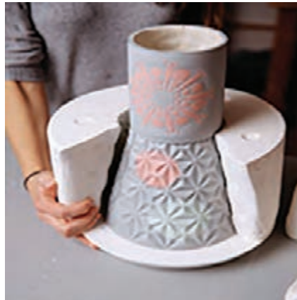
شکل ۲۶- بدنه های تزئین شده به روش افزودن دوغاب رنگی در قالب
