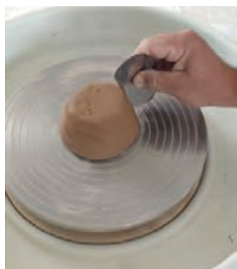
شکل ۹- پرداخت سطح بیرونی کاسه با لیسه فلزی
