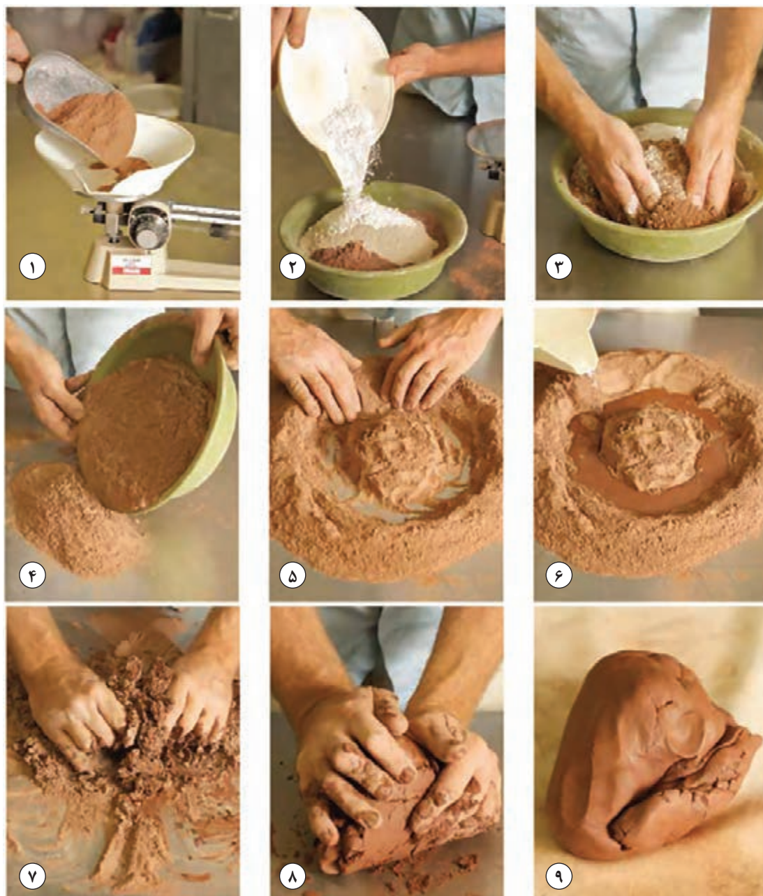
شکل ۳۰- فرایند تولید گِل به روش دستی
