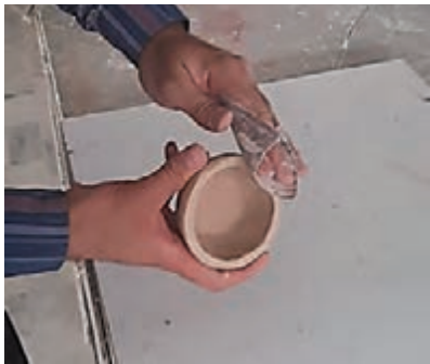
شکل ۱۴- صاف و صیقلی کردن سطوح داخلی و خارجی
