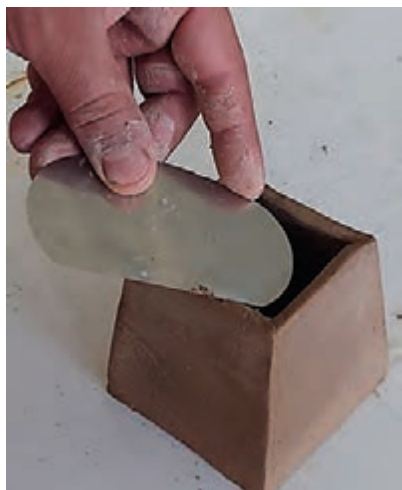
شکل ۲۳- پرداخت لبه نمونه با لیسسه
