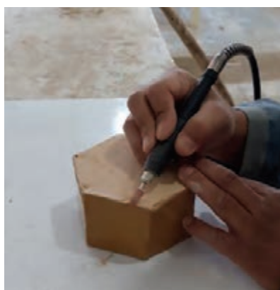
شکل ۳۱- برطرف کردن ناهمواری‌های جزئی در انتهای قطعه
