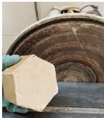
شکل ۳۲- صاف و صیقلی کردن انتهای نمونه با صفحه سنباده دیسکی گردان عمودی
