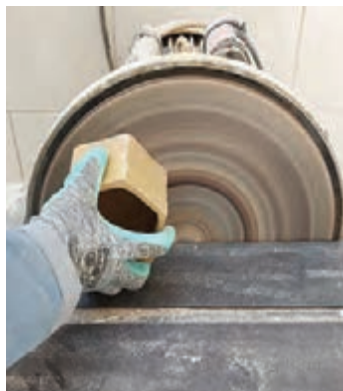
شکل ۳۲- صاف و صیقلی کردن انتهای نمونه با صفحه سنباده دیسکی گردان عمودی
