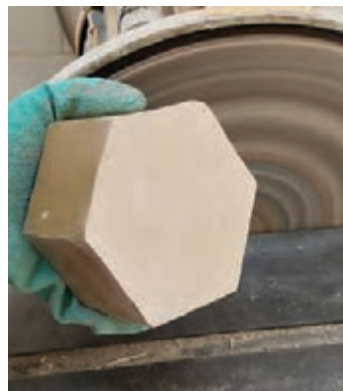
شکل ۳۲- صاف و صیقلی کردن انتهای نمونه با صفحه سنباده دیسکی گردان عمودی
