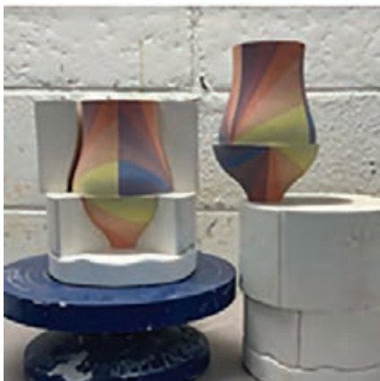
شکل ۲۶- بدنه های تزئین شده به روش افزودن دوغاب رنگی در قالب
