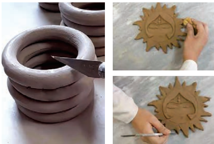
شکل ۸- پرداخت محصولات سرامیکی با ابزارهای مختلف
