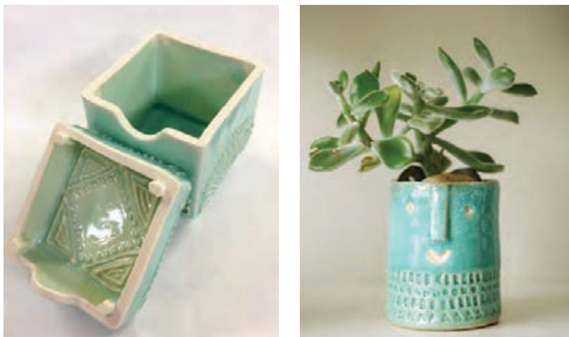
شکل ۲۹- بدنه‌های شکل‌دهی شده با روش ورقه‌ای
