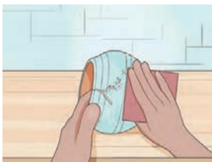
شکل ۴۷- سنباده‌زنی و پرداخت سطح ترمیم شده
