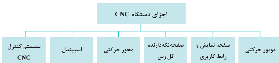
نمودار ۶- اجزای دستگاه CNC
