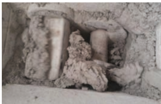
شکل ۳۳- مخلوط سازی گل در دستگاه اکسترودر
