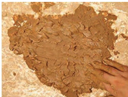
شکل ۳۰- تهیه دوغاب از خاک رس و آب‌گیری آن توسط لوح گچی
