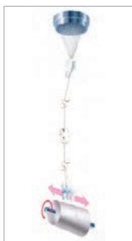
شکل ۲- قطعات سرامیکی مورد استفاده در تاباندن نخ
