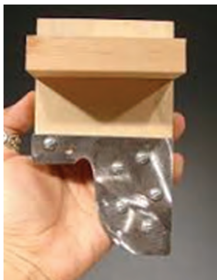
شکل ۲۱- شابلون تقویت شده با چوب
