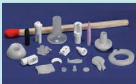
شکل ۱۲- میکرو سازه‌های سرامیکی تولید شده به روش قالب‌گیری تزریقی
