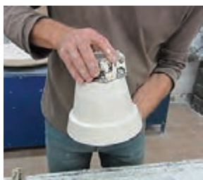
شکل ۳۱- مادر قالب از جنس گچ و فلز
