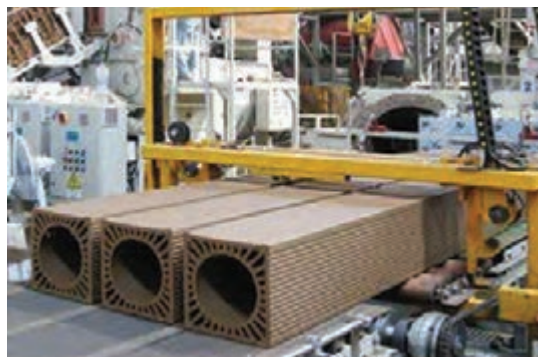
شکل ۱۰- قالب نصب‌شده در دستگاه اکسترودر صنعتی و محصول خروجی
