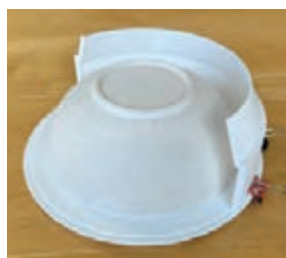
شکل ۳۰- مادر قالب از جنس گچ و پلیمر
