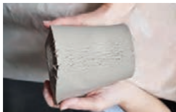
ج) لایه لایه شدن و ترک مقطع طولی
