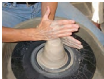
۸- دست راست را روی مخروط قرار دهید و با دست چپ، آن را قفل کنید.
