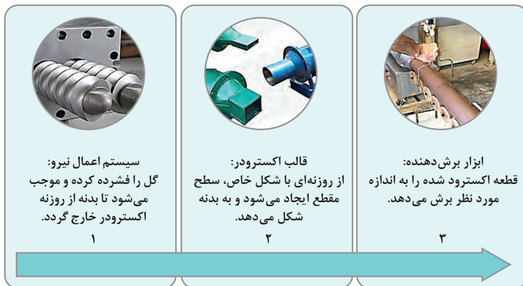
شکل ۳- اجزای دستگاه اکسترودر
