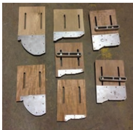
شکل ۲۰- شابلون مورد استفاده در جیگر و جولی
