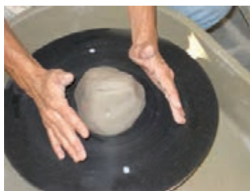
۲- با ضربه دست، گِل را در مرکز سرچرخ قرار دهید.
