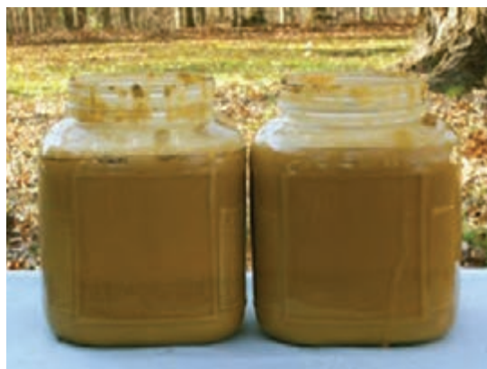
شکل ۳۰- تهیه دوغاب از خاک رس و آب‌گیری آن توسط لوح گچی
