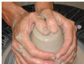
۷- با فشار شست، بالای مخروط را تراز کنید.
