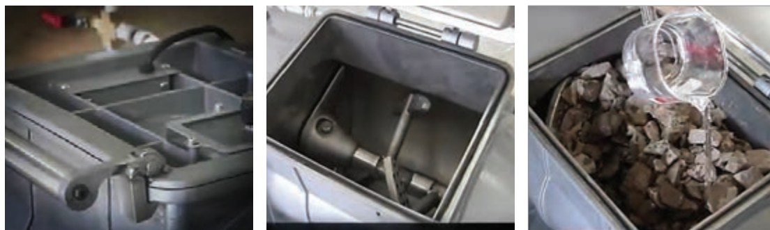
شکل ۶- ورود کلوخه های رسی خشک به داخل محفظه و افزودن آب به مقدار لازم
