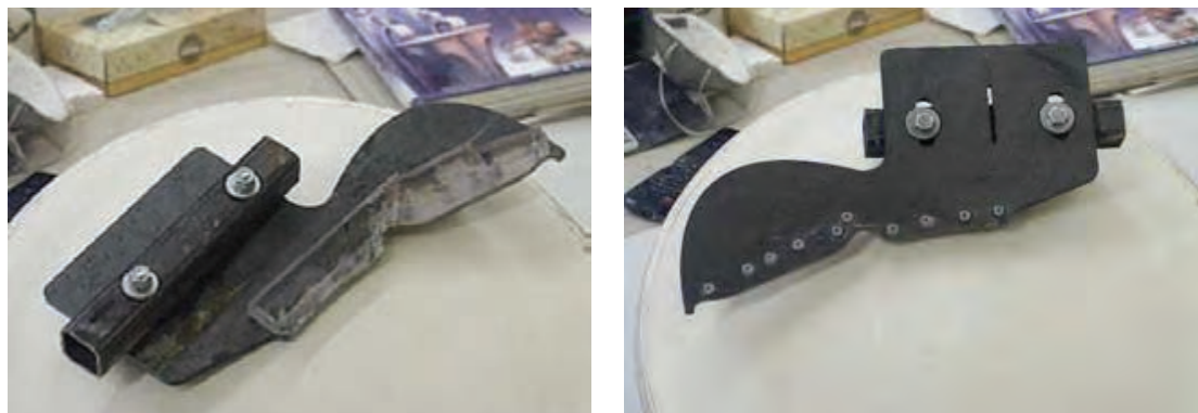
شکل ۲۳- شابلون با پیچ و مهره قابل تنظیم
