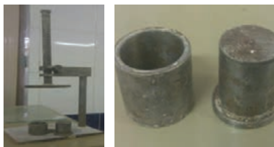
شکل ۱۸- نمونه‌ساز دستگاه ففرکورن و گل خارج شده از نمونه‌ساز
