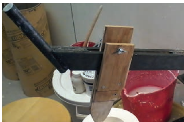
شکل ۲۲- شابلون چوبی و پلاستیکی تقویت شده با چوب
