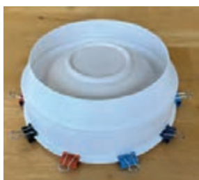
شکل ۳۰- مادر قالب از جنس گچ و پلیمر
