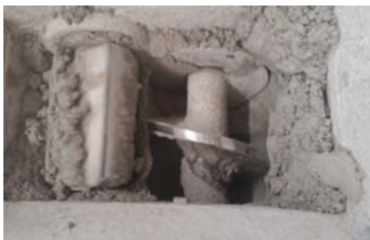
شکل ۳۳- مخلوط سازی گل در دستگاه اکسترودر
