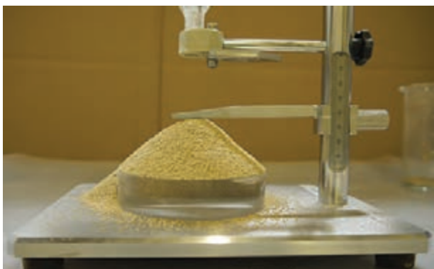
شکل ۵۱- نحوه عملکرد دستگاه تعیین زاویه خواب برای تعیین جریان یابی گرانول
