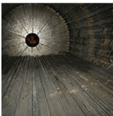
شکل ۱۸- نمای داخلی آسیاب میله‌ای
