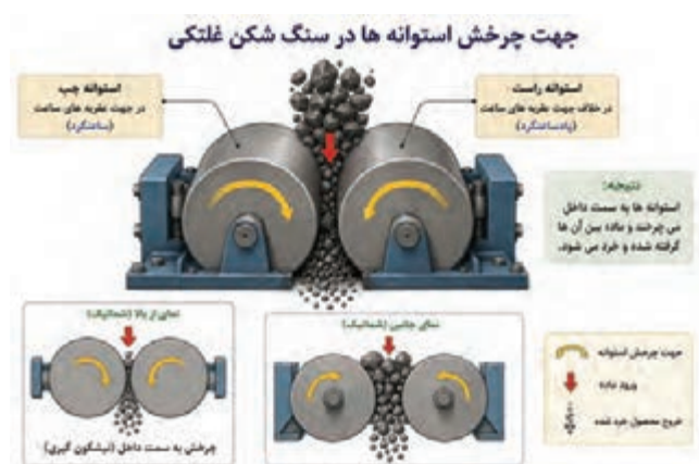
شکل ۳۵- جهت چرخش استوانه‌ها در سنگ شکن غلتکی
