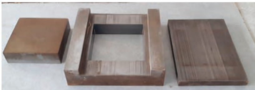
شکل ۱۳- اجزای قالب فولادی
