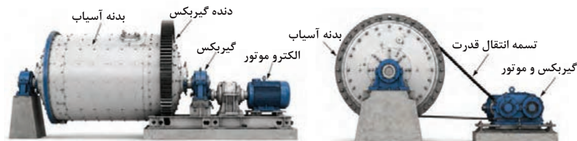
شکل ۱۱- بالمیل ناپیوسته
