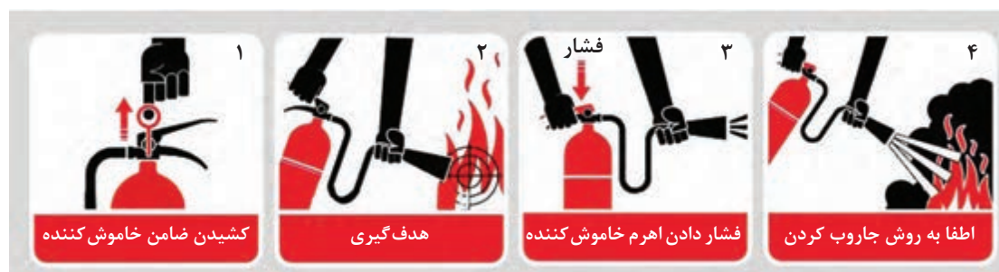
شکل ۱۲- مراحل استفاده از کپسول آتش‌نشانی
