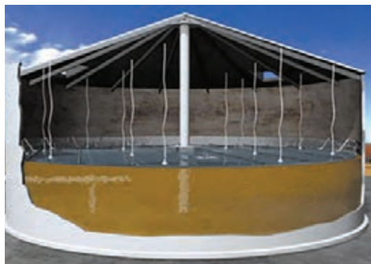
شکل ۱۹- مخازن سقف شناور درونی
