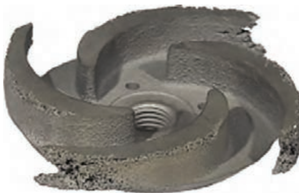
شکل ۲۲- آسیب دیدگی پروانه پمپ در اثر پدیده کاویتاسیون
