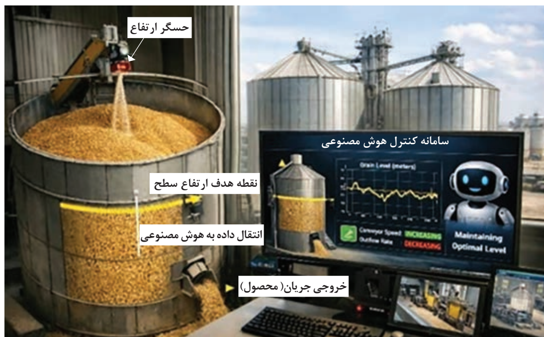
شکل ۲۴- کنترل ارتفاع سطح سیلوی گندم با هوش مصنوعی
