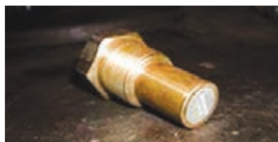
شکل ۲۷- مجرای ذوب شدنی روی شانه یک سیلندر گاز تحت فشار و یک مجرای ذوب شدنی مجزا قبل از نصب
