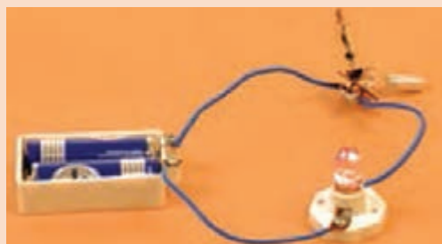
مدار ساخته شده با راه‌انداز (استارت) لامپ مهتابی به عنوان ترموستات (۲)
