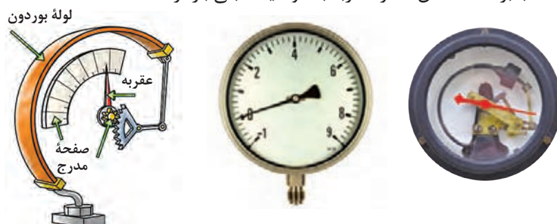
شکل ۱۵- نمای درونی و بیرونی فشارسنج بوردون از نوع C
