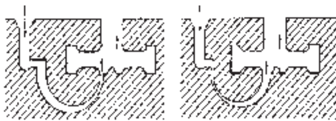
شکل ۱۳- دو نمونه از روش راهگاه‌گذاری از پایین (راهگاه شاخی)
