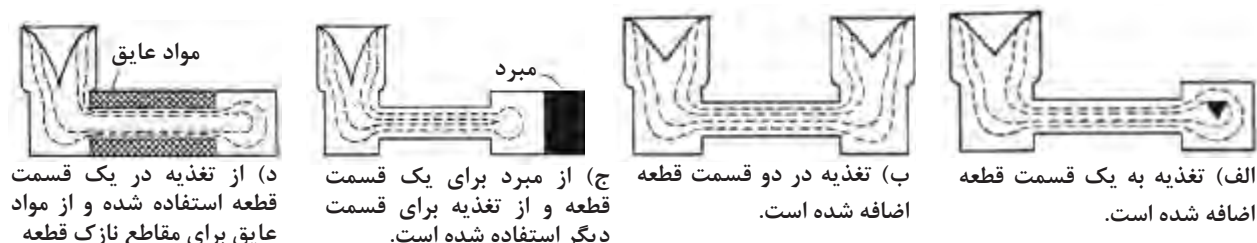
شکل ۲۱ - عمل تغذیه گذاری در یک قطعه با سطح مقطع غیر یکنواخت
