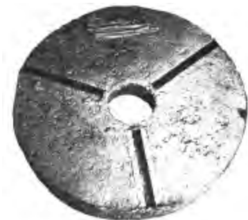
شکل ۶- نمونه از قطعه با عیوب آخال و مک‌های میکروسکوپی
