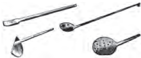
شکل ۱۴- کف گیر و سرباره گیر
