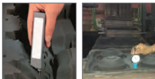
شکل ۱۸- نحوه اندازه‌گیری استحکام قالب با استحکام‌سنج عقربه‌ای و دیجیتالی
