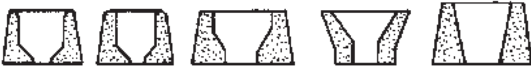
شکل ۲- نمونه هایی از حوضچه (قیف) های پیش ساخته بالای راهگاه بارریز
