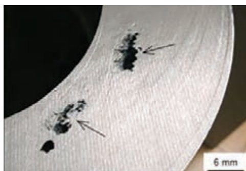
شکل ۱۲- تصویر از انقباض هنگام انجماد زیرساختار آلومینیوم
