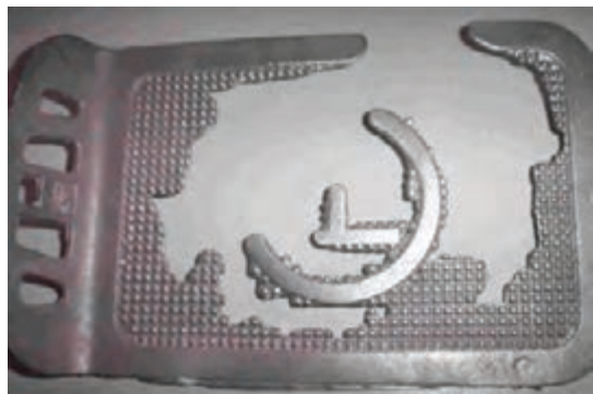
شکل ۱۴- در محل اتصال، به دلیل انجماد زودهنگام یا سرعت پایین ریخته‌گری، دو جریان فلز به درستی به هم متصل نمی‌شوند.
