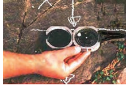
طریقه قرار دادن لبه کمپاس بر روی لایه برای به دست آوردن امتداد لایه
