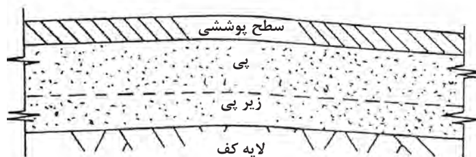
شکل ۵ - شکل لایه‌های یک جاده معدنی
