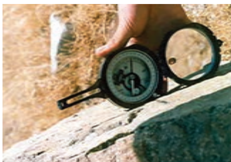
نحوه قرارگیری لبه کمپاس بر روی لایه برای تعیین مقدار شیب
