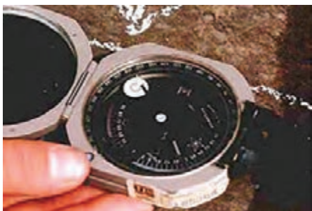
تماس لبه کمپاس با سطح لایه برای به دست آوردن امتداد
