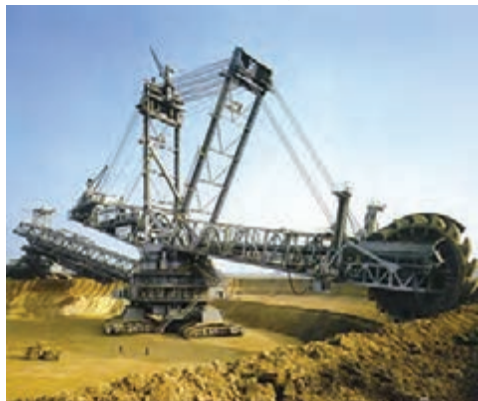
شکل ۵- اکسکواتور بیل چرخشی (Bucket Wheel Excavator)
