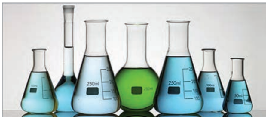
شکل ۱۷- انواع ظروف مُدرّج آزمایشگاهی جهت اندازه‌گیری حجم مایعات
