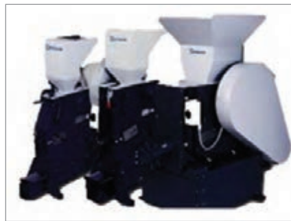
دستگاه‌های سنگ‌شکن فکی آزمایشگاهی با ظرفیت‌های مختلف
