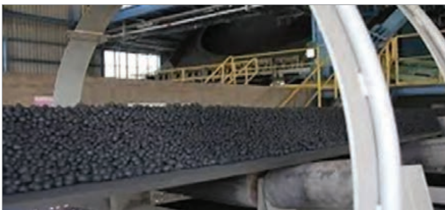
شکل ۲۰- حمل و نقل گندله سنگ آهن به وسیله نوار نقاله
