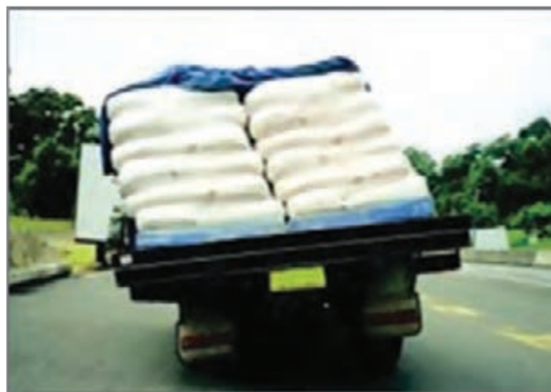
شکل ۱۱- عدم تعادل وسیله نقلیه به دلیل بارگیری نامناسب
