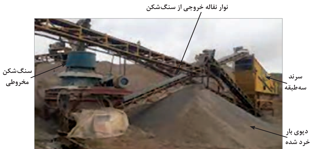
شکل ۳۱- مدار بسته سنگ‌شکن مخروطی
