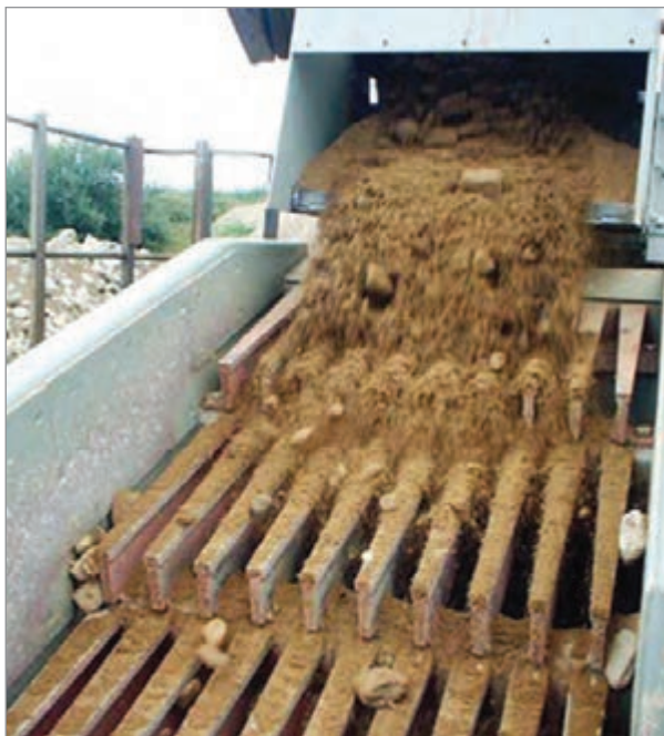
شکل ۱۲- فیدر (تغذیه‌کننده) و سرنده گریزلی سنگ‌شکن فکی
