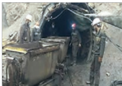
شکل ۳۱- واگن های بارگیری از طریق ریل راه آهن به وسیله کارگر و لوکوموتیو
