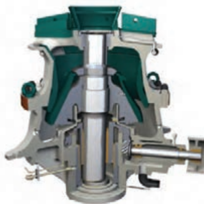
شکل ۱۵- ساختمان سنگ شکن مخروطی
