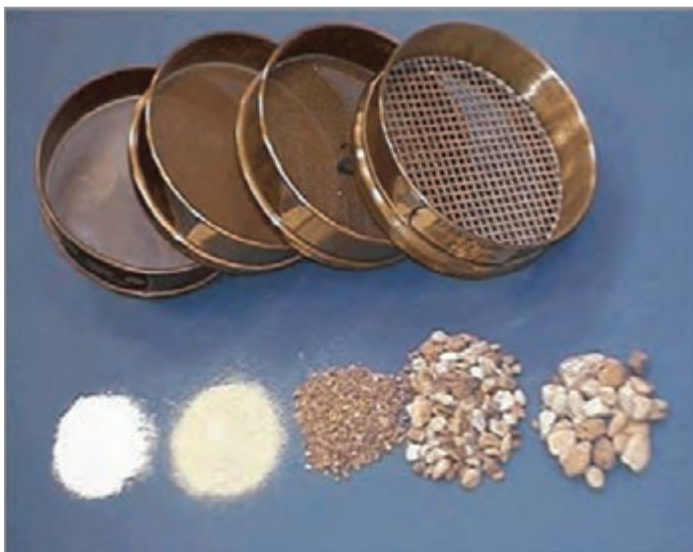
شکل ۱۴- سرندهای دستی استاندارد آزمایشگاهی
