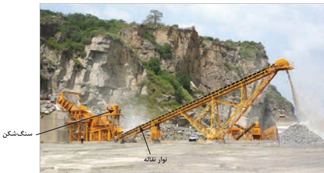
شکل ۳۰- عملیات خرد کردن سنگ شکن در مدار باز
