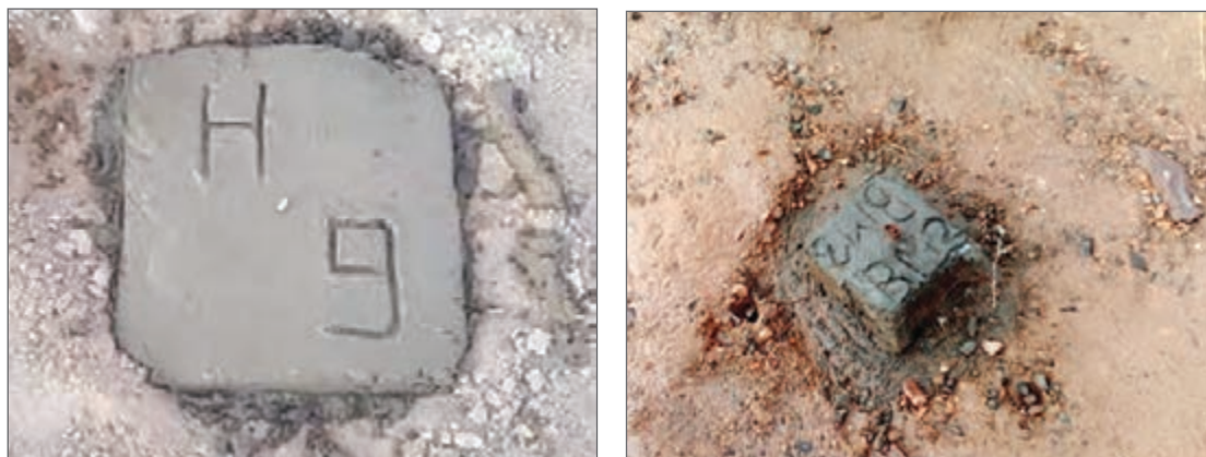
شکل ۱۰- ایستگاه‌های نقشه‌برداری تثبیت شده در زمین
