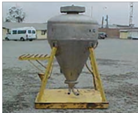
شکل ۱۴- خرج گذار پنوماتیکی آنفو نصب شده روی کامیون
