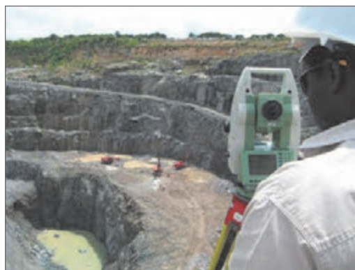
شکل ۲- قراول روی از روی نقطه بنچ مارک در بالای پله‌های معدن به نقطه‌ای با دید کافی در داخل محدوده
