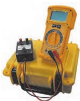
شکل ۴- دستگاه مولتی‌متر آتش کاری که می‌تواند اهم، آمپر و ولتاژ را در مدار اندازه‌گیری نماید.
