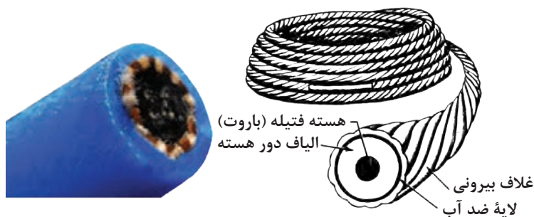
شکل ۳۰- فتیله اطمینان و اجزای آن
