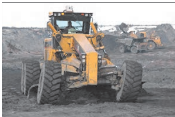
شکل ۱- گریدر در حال انجام عملیات تسطیح در معدن
