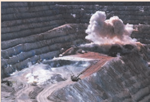
شکل ۴- عملیات چال زنی و آتش کاری در معدن
