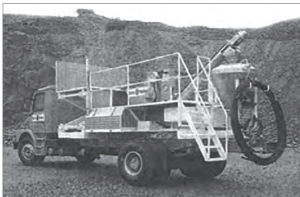
شکل ۱۴- خرج گذار پنوماتیکی آنفو نصب شده روی کامیون
