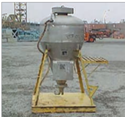
شکل ۱۳- خرج گذار پنوماتیکی آنفو
