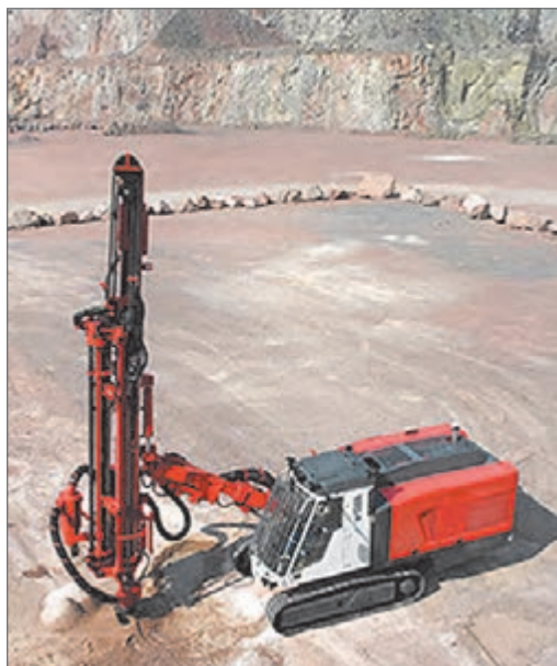
شکل ۵- شاخص گذاری محدوده شبکه حفاری به وسیله سنگ چین
