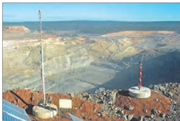
شکل ۳- ایستگاه بنچ مارک در بالای پله‌های یک معدن روباز
