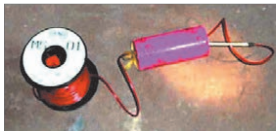
طریقه قرار دادن چاشنی درون دینامیت
