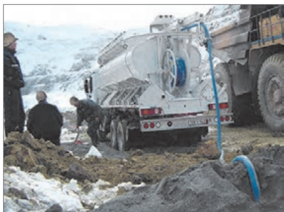
شکل ۲۳- تزریق مواد منفجره ژله ای به داخل چال های آبدار
