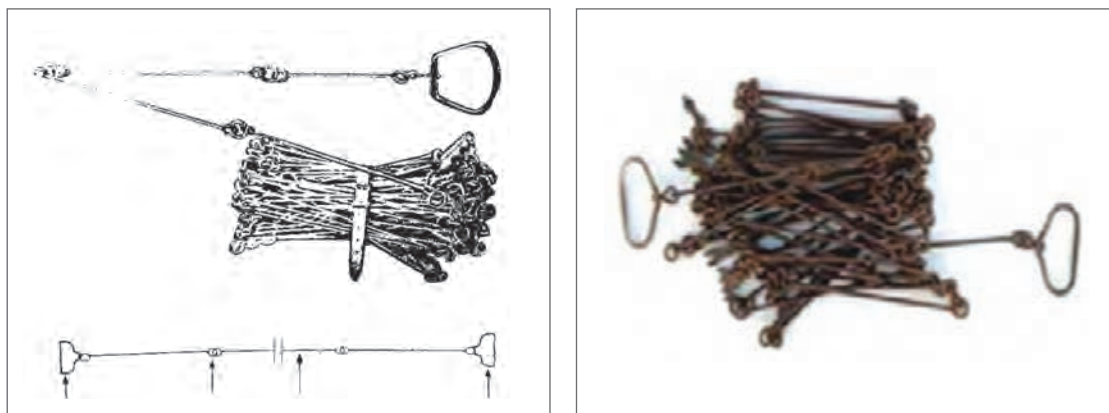
شکل ۲۳- زنجیر مساحی و ساختمان زنجیر مساحی
