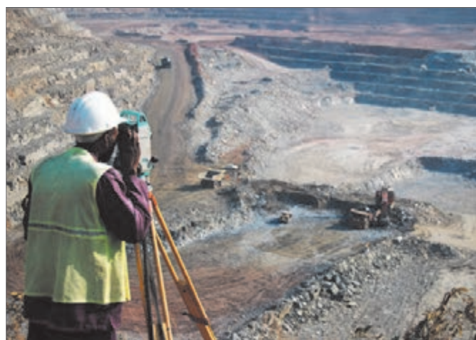
شکل ۴- خواندن رأس‌های محدوده با استفاده از دوربین و از روی یک نقطه با دید کامل به محدوده
