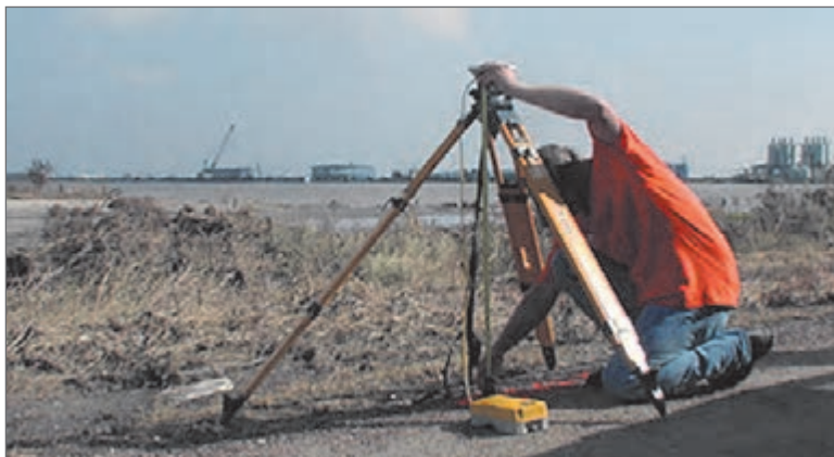
شکل ۵۵ - اندازه‌گیری ارتفاع دوربین تا سطح زمین
