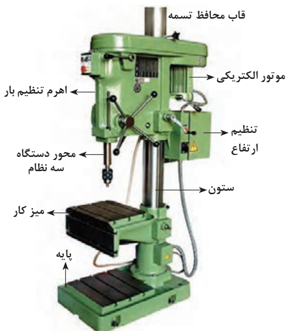
شکل ۶ - ماشین مته ستونی (دریل ستونی)
