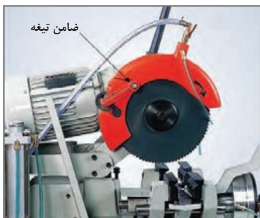
شکل ۱۸- ضامن و انواع آچار تعویض تیغه در اره آب صابونی
