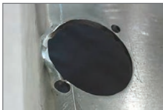
شکل ۵ - تابیدگی ورق بعد از برش
