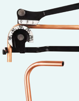
شکل ۲۲- خم کاری لوله مسی
