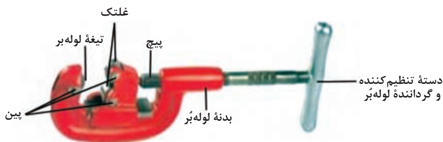
شکل ۸- اجزای لوله بر دستی
