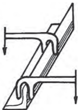
شکل ۳۷- تاب‌گیری پروفیل‌ها به کمک آچار F
