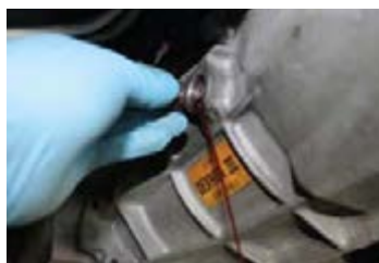
شکل ۹- بررسی و پر کردن روغن جعبه دنده
