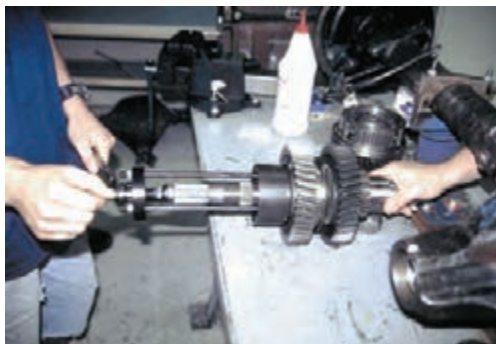
جدا کردن اجزای مجموعه جعبه‌دنده از روی محورها با کمک پرس و ابزار مخصوص
