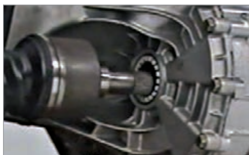
شکل ۲۱- بیرون کشیدن پلوس با ابزار مخصوص
