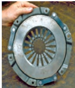
دیسک نیاز به ترمیم با سنباده
