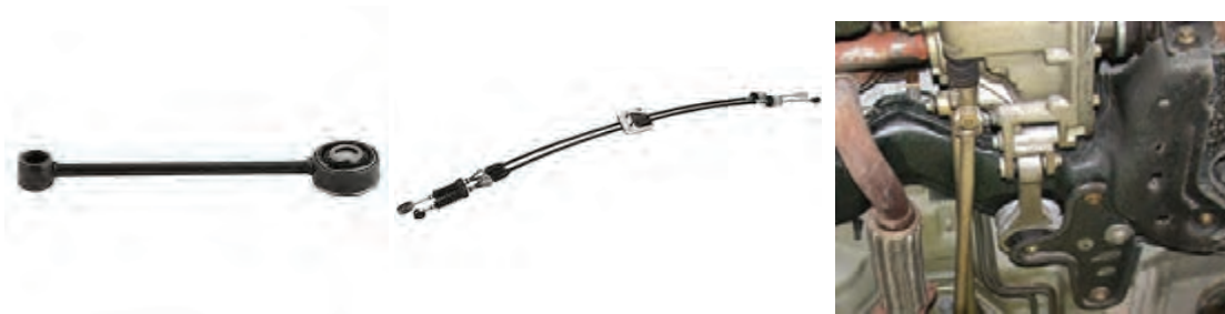
شکل ۴- برخی از اجزای مکانیزم تعویض دنده
