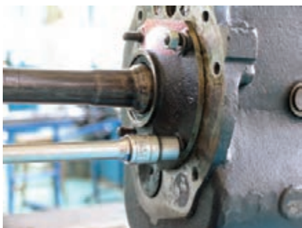
باز کردن محور ورودی
