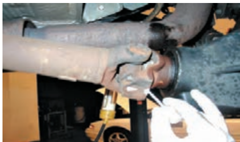
شکل ۱۳- نشانه گذاری گاردان پیش از باز کردن
