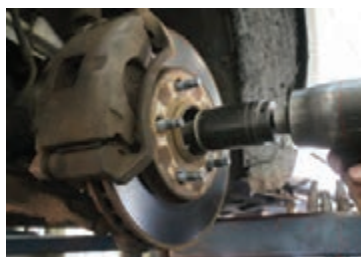
باز کردن اتصالات چرخ و پلوس
