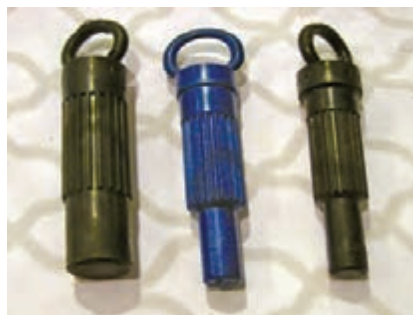
شکل ۲۷- نمونه‌های ابزار هم‌مرکزکننده صفحه کلاچ
