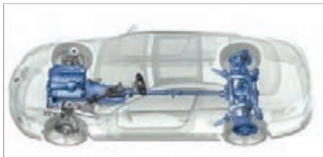
شکل ۲- انتقال توان به مجموعه «گرداننده پایانی» با میل گاردان
