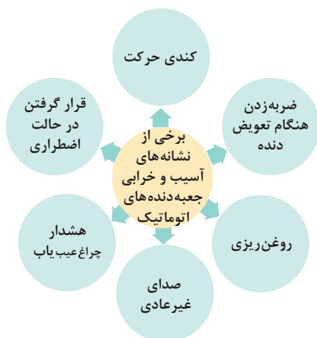
نمودار ۳- نشانه‌های خرابی جعبه دنده اتوماتیک
