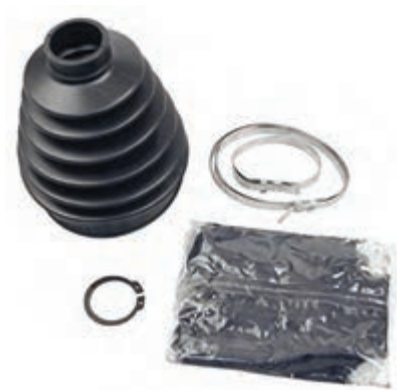
شکل ۱۷- گریس مخصوص و کافی همراه گردگیر تعویضی مفصل‌های سرعت ثابت
