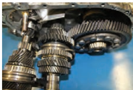
بررسی پینیون و چرخ دنده جعبه دنده
