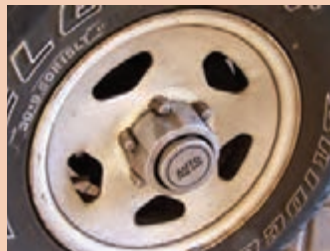
قفل روی چرخ (قفل پلوس) روی برخی خودروهای ۴WD
