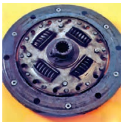
شکل ۲۲- نمونه صفحه کلاچ معیوب (سوختگی و سایش بیش از اندازه)
