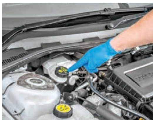
شکل ۷- مخزن مایع مشترک در یک خودرو
