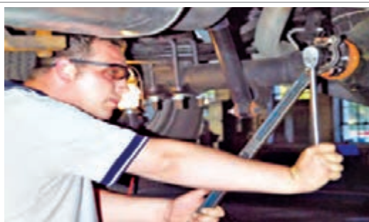
بررسی لنگی فلانچ و گشتاور سنجی مهره مرکزی دیفرانسیل
