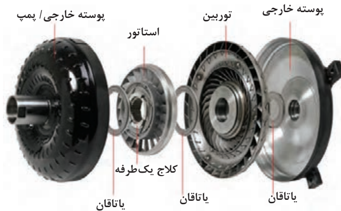
ادامه شکل ۸- نمونه واقعی مبدل گشتاور (تورک کنورتور) و روش کار آن
