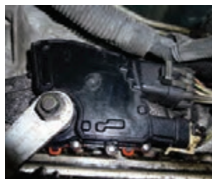
شکل ۱۵- تنظیم سلکتور تعویض دنده
