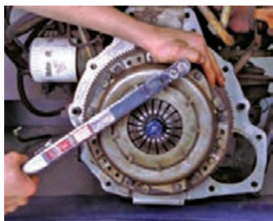
شکل ۳۰- بستن پیچ‌های دیسک کلاچ با گشتاور لازم
