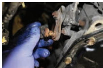
باز کردن اهرم‌بندی تعویض شده
