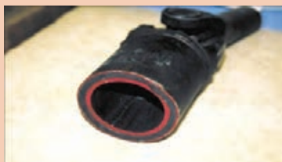
شکل مقطع گاردان دولایه با لایه لاستیک میانی
