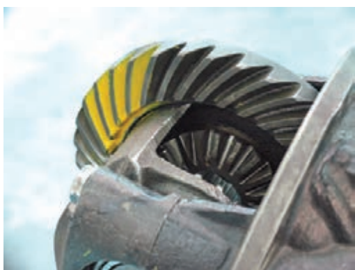
شکل ۴۰- کاربرد رنگ برای آزمایش
