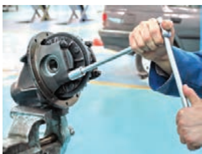
شکل ۶۴- بستن کپه یاتاقان‌ها
