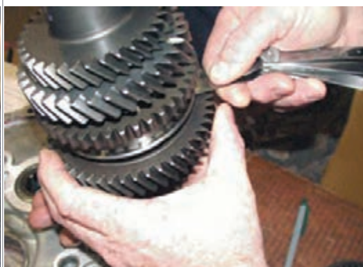
فیلر زدن برای بررسی لقی محوری چرخ دنده روی شفت
