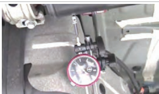
بررسی تاب گاردان با ساعت اندازه گیر روی خودرو
