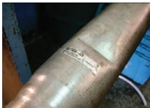
شکل ۱۲- دیدن آثار ضربه روی سطح میل‌گاردان
