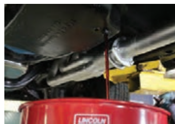
تخلیه روغن جعبه‌دنده
