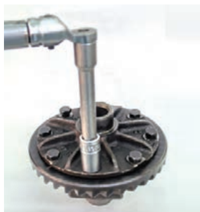
شکل ۶۲- بستن پیچ‌های کرانویل
