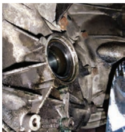
شکل ۲۴- بررسی محل نصب پلوس
