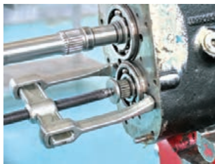
باز کردن بلبرینگ محور دنده زیر
