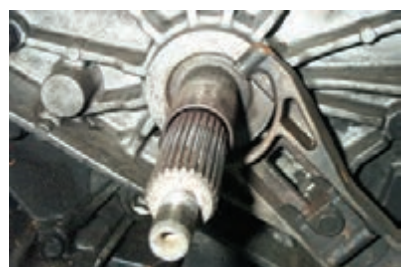
شکل ۲۳- بررسی هزار خاری شفت کلاچ
