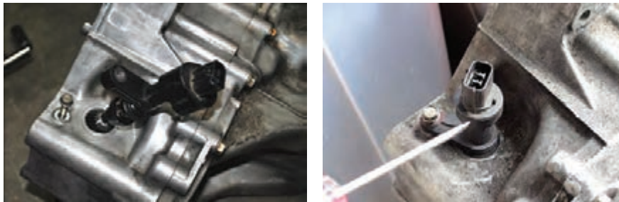
شکل ۱۲- روش تعویض میکروسویچ دنده عقب و حسگر سرعت
