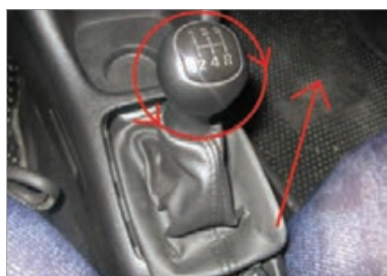
شکل ۱۱- بیرون آوردن سری و گردگیر دسته دنده
