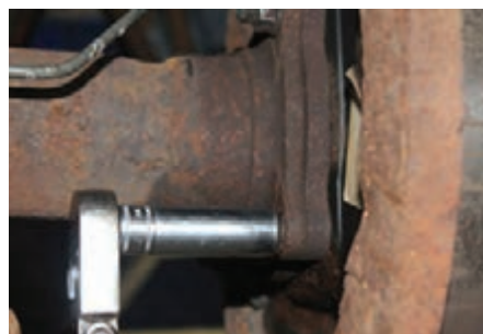
شکل ۷- گشتاورسنجی اتصالات پیچ و مهره‌ای پلوس‌ها
