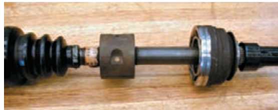
شکل ۱۹- پلوس با وزنه میراکننده (دمپر)
