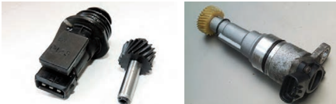
شکل ۸- حسگر سرعت خودرو روی جعبه دنده
