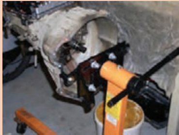
شکل ۶- نمونه‌های پایه تعمیراتی جعبه‌دنده و روش بستن آن
