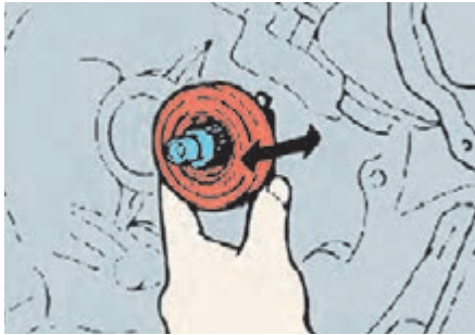
شکل ۳۱- روش بررسی حرکت بلبرینگ کلاچ روی شفت کلاچ
