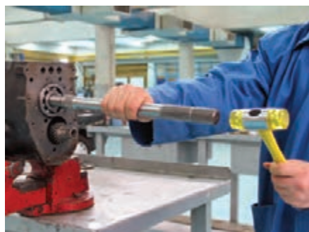
باز کردن بلبرینگ محور دنده زیر
