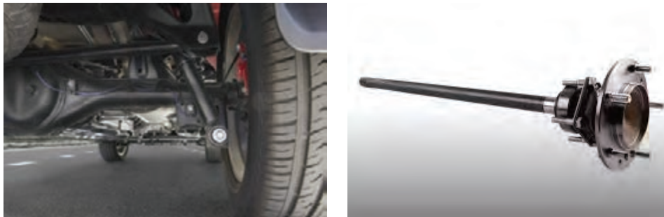
شکل ۲- پلوس صلب/دیفرانسیل یکپارچه
