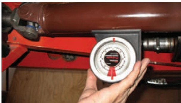
شکل ۱۰- روش کاربرد زاویه‌سنج میل‌گاردان
