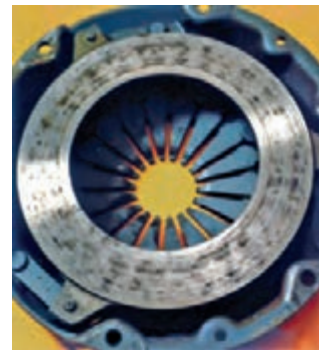
نمونه دیسک سوخته و معیوب
