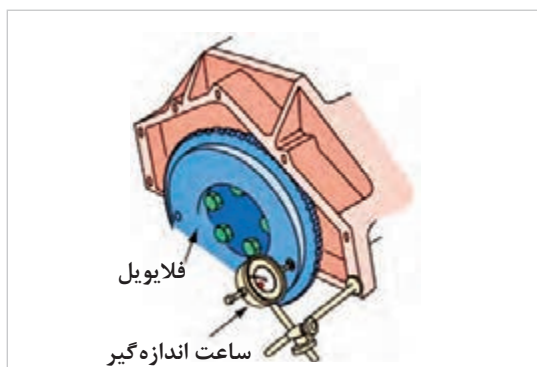
شکل ۲۶- روش اندازه گیری تاب فلاپیول
