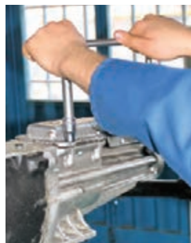
باز کردن مکانیزم تعویض دنده
