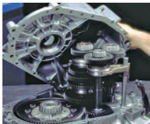
باز کردن پوسته جعبه‌دنده
