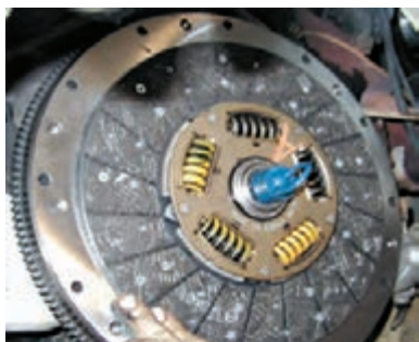
شکل ۲۸- هم‌مرکز کردن صفحه کلاچ و فلاپویل
