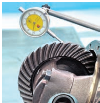
شکل ۶۵- اندازه گیری لقی بین دنده ها
