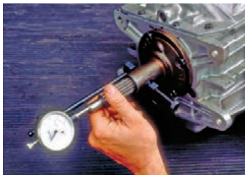
بررسی لقی طولی (محوری) شفت ورودی
