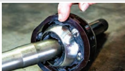
۱- قطعات مفصل برعکس مراحل بازکردن، بسته شود.
