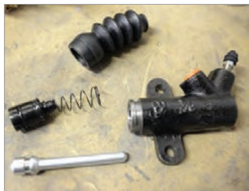
شکل ۱۵- اجزای سیلندر اصلی کلاچ
