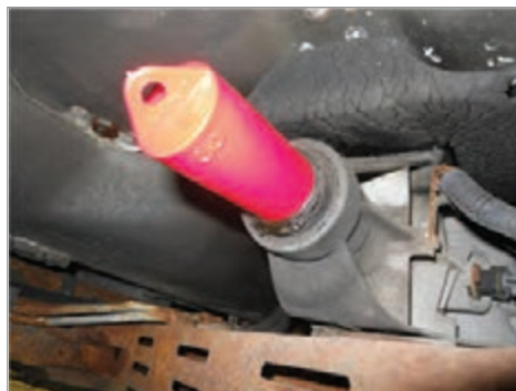
شکل ۱۶- کاربرد ابزار مخصوص کورکن
