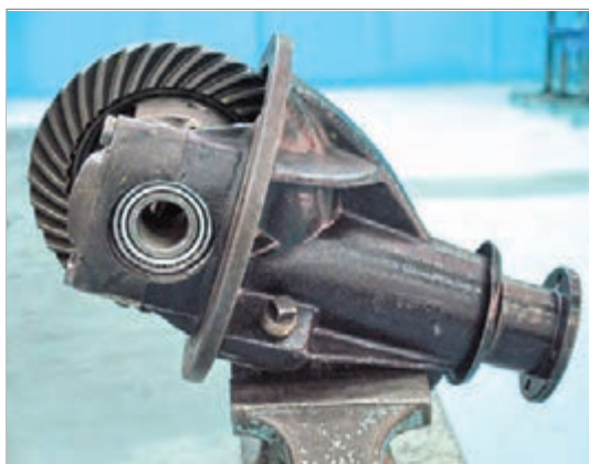
شکل ۳۹- بستن مجموعه دیفرانسیل روی گیره
