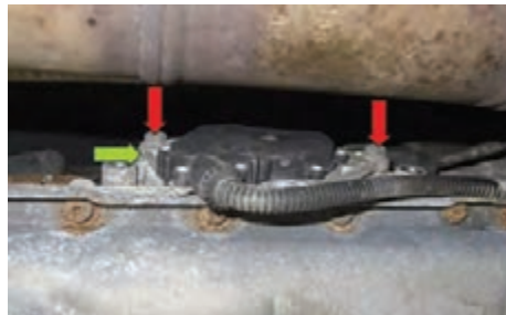
شکل ۱۴- تنظیم کابل تعویض دنده
