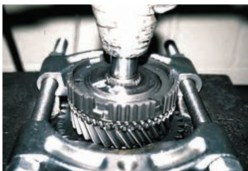
جدا کردن اجزای مجموعه جعبه‌دنده از روی محورها با کمک پرس و ابزار مخصوص
