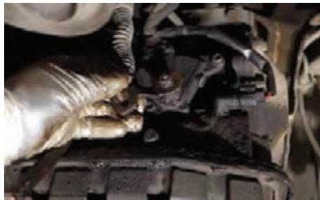
شکل ۱۴- تنظیم کابل تعویض دنده
