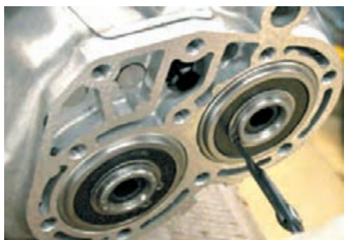
جاذدن خار قفلی نگهدارنده بلبرینگ روی شفت
