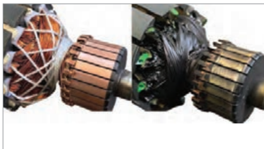
سوختن سیم پیچ
