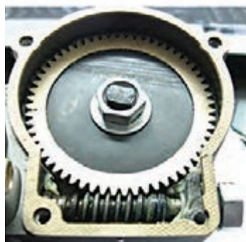
شکل ۱۱- دو نوع سیستم انتقال نیرو در موتور برف پاک کن
