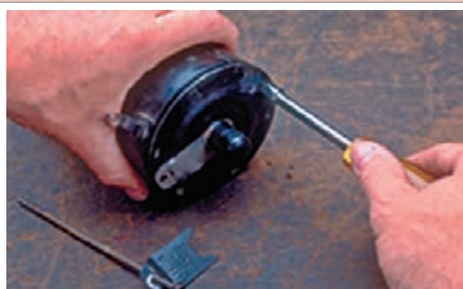
– باز کردن پیچ های اتصال درپوش به بدنه استارتر
