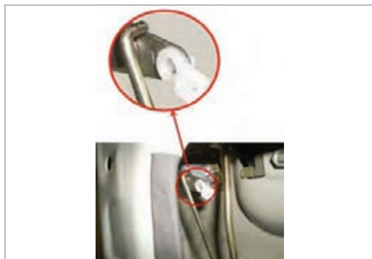
بررسی اتصالات اهرم‌بندی قفل در
