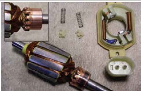
بررسی موتور شیشه بالابر از نظر کوتاه شدن زغال و فنر، ساییدگی کلکتور، بوش‌ها، کانکتور
