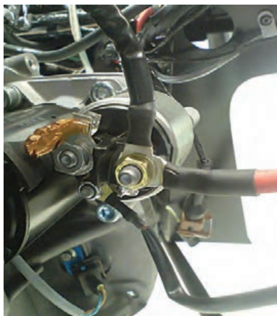
شکل ۱۳- بررسی استحکام اتصالات پیچ و مهره‌ای مجموعه استارتر
