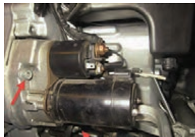
بازکردن پیچ‌های اتصال استارت به موتور
