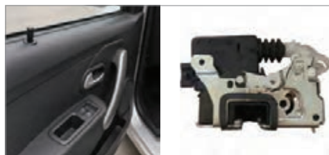
قفل در با دکمه قفل روی در (Lock knob)
