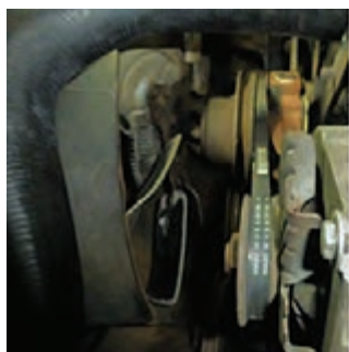
بررسی ناهم‌راستایی تسمه و اندازه کشش
