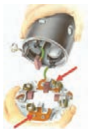
– بررسی عایق بودن پایه‌های زغال مثبت
