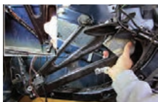
جدا کردن پایه‌های نگهدارنده مکانیزم شیشه بالابر
