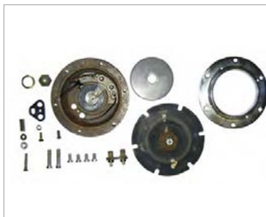
شکل ۲۱- اجزای داخلی بوق الکترومغناطیسی
