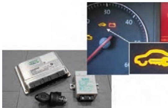
شکل ۱۹- یک نمونه ایموبلایزر و نشان هشدار پست آمپر
