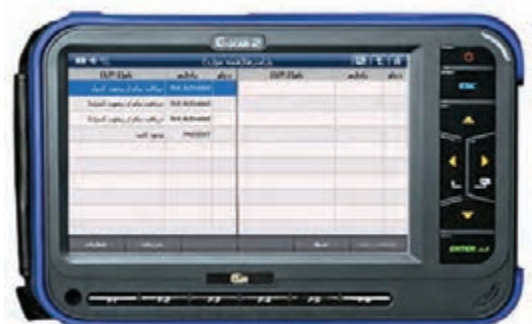
شکل ۴- بررسی عملکرد گیرنده با دستگاه عیب‌یاب (پارامتر)
