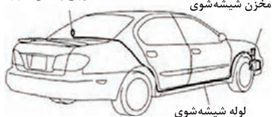
شکل ۱۵- لوله کشی آب برای شیشه شوی عقب خودرو
