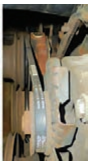
بررسی ناهم‌راستایی تسمه و اندازه کشش
