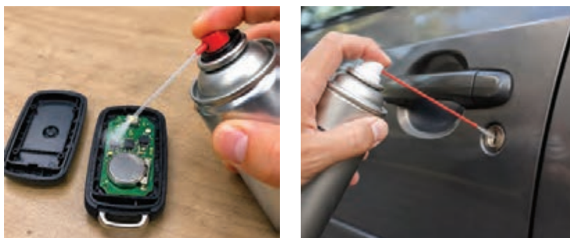
شکل ۸- تمیز کردن مغزی کلیدها و اتصالات ریموت
