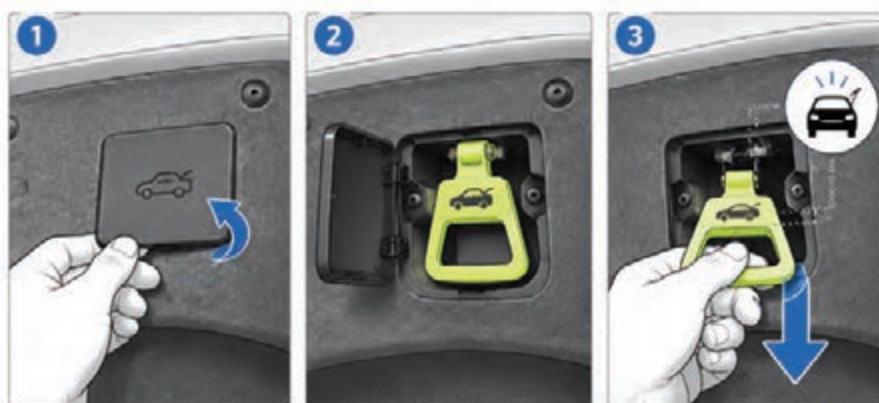
قفل بازکن اضطراری کابلی، جایگاه و روش کاربرد آن
