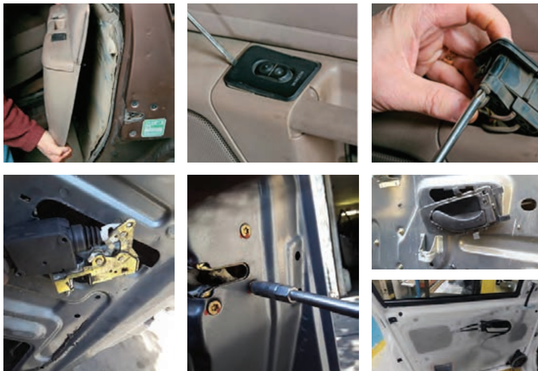
شکل ۱۷- روش باز کردن رودری، دستگیره‌های خودرو و اهرم‌بندی‌ها
