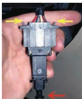
پایه رگلاژ میکروسوئیچ پدال ترمز و کانکتور آن
