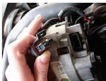
بررسی ظاهری کانکتورها از نظر شکستگی
