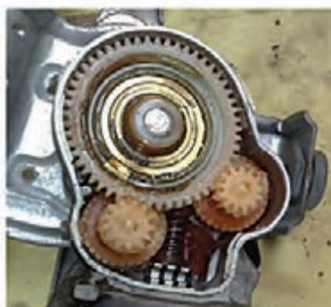
شکل ۱۱- دو نوع سیستم انتقال نیرو در موتور برف پاک کن
