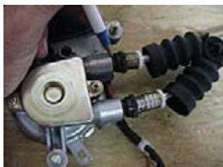
بررسی موتور شیشه بالابر از نظر کوتاه شدن زغال و فنر، ساییدگی کلکتور، بوش‌ها، کانکتور
