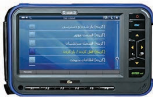
شکل ۵- بررسی عملکرد پمپ‌ها با دستگاه عیب‌یاب (آزمایش عملگر) و آزمایش اهمی
