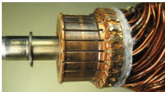
بررسی شکستگی و سایدگی کلکتور
