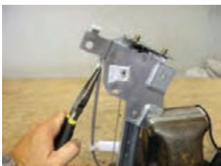
بررسی موتور شیشه بالابر از نظر کوتاه شدن زغال و فنر، ساییدگی کلکتور، بوش‌ها، کانکتور
