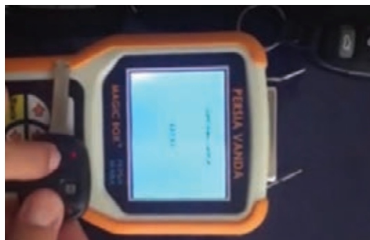
شکل ۳- بررسی عملکرد ریموت و فرکانس با دستگاه مخصوص
