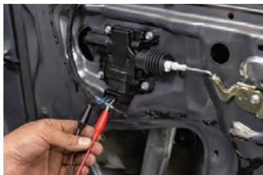
شکل ۵- بررسی عملکرد پمپ‌ها با دستگاه عیب‌یاب (آزمایش عملگر) و آزمایش اهمی
