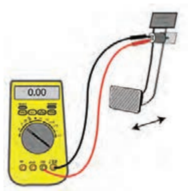
شکل ۳- آزمایش فشنگی پدال ترمز (یک نوع کلید)
