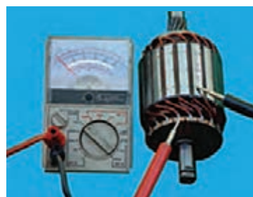
آزمایش اتصال بدنه آرمیچر (بررسی اتصال بدنه نداشتن کلکتور)
