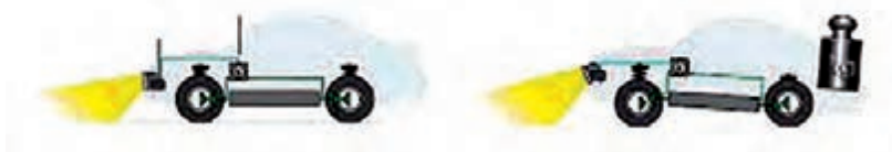
شکل ۳- دلیل نیاز به سیستم تنظیم ارتفاع چراغ
