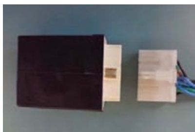
نوعی کنترل یونیت قفل مرکزی و دسته سیم آن
