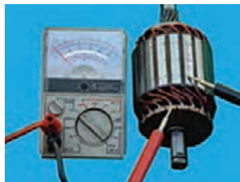
– آزمایش اتصال بدنه آرمیچر
