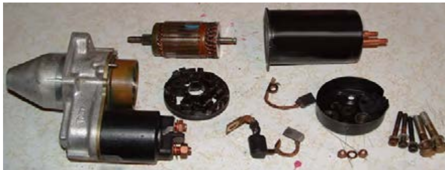
شکل ۱۴- اجزای استارت از نوع بالشتک با آهنربای دائم
