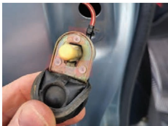
شکل ۶- بررسی عملکرد کلید لادری
