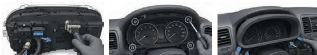
شکل ۳۶- روش باز کردن نشان دهنده در خودروهای امروزی
