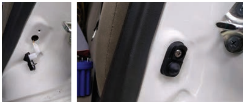
شکل ۱۰- باز کردن و سرویس کلید لادری
