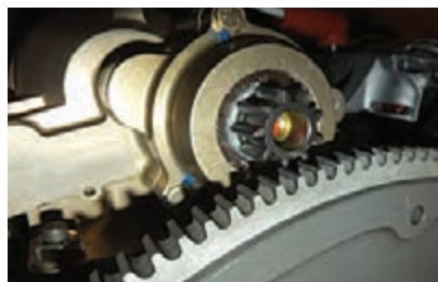
ارتباط دنده فلاپویل با دنده استارت
