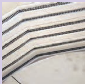
محل قرارگیری المنت‌ها بر روی دیواره کوره برقی
