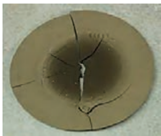
شکل ۱۱- مشکلات ترک خوردگی و شکستن قطعه به دلیل خشک شدن ناهمگن
