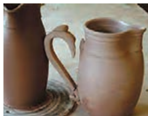
شکل ۱۹- جدا شدن دسته در اثر عدم خشک شدن یکنواخت
