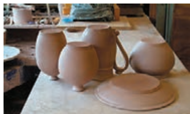
شکل ۱۶- سر و ته کردن قطعات سرامیکی جهت تسهیل خشک شدن بخش‌هایی که ضخامت بیشتر دارند.
