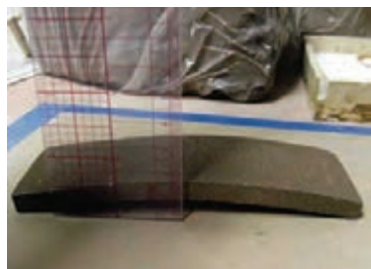
شکل ۱۲- مشکلات تاب خوردگی به دلیل عدم خشک شدن همگن
