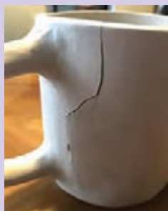
شکل ۱۱- مشکلات ترک خوردگی و شکستن قطعه به دلیل خشک شدن ناهمگن
