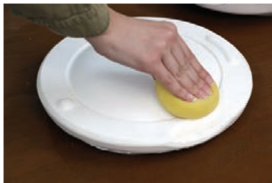
شکل ۲۶- تمیز کردن قالب
