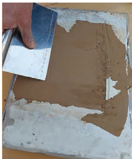
شکل ۱۳- صاف کردن پشت خشت به وسیله لیسه
