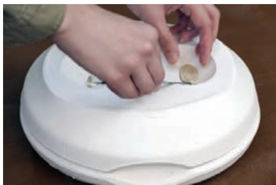
شکل ۳۲- جدا کردن قیف‌ها و باز کردن قالب
