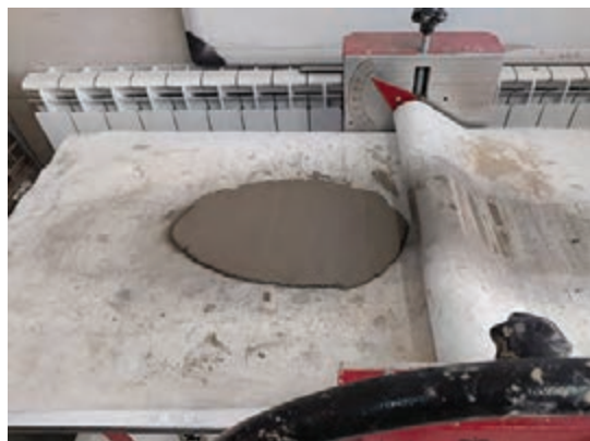
شکل ۸- ورقه کردن گل با دستگاه اسلبرولر
