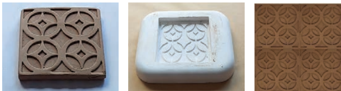
شکل ۲۴- تکثیر خشت با قالب و کنار هم قرار دادن خشت‌ها
