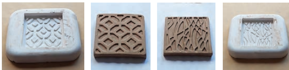
شکل ۵- نمونه خشت گلی ساخته شده با قالب گچی
