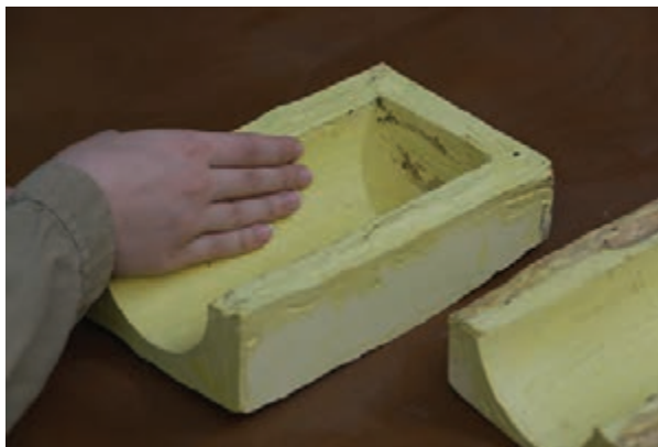
شکل ۳۷- رطوبت سنجی قالب گچی
