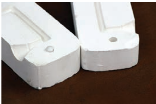
شکل ۲۸- پین‌های قالب‌های دو تکه
