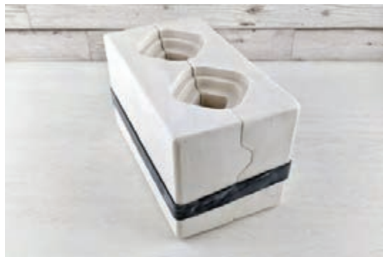
شکل ۲۷- بستن قالب با لاستیک کشی
