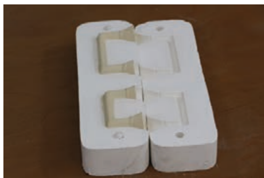
شکل ۴۰- باز کردن قالب
