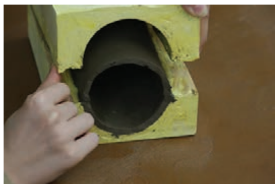
شکل ۴۵- باز کردن قالب
