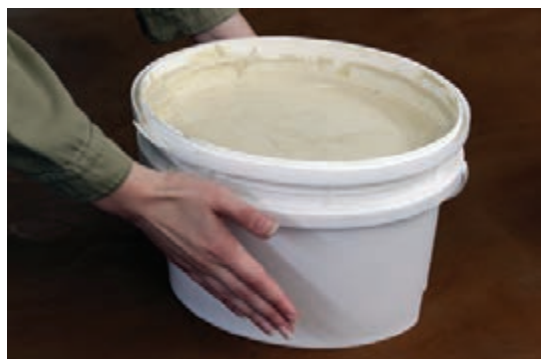
شکل ۲۵- همگن کردن دوغاب ریخته‌گری
