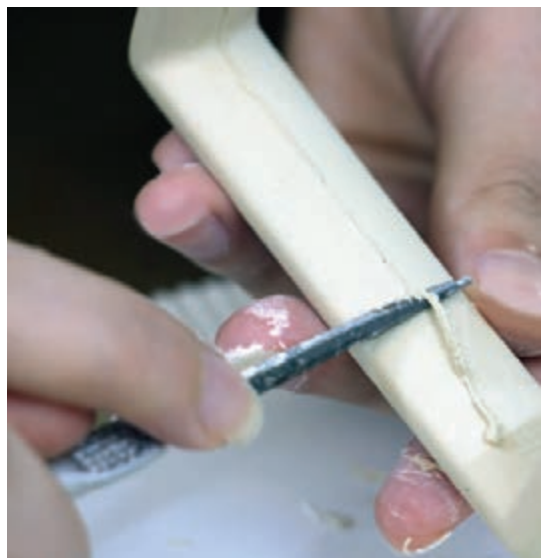
شکل ۱۷- پرداخت درز قطعه دوغابی
