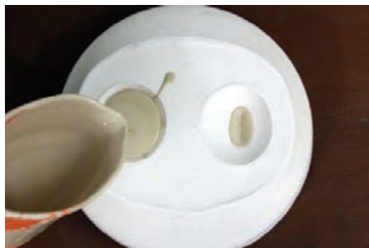
شکل ۲۳- مجراهای قالب توپر
