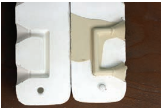
شکل ۲۹- بیرون ریختن دوغاب از درز قالب
