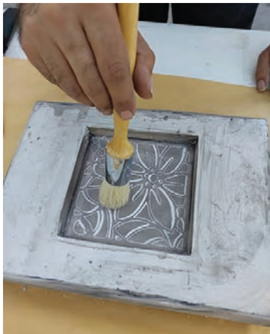
شکل ۲۲- تمیز کردن قالب پس از خراش به وسیله قلم‌مو
