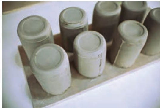
شکل ۱۳- زوائد روی قطعات دوغابی قبل از پرداخت
