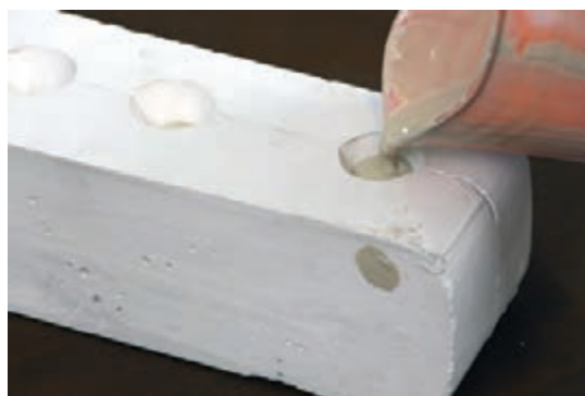
شکل ۳۹- ریختن دوغاب در قالب
