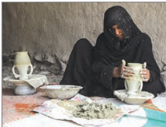
شکل ۲- ساخت گلدان با حرکت صفحه زیر کار، کلیورگان
