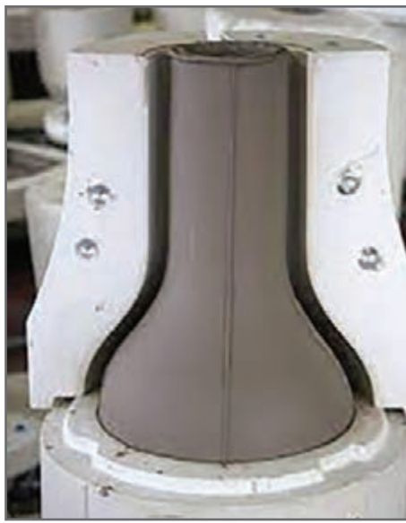
شکل ۴۲- درز قالب شکل
