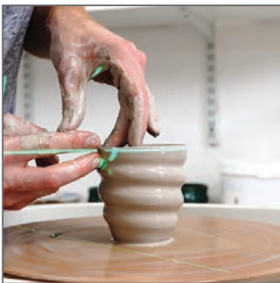
شکل ۳۲- خط‌های راهنمای لیزری روی بدنه حجم در حال چرخکاری
