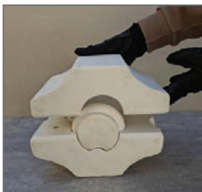
شکل ۲۸- چفت کردن قطعات قالب
