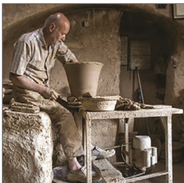
شکل ۹- نمونه‌ای از چرخ‌های کارگاهی تک دور
