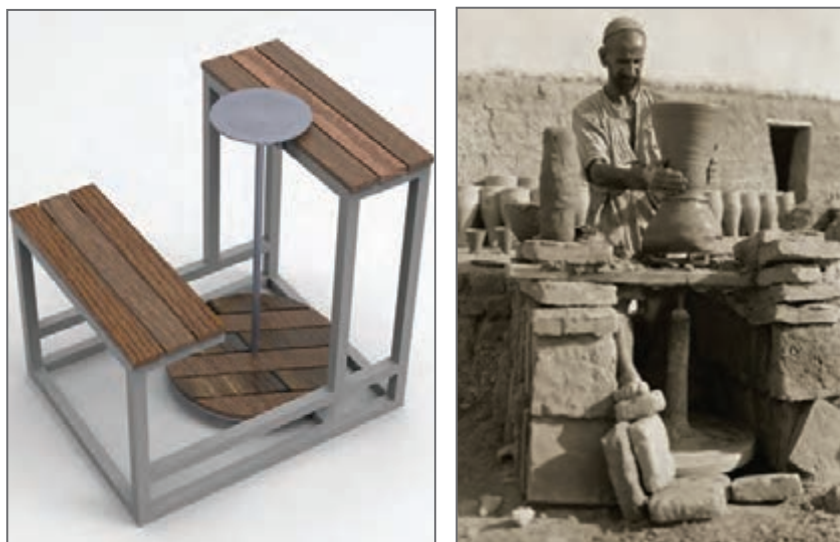
شکل ۷- چرخ سفالگری چند قسمتی اولیه، نیروی حرکت چرخ طیار پای سفالگر
