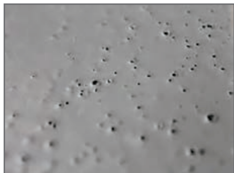
شکل ۴۰- سوراخ‌های سوزنی روی سطح قطعه
