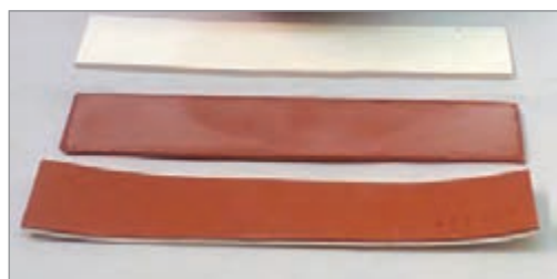
شکل ۳۳- اعمال انگوب بر روی حالت های مختلف بدنه
