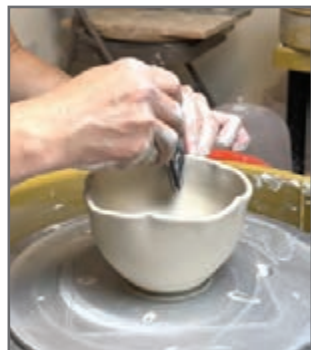
شکل ۴۲- ایجاد تغییر در شکل دهانه کاسه با دست و ابزار
