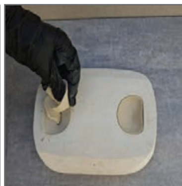
شکل ۳۷- خارج کردن سرقیف‌ها
