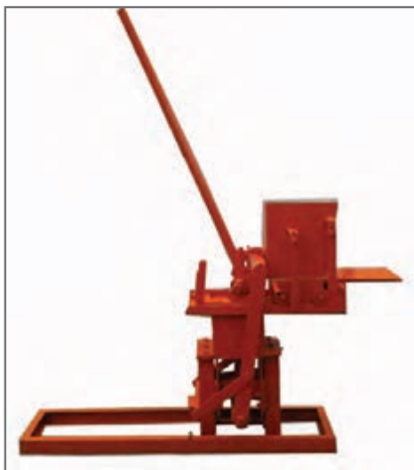
شکل ۱۳- دستگاه قالب زنی با پرس دستی
