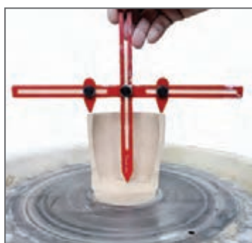
شکل ۳۴- نمونه‌ای از ابزار اندازه‌گیری برای سنجش هم‌زمان عمق و قطر دهانه
