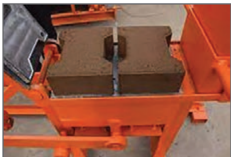
شکل ۱۴- خشت قالب زده با پرس دستی
