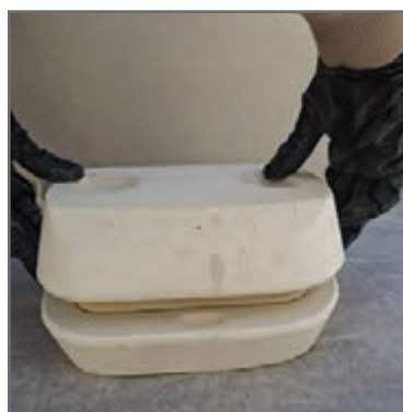
شکل ۳۸- جدا کردن لتهای قالب
