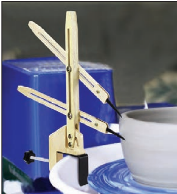
شکل ۳۱- میله‌های راهنما که پیرامون حجم در حال ساخت نصب شده
