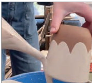
شکل ۲۵- اعمال به روش ریختنی
