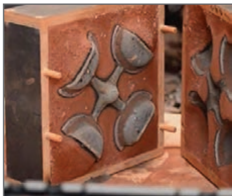
شکل ۷- قالب شنی برای ریخته‌گری فلز مذاب
