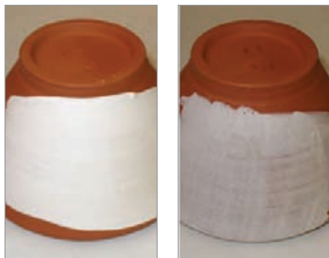
شکل ۱۲- دو انگوب با تغییر نسبت مواد پرکننده
