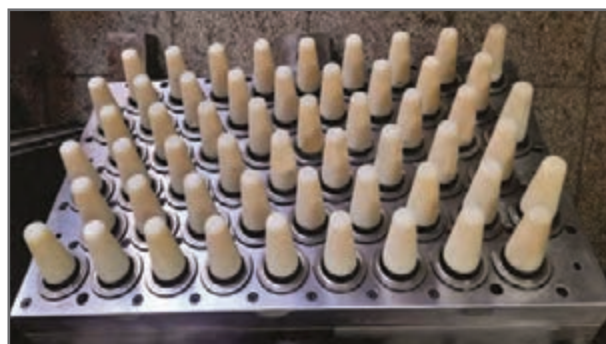
شکل ۵- قالب ساخت لیوان یکبار مصرف
