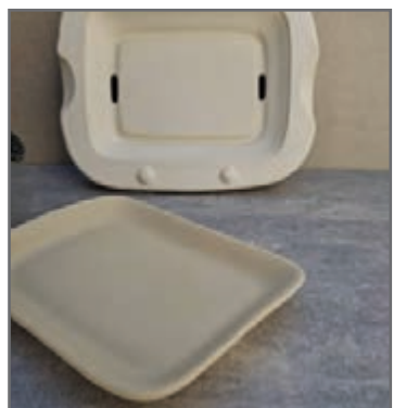
شکل ۳۹- خارج کردن محصول از قالب
