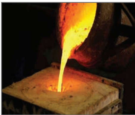
شکل ۷- قالب شنی برای ریخته‌گری فلز مذاب
