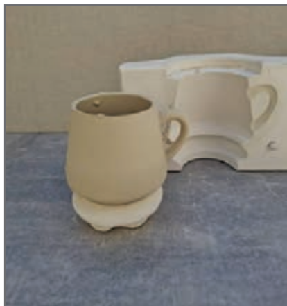
شکل ۳۲- خارج کردن محصول از قالب
