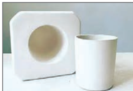
شکل ۱۹- قالب یک تکه
