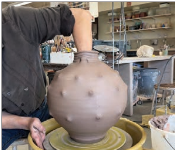
شکل ۴۱- ایجاد تزئین با فشار سرانگشتان از داخل حجم در حالت چرمینه
