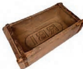
شکل ۱۲- قالب چوبی کفه‌دار و بدون کفه برای ساخت آجر
