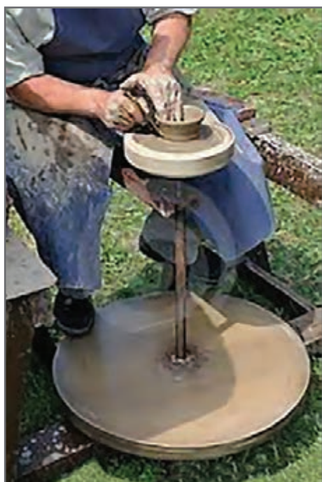
شکل ۴- نیروی محرکه به وسیله چرخ طیار و حرکت پا
