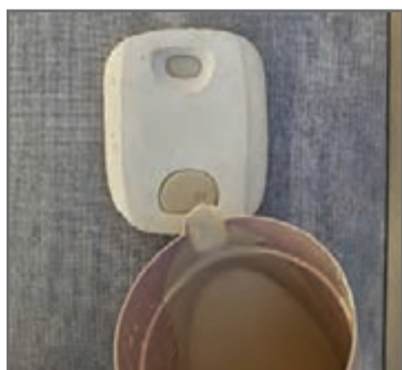
شکل ۳۶- ریختن دوغاب از نازل ورودی
