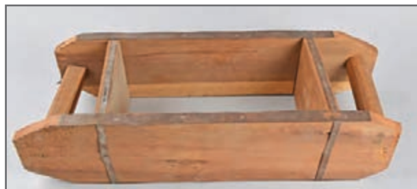
شکل ۱۲- قالب چوبی کفه‌دار و بدون کفه برای ساخت آجر
