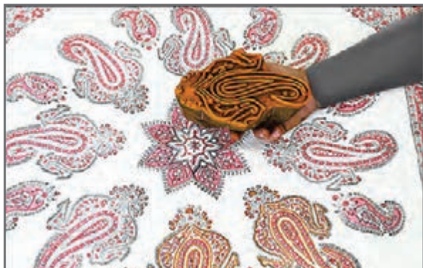
شکل ۶- قالب چاپ قلمکار از جنس چوب گلابی
