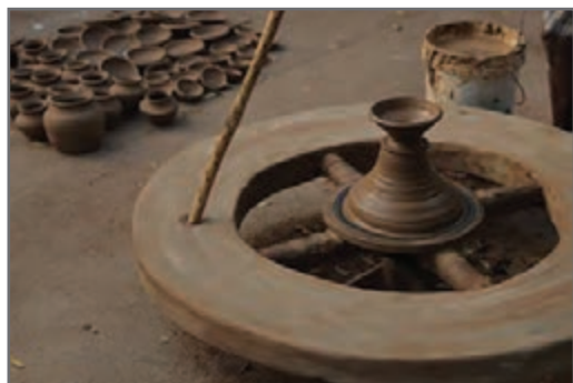
شکل ۶- نیروی محرکه به وسیله چرخ طیار و حرکت آن به کمک دسته
