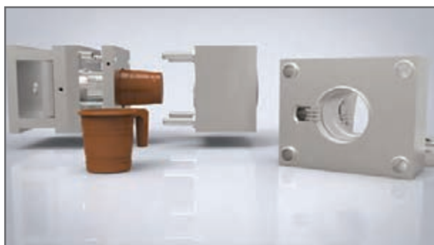
شکل ۵- قالب ساخت لیوان یکبار مصرف
