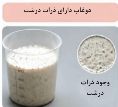
شکل ۱۱- دوغاب لعاب با دانه بندی غیراستاندارد
