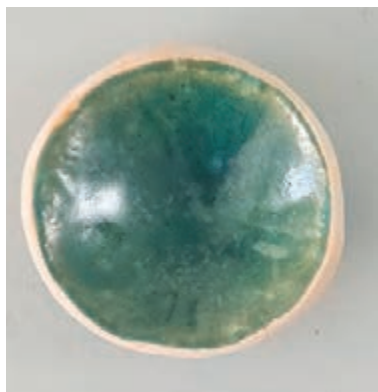
شکل ۳۳- لعاب قلیایی + اکسید مس ۳٪ روی بدنه ارتنور سفید شکل ۳۴- لعاب قلیایی + اکسید مس ۳٪ روی بدنه ارتنور قرمز
