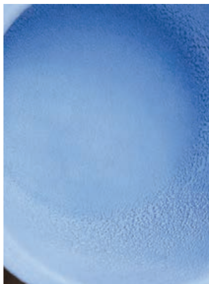
شکل ۲۷- تجمع لعاب در اثر پاشش
