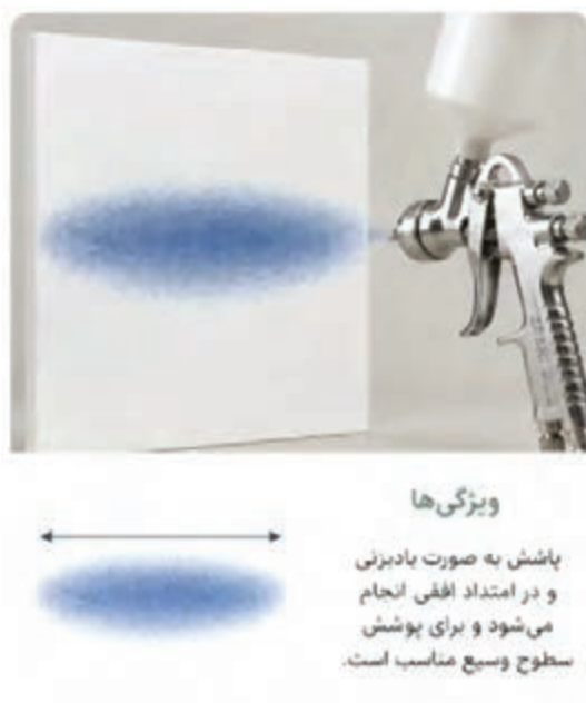
شکل ۱۷- الگوی پاشش بادبزنی افقی
