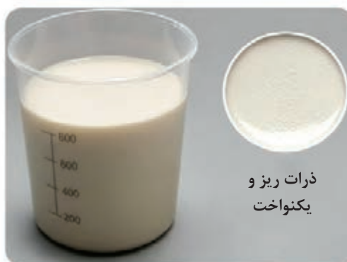
شکل ۹- دوغاب لعاب همگن شده با مش ۸۰ با گرانیوی مناسب و جریان یکنواخت
