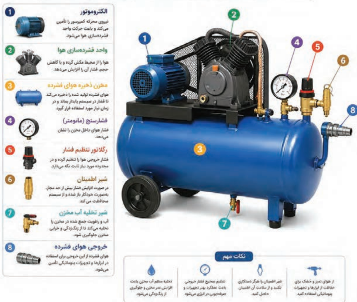
شکل ۱- کمپرسور و اجزای آن
