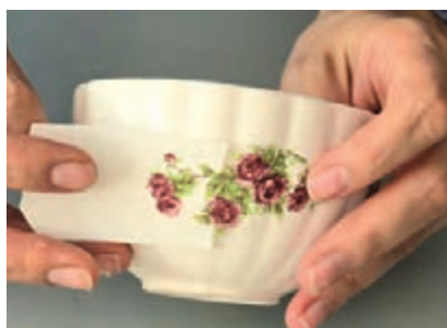
شکل ۱۹- انتقال عکس برگردان روی قطعه و جدا کردن کاغذ
