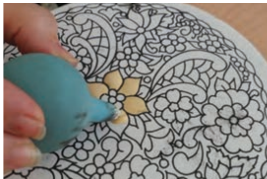
شکل ۱۵- لعاب زنی با پمپ پلاستیکی (پوار)
