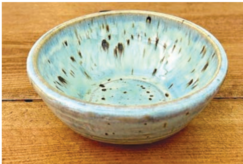
شکل ۲۰- خال‌های رنگی ناشی از ذرات درشت اکسید
