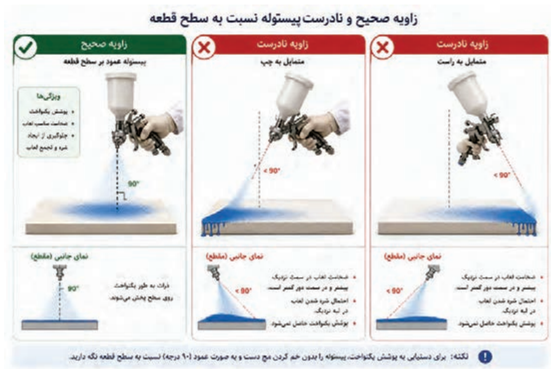
شکل ۲۱- زاویه پیستوله نسبت به قطعه
