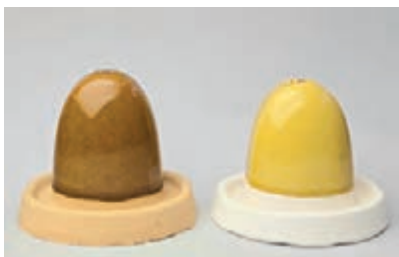
شکل ۴۶- آزمون رنگ شفاف روی بدنه ارتن‌ور سفید و قرمز
