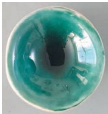
شکل ۳۵- لعاب سربی + اکسید مس ۳٪ روی بدنه ارتنور سفید شکل ۳۶- لعاب سربی + اکسید مس ۳٪ روی بدنه ارتنور قرمز
