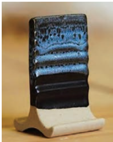
شکل ۴۳- آزمون T شکل
