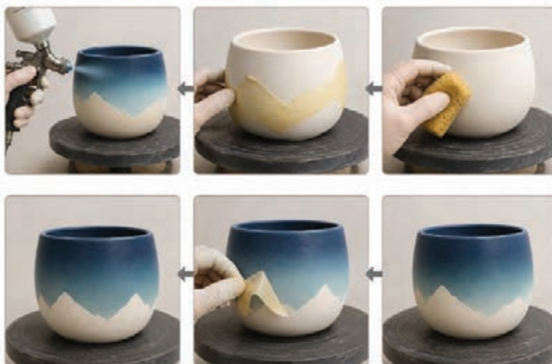
شکل ۵۲- ایجاد پوشش موقت روی قطعه لعاب‌دار و سایه پاشی با پیستوله
