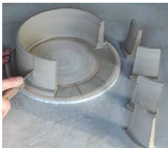
شکل ۴۹- برش استوانه چرخکاری شده در مرحله چرمینه با ابزار برش
