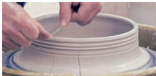
شکل ۴۸- برش استوانه چرخکاری شده در مرحله پلاستیک با سیم برش
