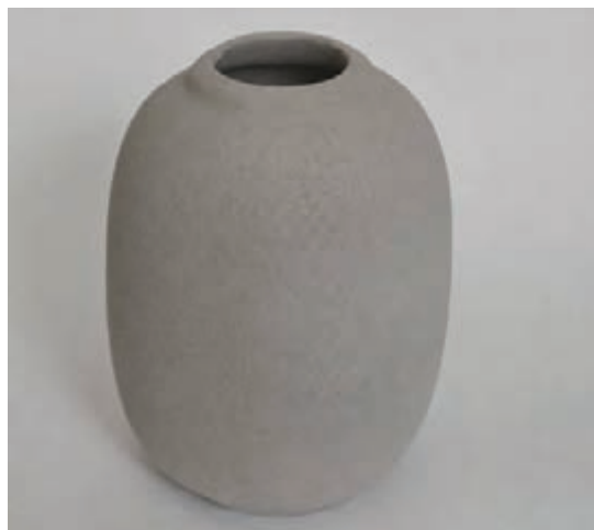
شکل ۶۷- قطعه لعاب‌خورده با ترانس و اکسید مس ۵٪
