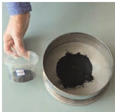
شکل ۲۳- انتقال پودر دانه‌بندی شده خشک به ظرف
