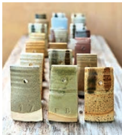
شکل ۴۰- آزمون ایستاده برای سنجش میزان شره لعاب
