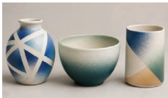
شکل ۳۰- قطعات لعاب‌زنی شده با روش ماسکه کردن
