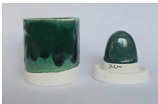
شکل ۶۱- آزمون حجمی لعاب‌دار و قطعه لعاب‌کاری شده با شکل ۶۲- نتیجه آزمون و قطعه لعاب‌خورده با همان لعاب همان لعاب
