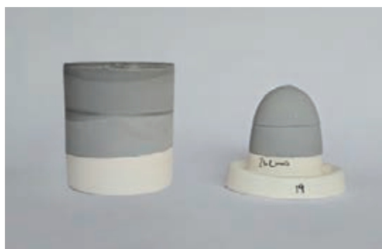
شکل ۶۱- آزمون حجمی لعاب‌دار و قطعه لعاب‌کاری شده با شکل ۶۲- نتیجه آزمون و قطعه لعاب‌خورده با همان لعاب همان لعاب
