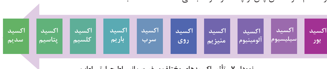
نمودار ۷- تأثیر اکسیدهای مختلف بر ضریب انبساط حرارتی لعاب
