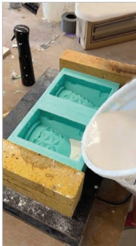
شکل ۲۵- تکثیر قالب با قالب مادر سیلیکونی
