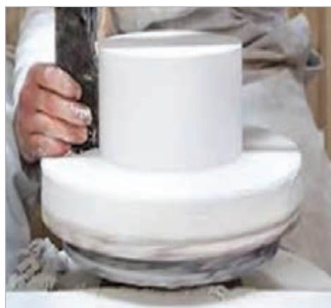
شکل ۱۵- تراش مدل گچی با استفاده از دستگاه مدل‌سازی افقی و عمودی
