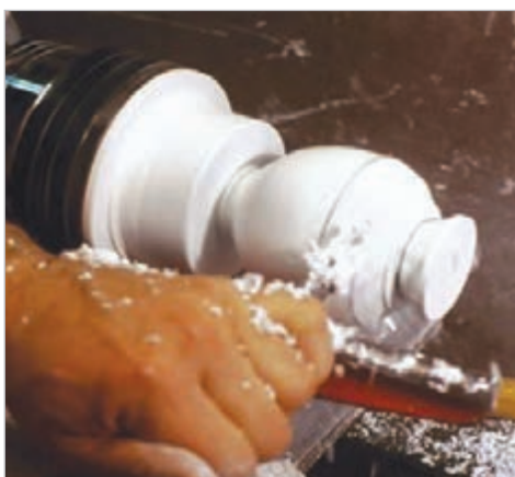
شکل ۱۵- تراش مدل گچی با استفاده از دستگاه مدل‌سازی افقی و عمودی
