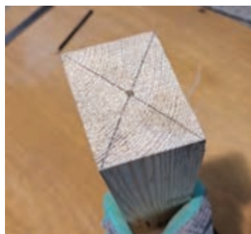
شکل ۱۶- مراحل مرکزیابی روی چوب چهارتراش
