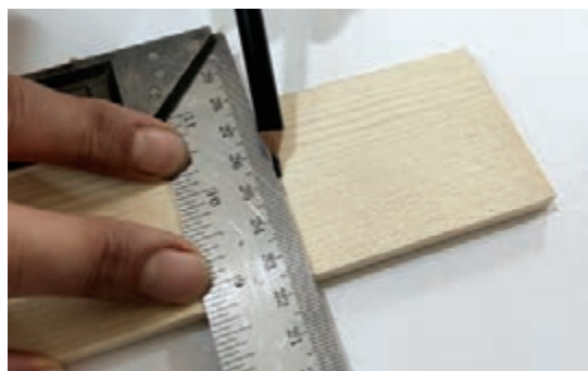
شکل ۵- انتقال اندازه‌ها روی چوب
