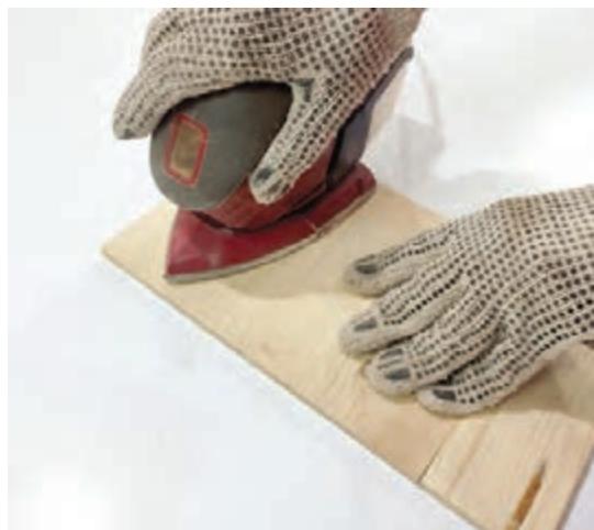
شکل ۱۵- آماده سازی سطح چوب قبل از انتقال طرح
