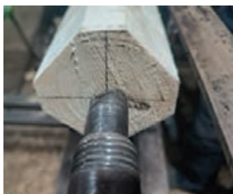
شکل ۳۳- کنترل بالانس بودن دستگاه و قطعه
