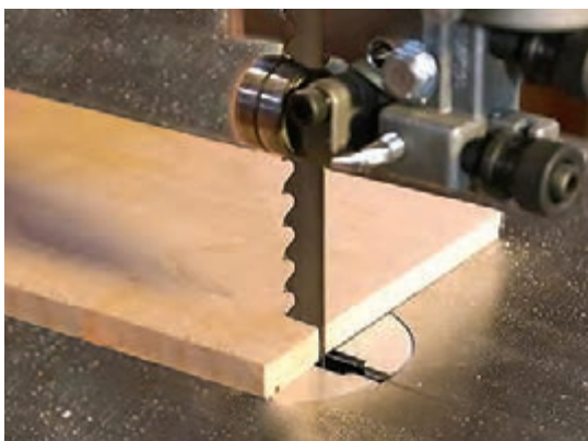
شکل ۷- برش چوب با اره فلکه
