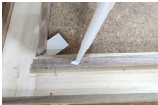
شکل ۷۰- چسباندن زهوار داخلی
