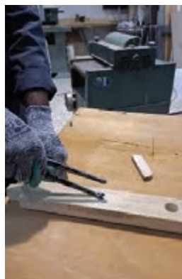
شکل ۸- خارج کردن میخ از چوب با گاز انبر
