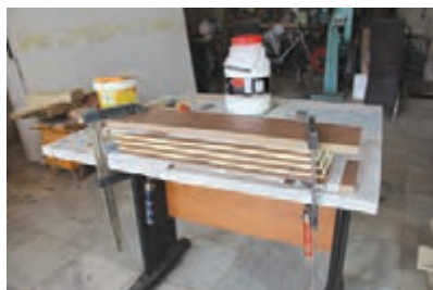
شکل ۸- چسب زدن و پرس لایه ها
