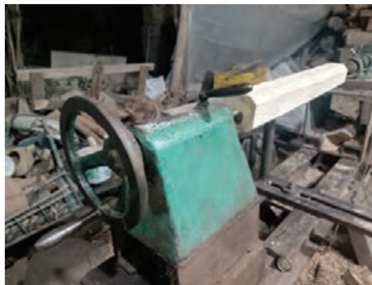
شکل ۲۴- قرار گرفتن مرگک و چهار نیش بر نقطه مرکزی قطعه چوب
