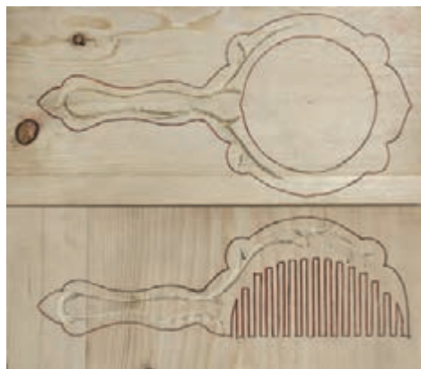
شکل ۲۳- پایان مرحله شیاراندازی با فرز مینیاتوری
