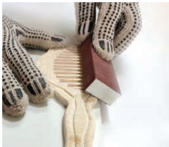
شکل ۳۶- سوهان و سنباده کاری دندانه‌ها
