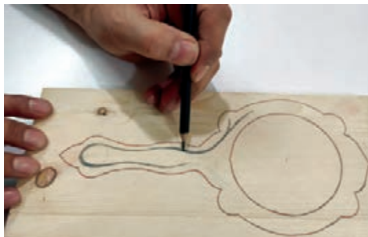
شکل ۱۹- مشخص کردن شیارهای تزئینی با مداد رو و پشت چوب
