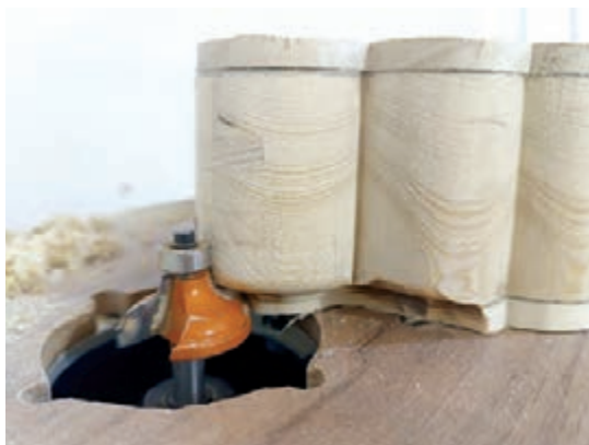
شکل ۴۹- ابزارزنی لبه ها با اورفرز
