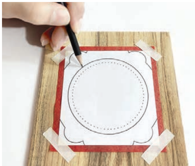
شکل ۳۰- انتقال الگوی زهوار بر روی چوب
