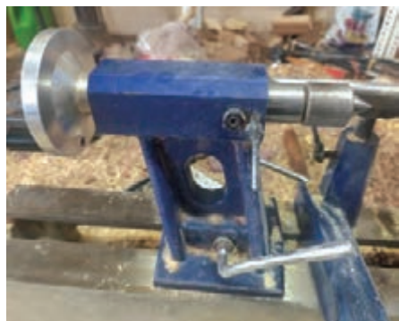
شکل ۲۱- مرگ متحرک دستگاه، پایه و ضامن
