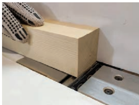
شکل ۲۹- رنده کردن قطعات جعبه
