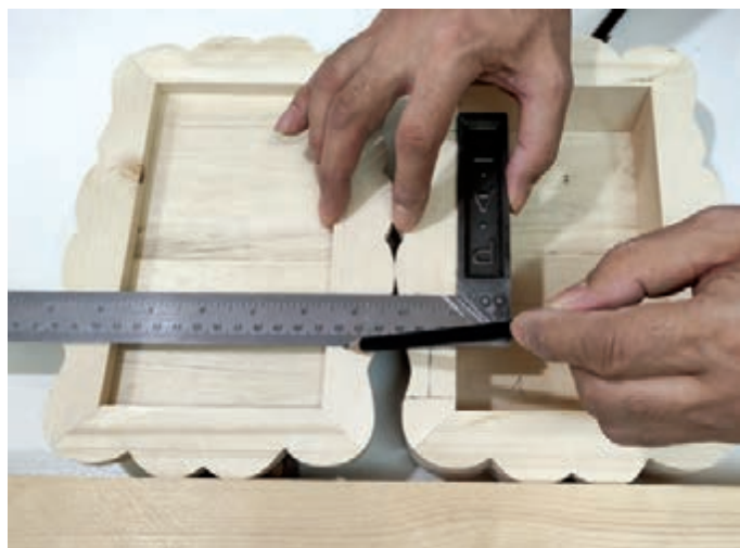
شکل ۵۴- مشخص کردن محل نصب لولا
