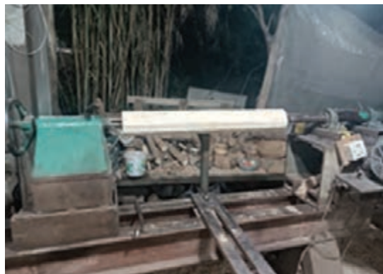
شکل ۲۳- مراحل اتصال مرغک چهارنیش به نقطه مرکز یابی شده قطعه
