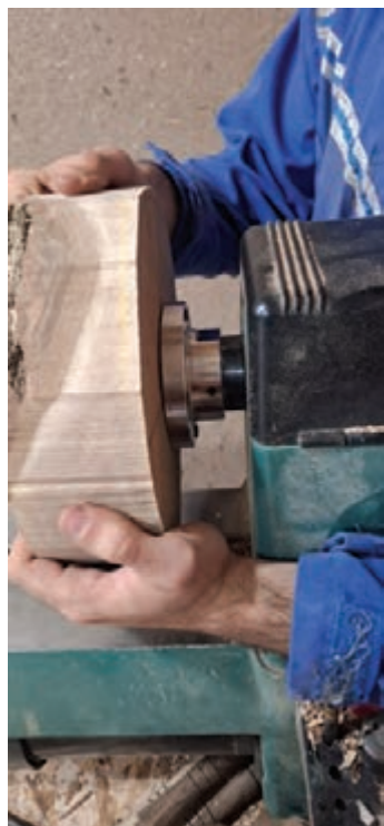
شکل ۶- آماده سازی قطعه کار برای بیرون تراشی
