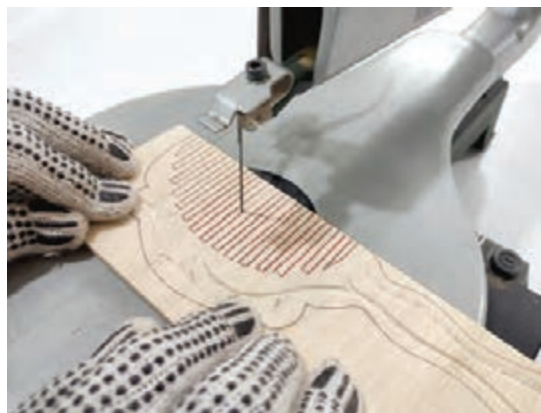
شکل ۳۵- برش دندانهای شانه
