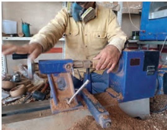
شکل ۴۲- محکم کردن اهرم مرگک پس از قرار دادن چوب روی دستگاه
