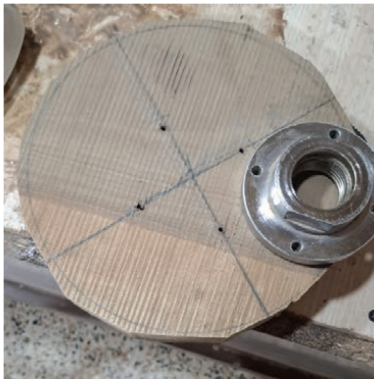
شکل ۵- بستن قطعه به چهار نظام به وسیله پیچ حلزونی
