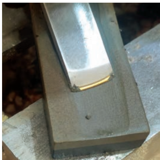
شکل ۳۶- پلیسه‌گیری مغار موب و نیزه‌ای
