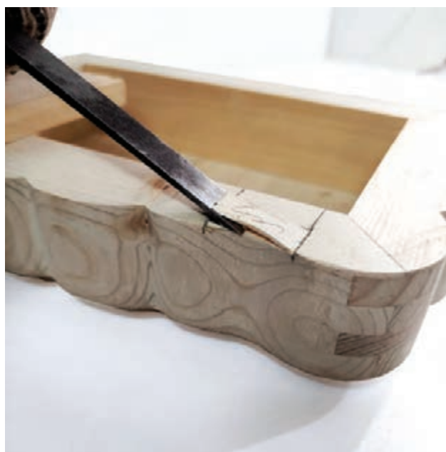
شکل ۵۵- خالی کردن محل لولاها به وسیله مغار
