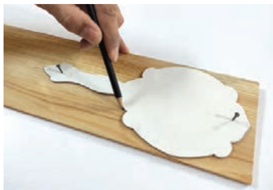
شکل ۱۴- روش انتقال طرح با شابلون
