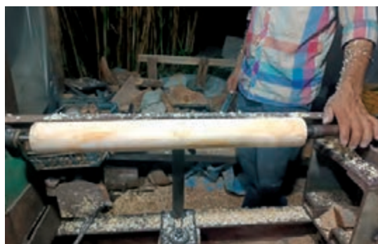
شکل ۴۰- اتصال قطعه گرد تراشی شده روی دستگاه خراطی
