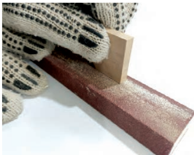
شکل ۷۳- اصلاح جزئی مربع‌ها به وسیله سنباده
