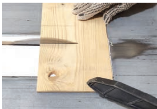
شکل ۴۸- برش عرضی قطعه چوب
