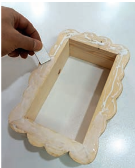
شکل ۴۶- چسب زدن قطعات کف و در جعبه
