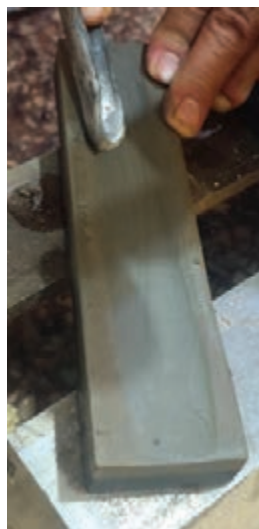
شکل ۳۵- پلیسه‌گیری مغار گلویی
