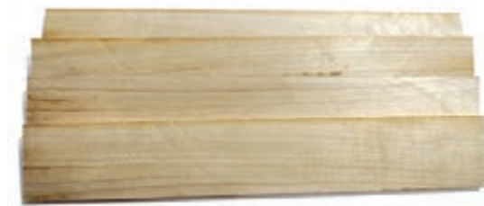
شکل ۴۷- نوارهای آماده شده از برش طولی چوب
