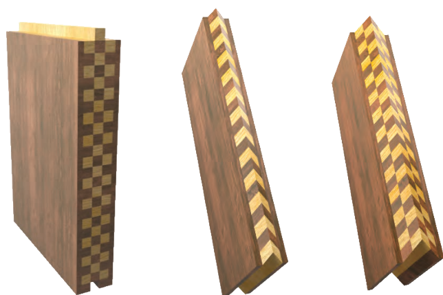
شکل ۱۸- چیدمان شطرنجی مربع و اُریب
