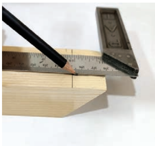
شکل ۳۳- رسم محل اتصال قلیف
