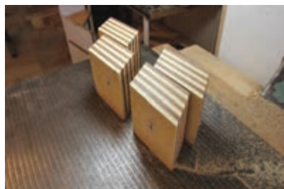
شکل ۱۶- تصاویر قامه اصلی (قامه بزرگ)، آماده برش به لایه های نازک تر برای ساخت قامه نهایی
