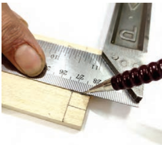
شکل ۱۵- علامت گذاری محل دندانها
