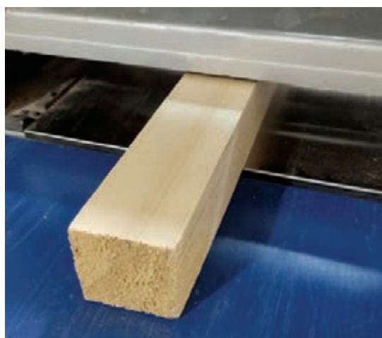
شکل ۳۰- گندگی قطعات جعبه
