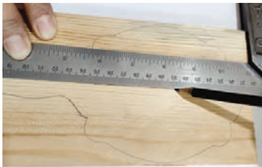
شکل ۱۹- مشخص کردن شیارهای تزئینی با مداد رو و پشت چوب
