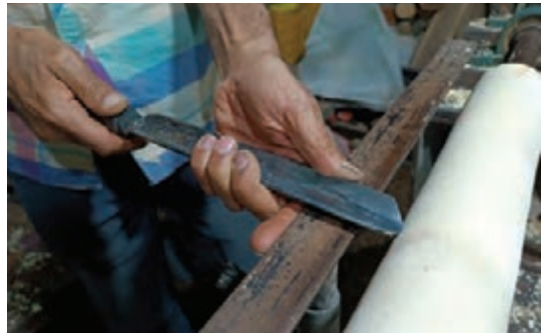
شکل ۳۲- روش صحیح در دست گرفتن مغار هنگام کار
