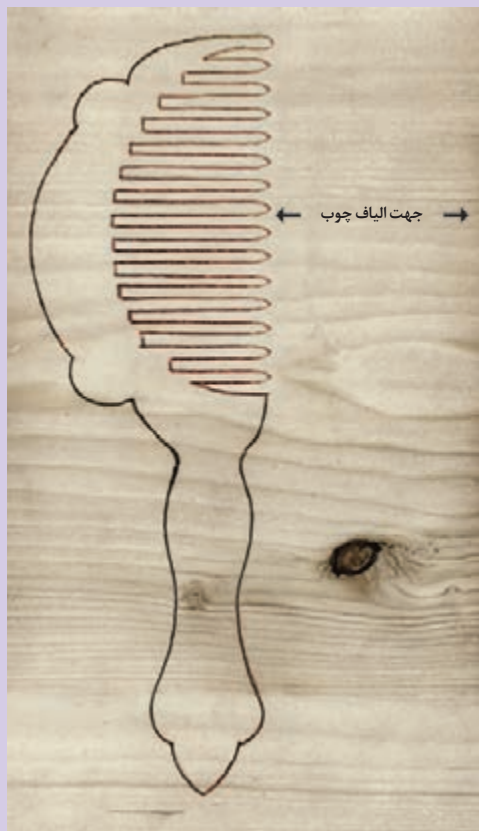
شکل ۴- تشخیص جهت الیاف چوب
