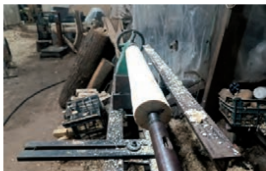
شکل ۴۰- اتصال قطعه گرد تراشی شده روی دستگاه خراطی
