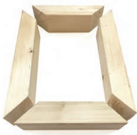
شکل ۳۱- برش قطعات دیواره جعبه
