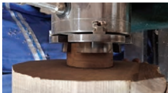
شکل ۴- بستن قطعه به چهار نظام
