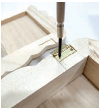
شکل ۵۷- بستن پیچ‌های لولا
