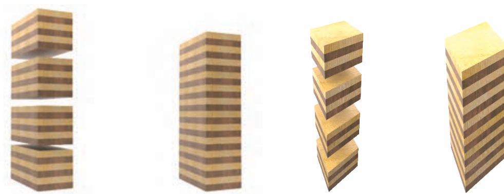
شكل ۱۲- چيدمان و پرس قطعات قامه اوليه
