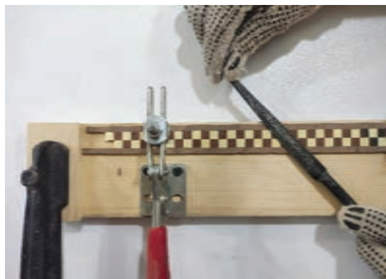
شکل ۲۷- روش یکنواخت کردن ضخامت ورقه‌ها
