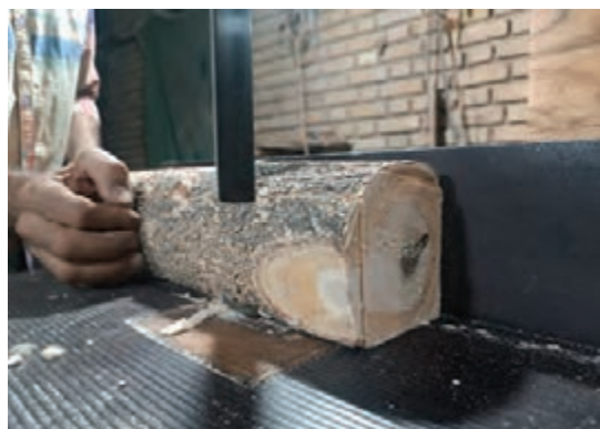
شکل ۱۲- برش چوب با اره نواری
