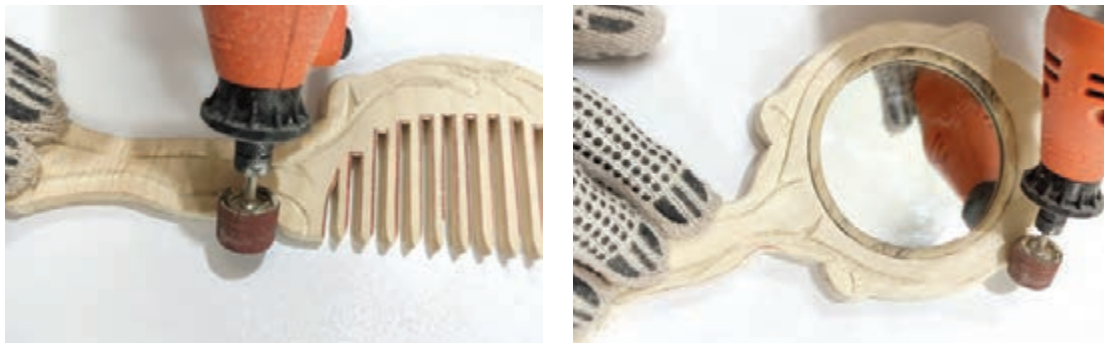
شکل ۴۴- پرداخت کاری آینه و شانه با فرزمینیاتوری
