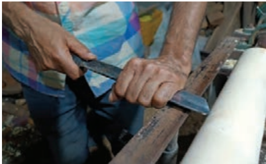
شکل ۳۲- روش صحیح در دست گرفتن مغار هنگام کار
