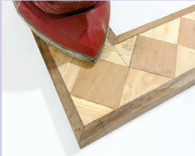
شکل ۷۶- سنباده زنی نهایی کار با دستگاه لرزان
