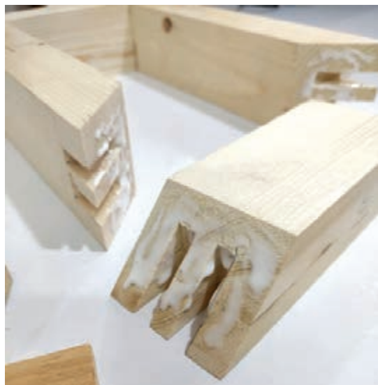
شکل ۳۸- چسب کاری قطعات اتصال
