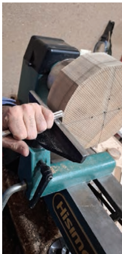
شکل ۸- نمونه کاسه در حال بیرون تراشی
