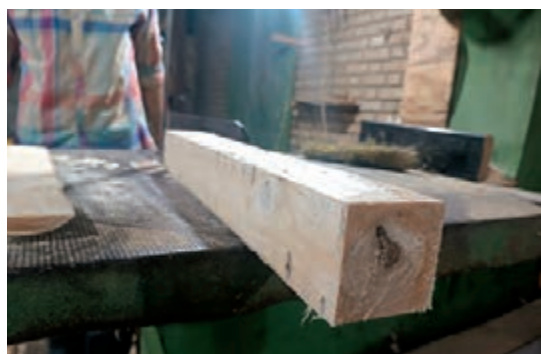
شکل ۱۴- چوب چهار تراش شده
