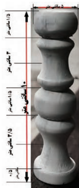
شکل ۴۴- نمونه یک پایه فرم‌دهی شده با ابعاد و اندازه بخش‌های مختلف آن
