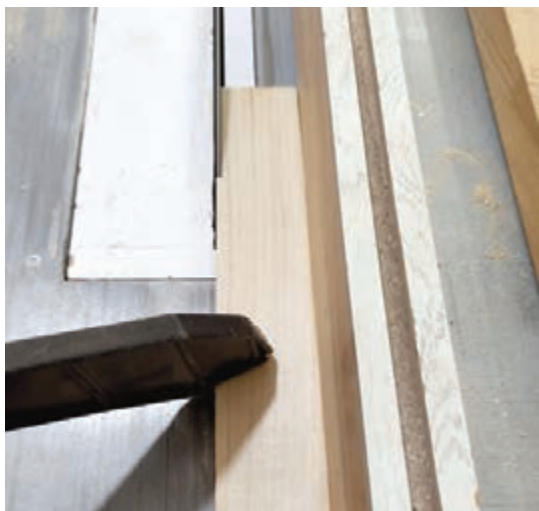
شکل ۵۳- برش لایه دوم قاب
