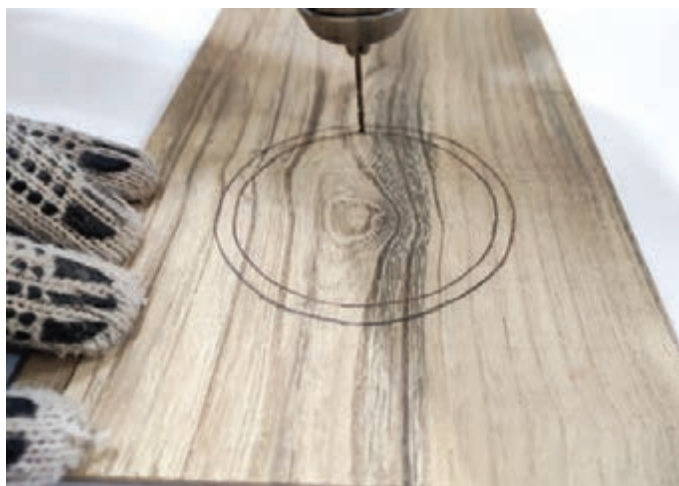
شکل ۳۱- سوراخ کاری و برش زهوار منحنی
