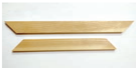
شکل ۴۹- قطعات قاب آماده شده با برش ۴۵ درجه
