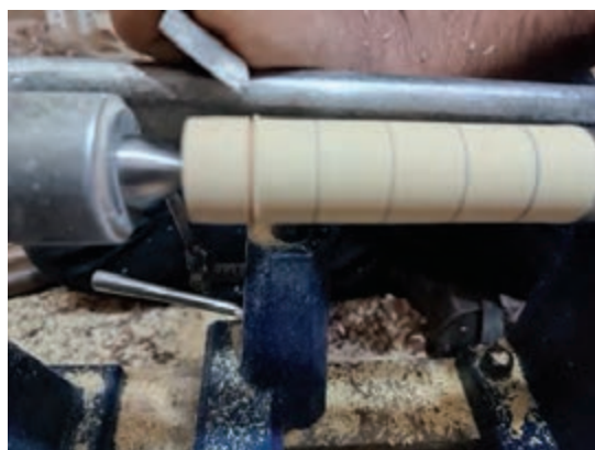
شکل ۴۵- خط‌کشی مسیرهای فرم‌دهی روی قطعه
