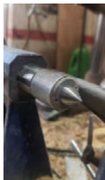
شکل ۲۱- مرگ متحرک دستگاه، پایه و ضامن
