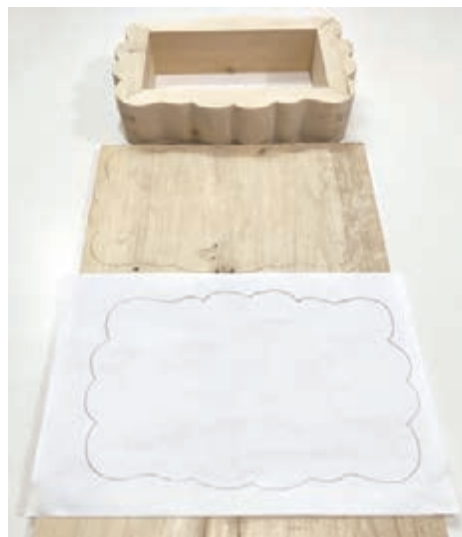
شکل ۴۴- انتقال الگو روی قطعه چوب در کف
