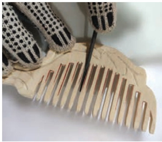
شکل ۳۶- سوهان و سنباده کاری دندانه‌ها
