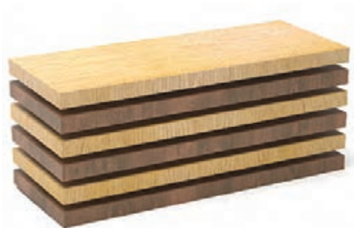
شکل ۵- لایه‌های آماده پرس از چوب تیره و روشن
