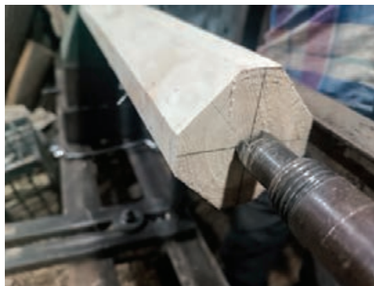
شکل ۲۵- محکم کردن قطعه با اهرم ها
