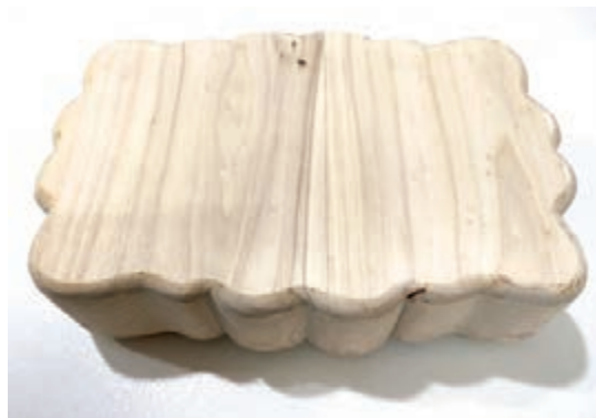
شکل ۵۰- ابزار خورده در جعبه
