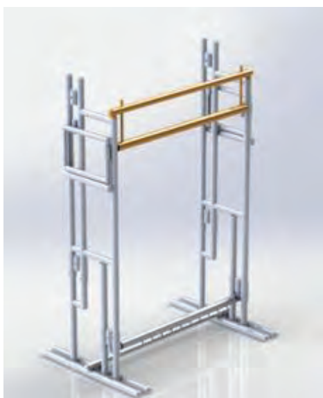
شکل ۱۸- قرار دادن مهار بالای جلو
