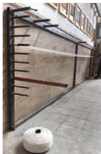
شکل ۹- چله‌دوانی با استفاده از قاب چله‌دوانی
