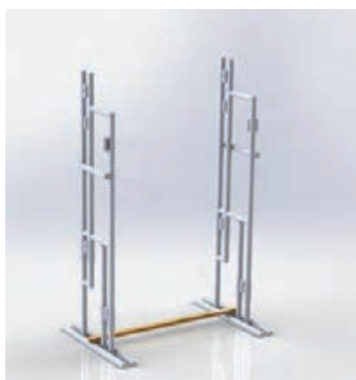
شکل ۱۶- قرار دادن مهار پایین
