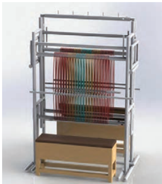
شکل ۱- دستگاه بافت عمودی جاجیم
