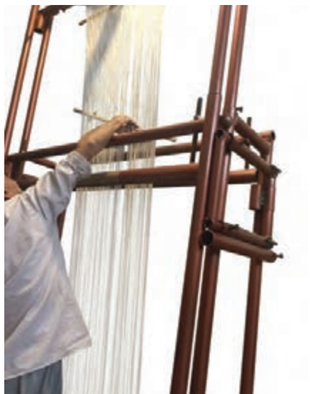
شکل ۲۱- پایین آوردن چوب مهار و مرتب کردن تارها
