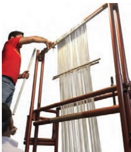
شکل ۱۹- بستن چله ها بر روی تیر بالا
