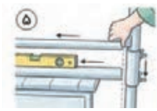
بستن اجزای دستگاه با رعایت فواصل و موازی با افق
