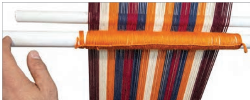
شکل ۲۳- تغییر دهانه بافت با جابه‌جا کردن هاف
