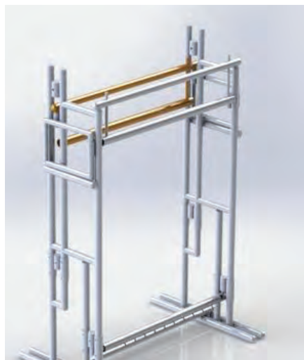
شکل ۱۹- قرار دادن مهار بالای پشت
