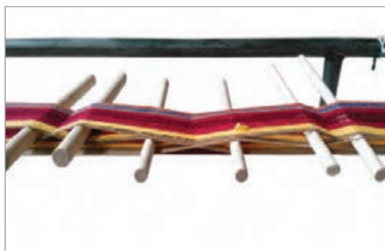
شکل ۷- تقسیم چله در جاجیم‌هایی که با چهار کوچی بافته می‌شوند.
