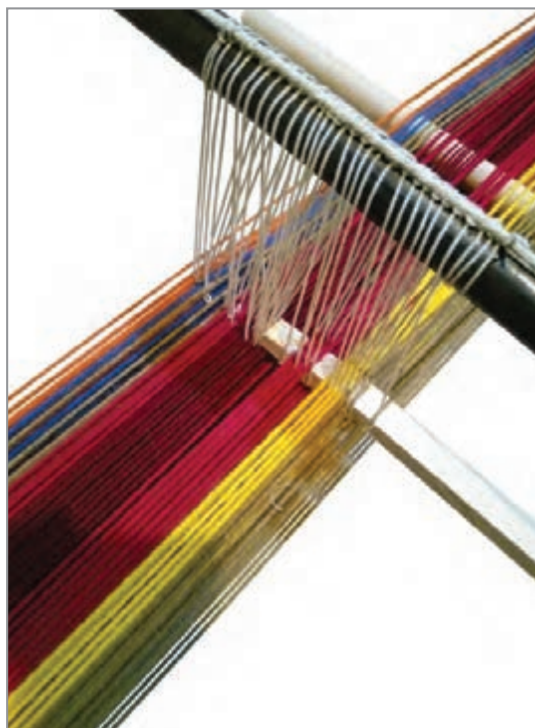
شکل ۱۰- کوجی‌بندی و بیرون آوردن چوب از لابه‌لای تارها
