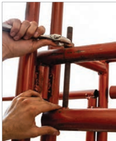
شکل ۱۸- بستن پیچ‌های دستگاه برای اعمال کشش نهایی به چله
