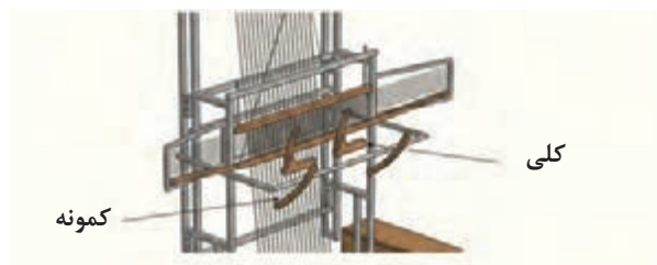
قسمتی از دستگاه بافت زیلو و اجزای آن شکل ۱۰- معرفی قطعات دستگاه زیلوبافی
