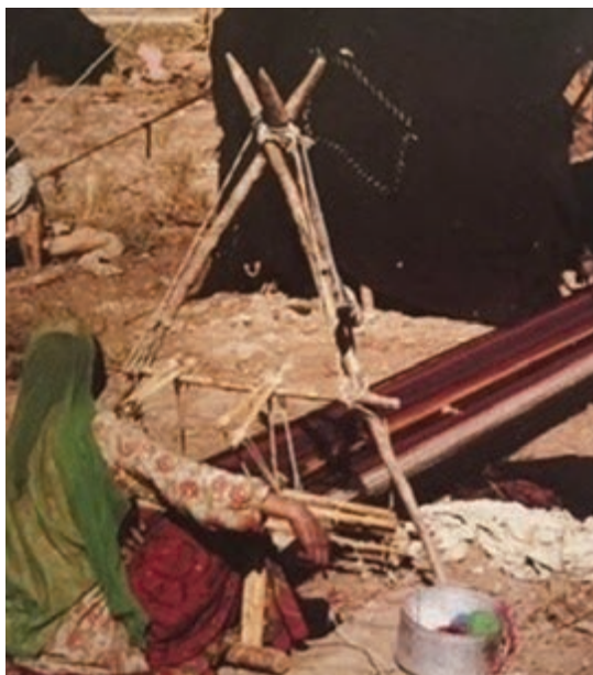
شکل ۲- نمونه دستگاه افقی بافت جاجیم
