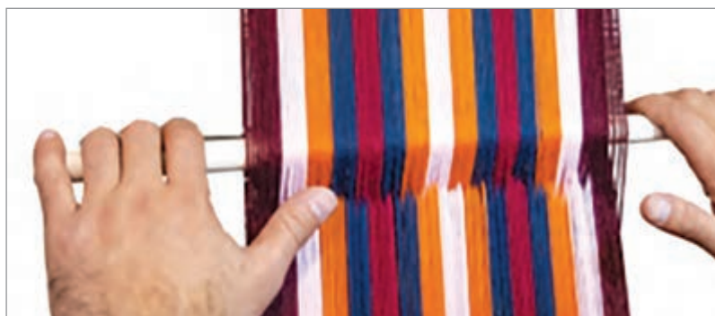
شکل ۲۶- تغییر دهانه بافت با جابه‌جا کردن هاف
