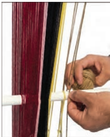
شکل ۵- چله کشی جاجیم با امکان پایین کشی
