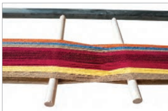
شکل ۷- تقسیم چله در جاجیم‌هایی که با چهار کوچی بافته می‌شوند.
