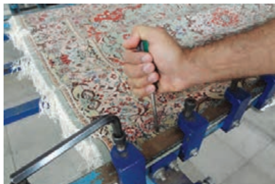
تصویر ۱۶- بستن عرض فرش بر روی دستگاه پرسی
