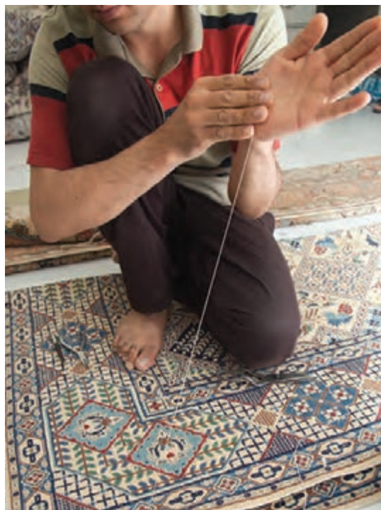
تصویر ۳۶- تابیدن دو نخ با هم در جهت قبل
