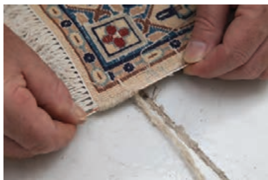
تصویر ۴۲- مراحل پیچیدن شیرازه بر لبه دوخته شده
