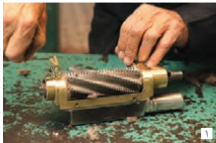
تصویر ۸- تمیز کردن تیغه لول و خارج کردن پرزهای باقی مانده از آن
