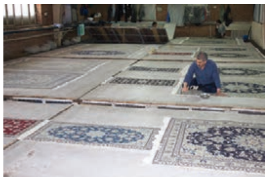
تصویر ۴- دارکشی با میخ و چنگک
