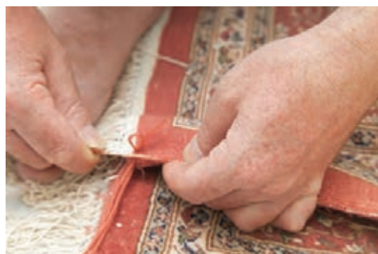
تصویر ۲۸- نحوه قرارگیری نخ تراز و وارد کردن سوزن
