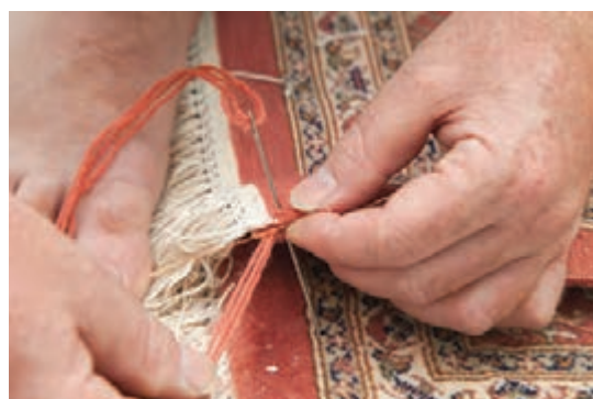
تصویر ۲۹- وارد کردن سوزن در رج بعدی
