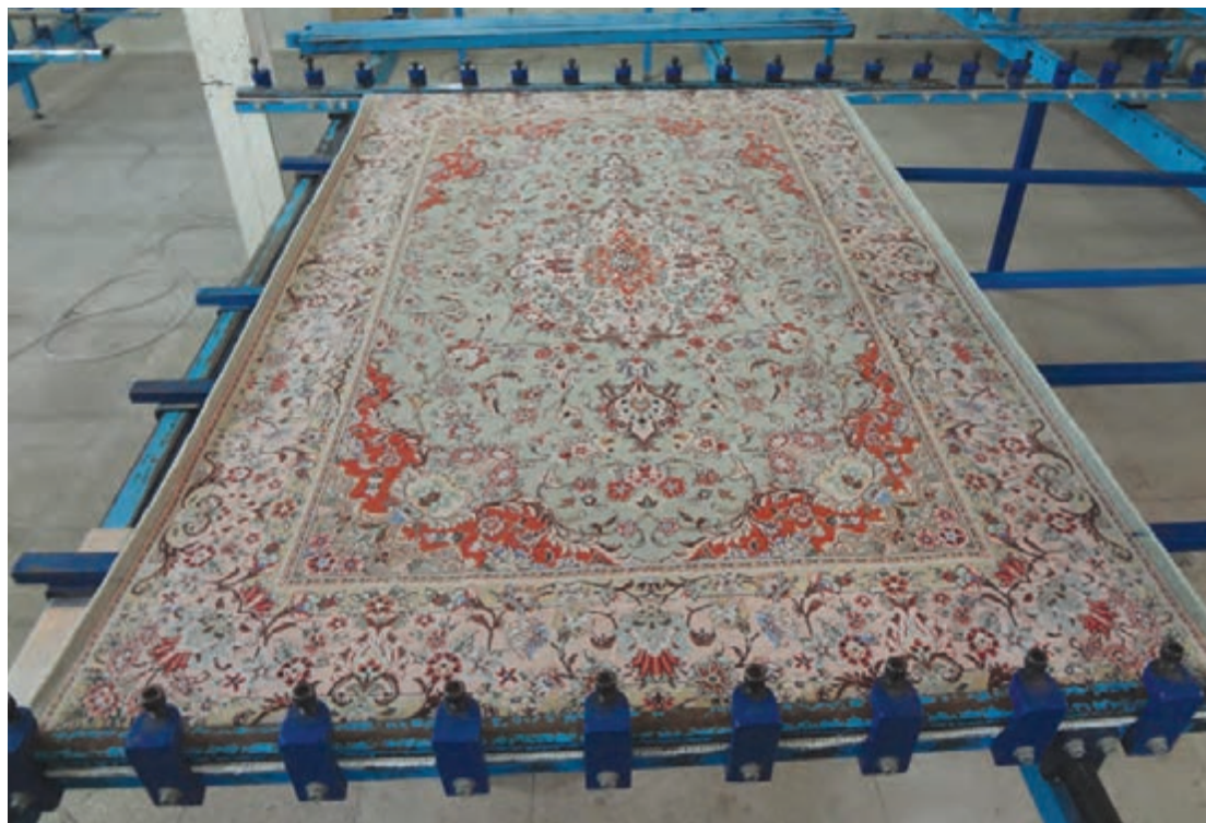
تصویر ۱۲- قالی بسته شده قدی بر روی دستگاه پرسی
