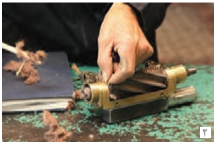
تصویر ۸- تمیز کردن تیغه لول و خارج کردن پرزهای باقی مانده از آن
