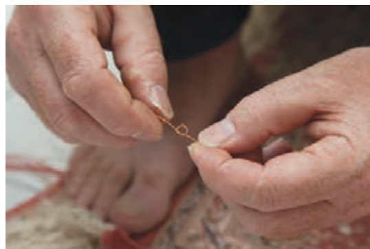
تصویر ۲۶- مراحل قرار دادن نخ تراز
