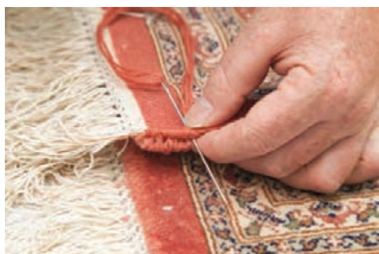
تصویر ۲۹- وارد کردن سوزن در رج بعدی
