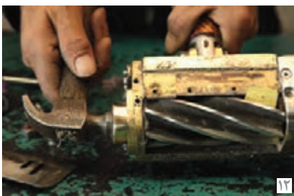
تصویر ۱۰- مراحل باز و بسته کردن تیغه‌های برش ماسوره
