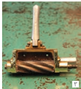
تصویر ۸- تمیز کردن تیغه لول و خارج کردن پرزهای باقی مانده از آن
