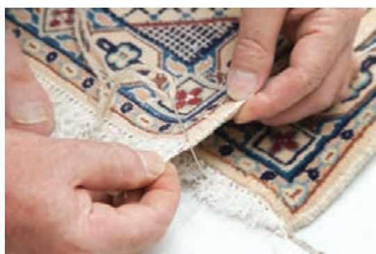
تصویر ۴۱- تنظیم کشش نخ هنگام دوخت
