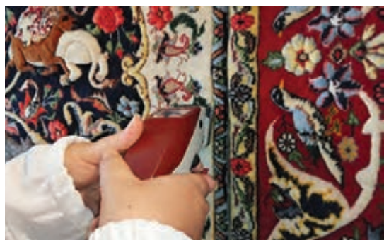
شکل ۱۷- برجسته کاری با ماشین اصلاح
