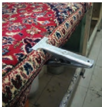
تصویر ۱۴- فرش وصل شده به میز با گیره
