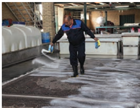
تصویر ۲۰- پاشیدن پودر شوینده بر فرش خیس شده
