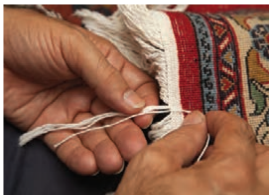
تصویر ۱۷- دوگره زنی در صورت پاره شدن نخ
