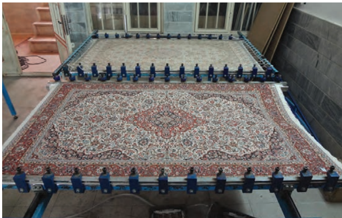
تصویر ۲۳- کشش عرضی فرش و خشک کردن به وسیله کباب پز (مرحله ۷)
