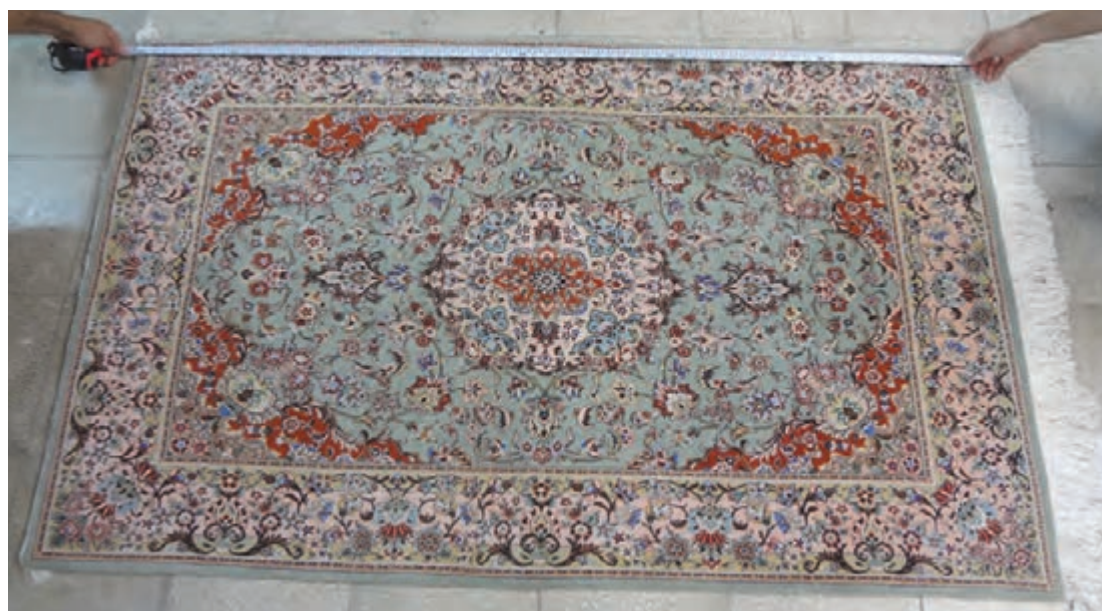
تصویر ۶- اندازه‌گیری طول یک طرف قالی با متر
