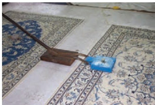
تصویر ۴- دارکشی با میخ و چنگک
