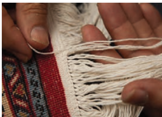
تصویر ۱۷- دوگره زنی در صورت پاره شدن نخ
