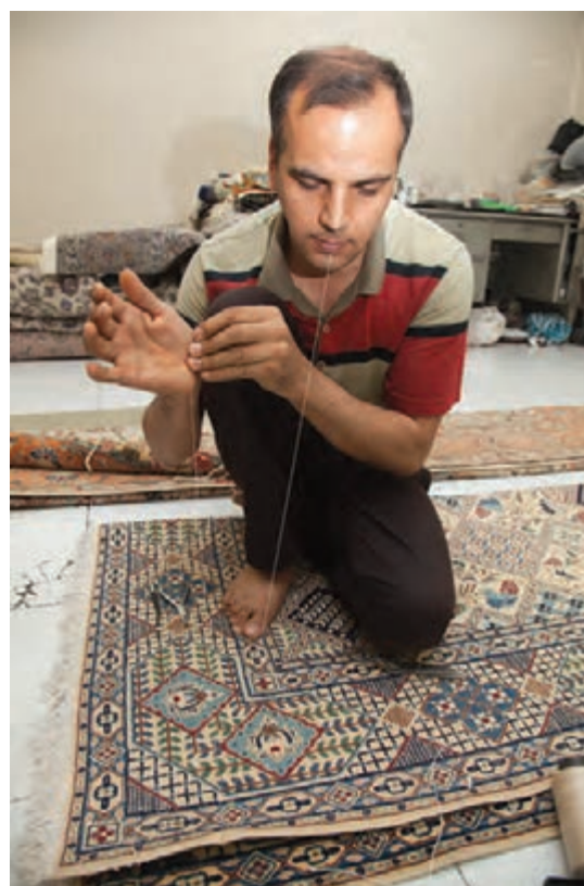
تصویر ۳۴- قرار دادن نخ در زیر پا و لای دندان
