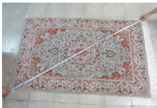
تصویر ۹- اندازه‌گیری قطرهای قالی با متر
