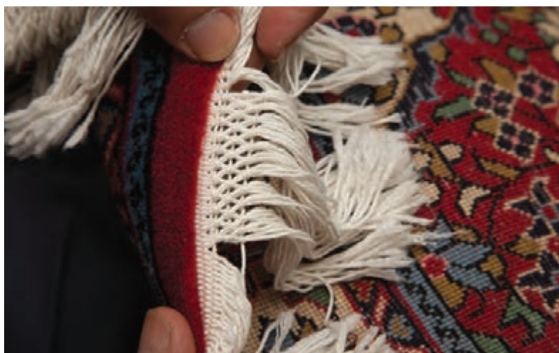
تصویر ۲۱- مرحله دوم دو گرہ پنجره‌ای و فرم لوزی شکل آن
