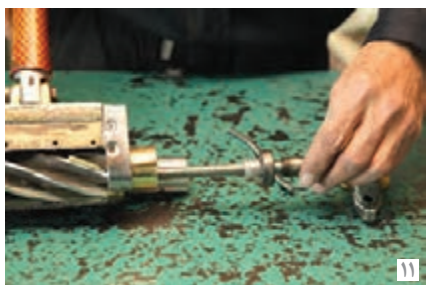
تصویر ۱۰- مراحل باز و بسته کردن تیغه‌های برش ماسوره
