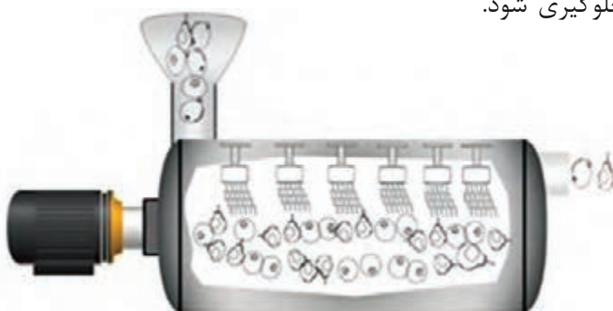
شکل ۳- استوانه‌های گردان شست‌وشو دهنده برای میوه‌های سفت مثل سیب
