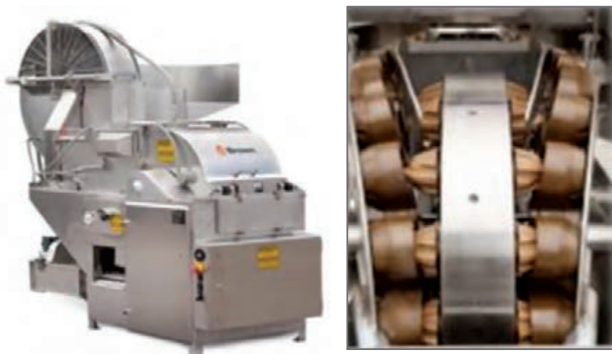
شکل ۱۱- استخراج عصاره مرکبات به روش خرد کردن و فشردن با ابزار مخروطی (Reaming)
