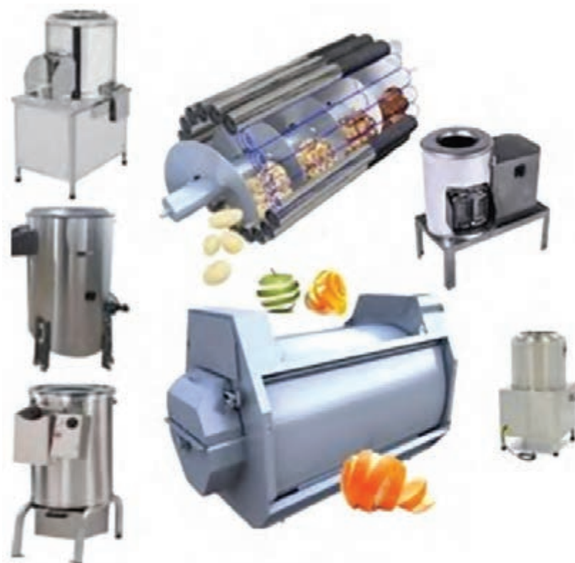
شکل ۴- دستگاه های صنعتی برای پوست گیری میوه های مختلف
