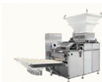
شکل ۱۰- تصاویر دستگاه چانه‌گیر
