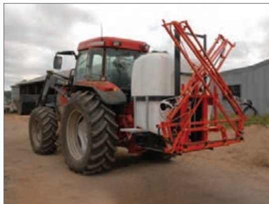
شکل ۶۱- سم پاش بوم دار در دو حالت کار و حمل و نقل
