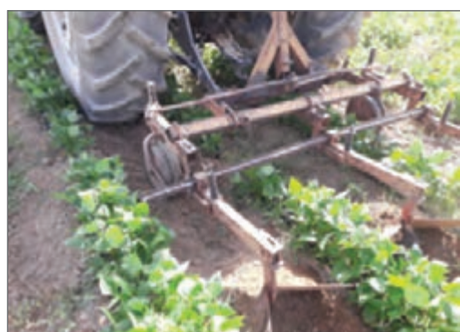
شکل ۷۷- وجین کن بیلچه‌ای عریض در حال وجین لوبیا با فاصله ردیف ۷۵ سانتی‌متر
