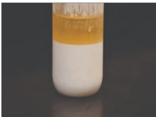
شکل ۴- دوفاز شدن محلول سم (راست) و یا ایجاد کف زیاد در مخزن (چپ)
