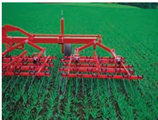
شکل ۵۲- چنگه دندانه انگشتی در حال شکستن سله بین ردیف‌های محصول
