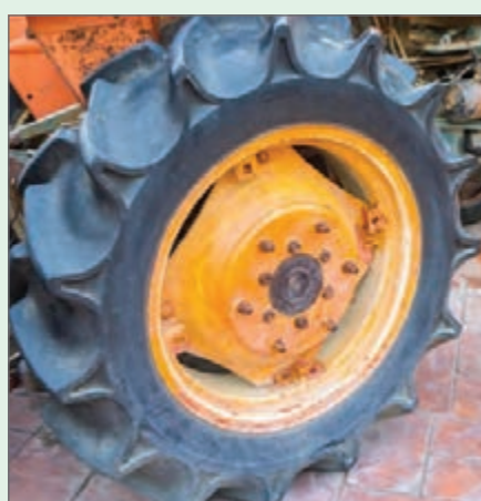
شکل ۸۲- تغییر جهت تحدب دیسک‌ها
