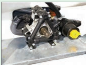
شکل ۷۳- بازدید و تعویض فیلترهای نازل و پمپ
