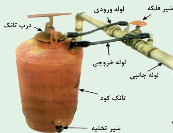
شکل ۳۷- اجزای سیستم توزیع کود
