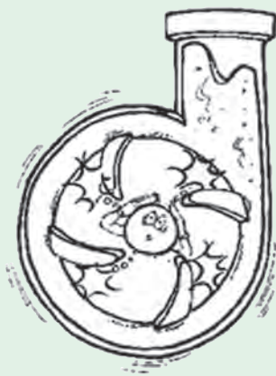
شکل ۵۲- کاویتاسیون در پروانه پمپ
