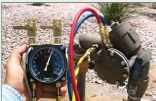
شکل ۵۴- تنظیم فشار شیر فشار شکن
