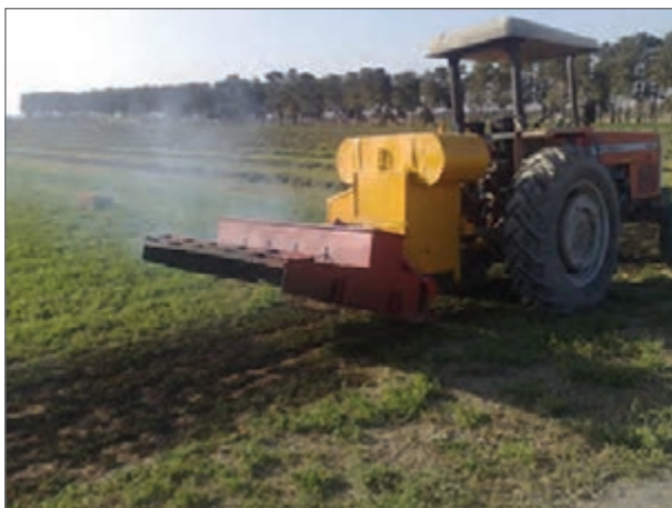
شکل ۲۹- استفاده از شعله‌افکن برای کنترل گیاهان ناخواسته سس در مزرعه یونجه
