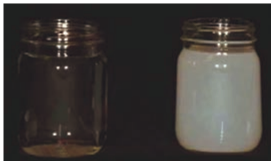
شکل ۵- حل شدن علف کش گلایفوسیت در آب مقطر (چپ) و اتصال مولکول‌های گلایفوسیت به یون‌های آب سخت (راست).
