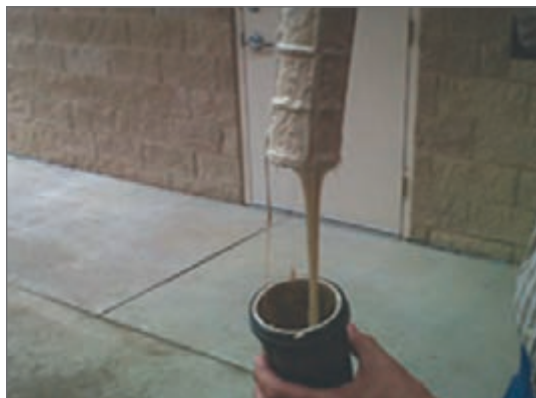
شکل ۳- تبدیل محلول به حالت خمیری و یا ژله‌ای شدن آن به دلیل عدم سازگاری دو ترکیب
