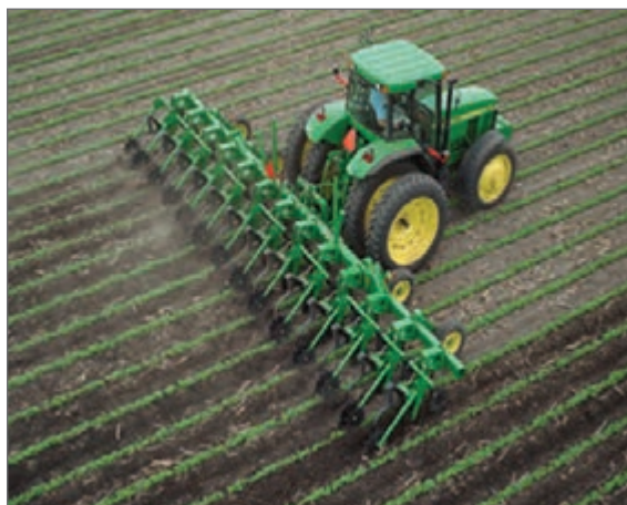
شکل ۴۴- عملیات مکانیزه وجین و سله‌شکنی
