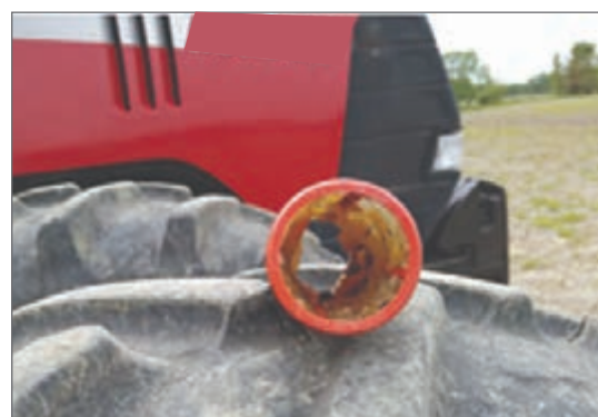
شکل ۲ - گرفتگی صافی ها در شرایط ناسازگاری دو ترکیب شیمیایی مورد استفاده در سم پاش
