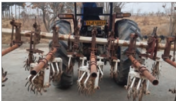
شکل ۶۷- تراز طولی و عرضی در اتصال کولتیواتور غلطان به تراکتور رعایت نشده است.
