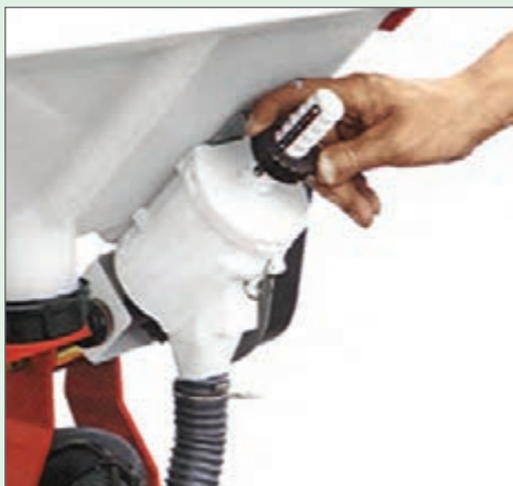
شکل ۸۵- موزع در کودکار فاروئر و پنجه کودریز برای تنظیم مقدار پخش کود
