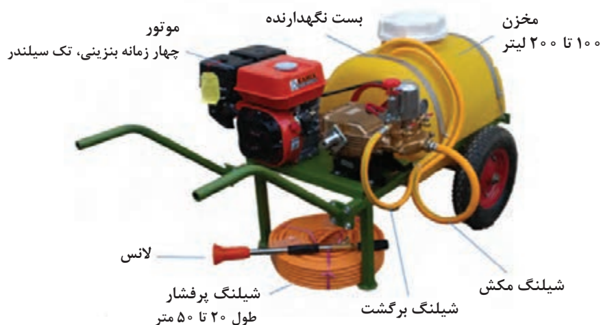
شکل ۶۰- سم پاش فرغونی و اجزای آن
