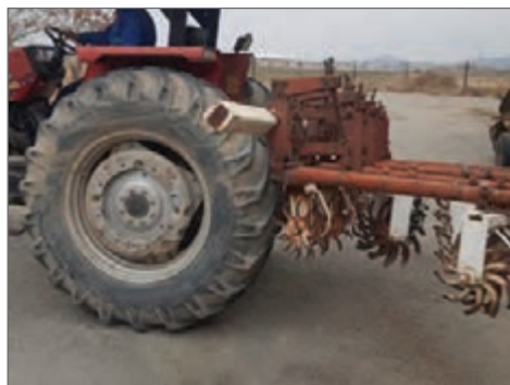
شکل ۶۷- تراز طولی و عرضی در اتصال کولتیواتور غلطان به تراکتور رعایت نشده است.
