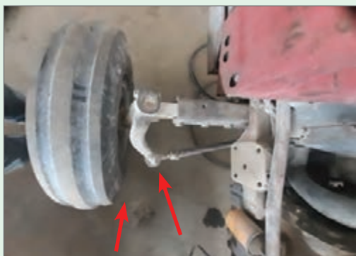
شکل ۸۰- پیچ‌های دسته عامل فرمان و پیچ‌های محور فرمان
