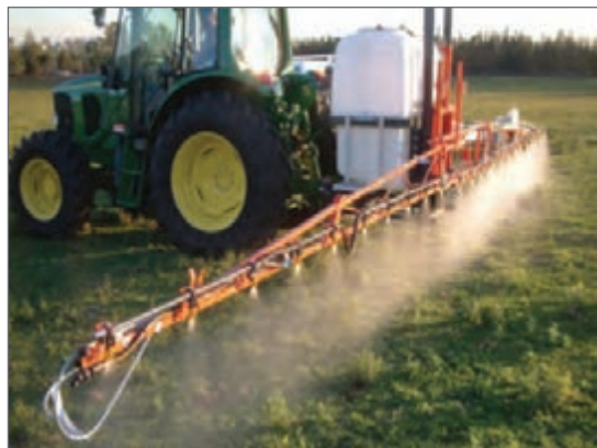
شکل ۶۱- سم پاش بوم دار در دو حالت کار و حمل و نقل
