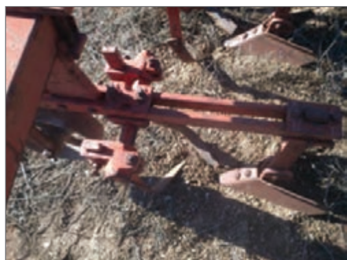
شکل ۷۸- وجین کن نوع پنجه‌غازی با تیغه‌های کاردی شکل
