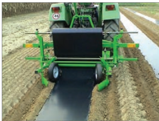
شکل ۲۶- پیشگیری از رویش گیاه ناخواسته با مالچ پلاستیکی و با استفاده از ماشین پلاستیک‌کش
