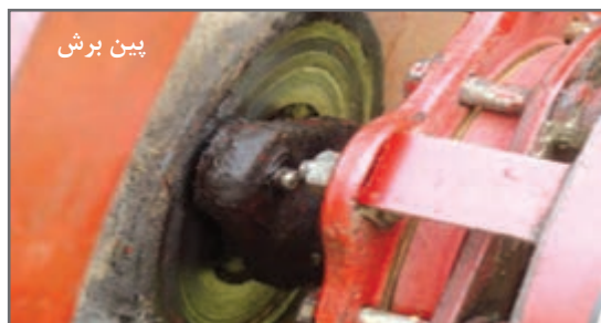
شکل ۱۱- پین برشی و کلاچ ایمنی در دستگاه بسته‌بند
