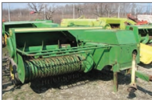
شکل ۵- استوانه مارپیچ برای هدایت علوفه به محفظه تراکم
