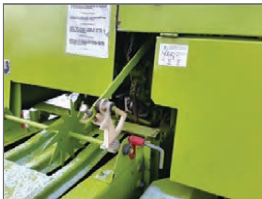
شکل ۱۹- چرخ دنده قطاعی تنظیم طول بسته
