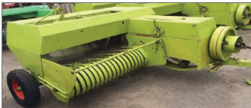
شکل ۱۴- جغجغه تنظیم ارتفاع بردارنده
