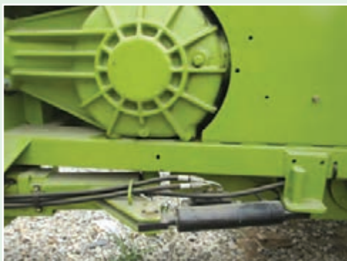
شکل ۳۹- محل بازدید و خروج روغن از جعبه دنده دستگاه بسته‌بند
