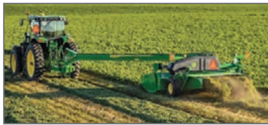
شکل ۴۹- دروکن تراکتوری با غلتک مخصوص به نام Conditioner
