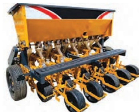
شکل ۱۲- بذر کار یونجه مجهز به چرخ های فشاردهنده جلویی و عقبی
