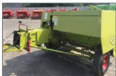
شکل ۳۶- صفحه انتهایی کانال در دو وضعیت حمل و نقل و کار
