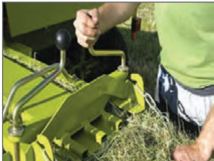
شکل ۱۸- تیرک‌های فشار دهنده و نحوه تنظیم آنها
