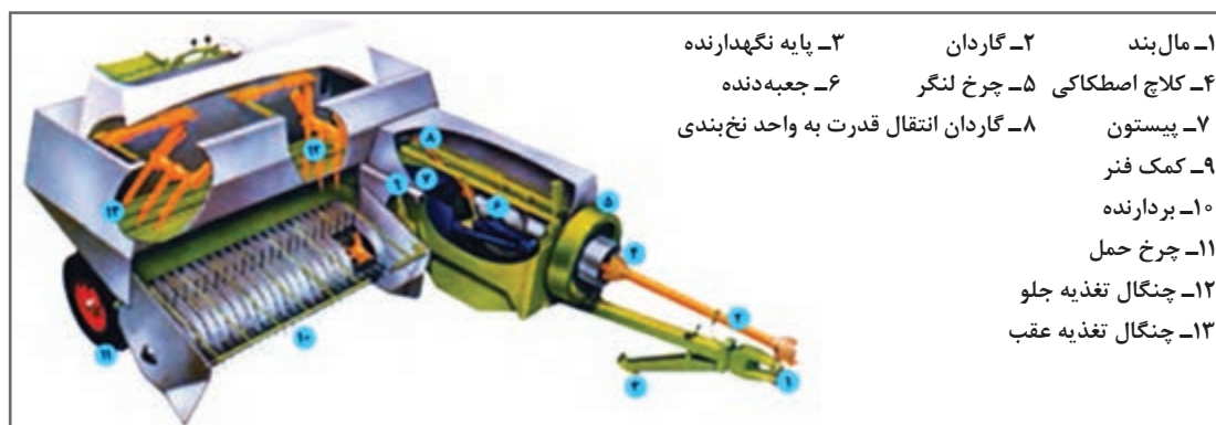
شکل ۳- اجزای تشکیل‌دهنده بسته‌بند مکعبی کوچک
