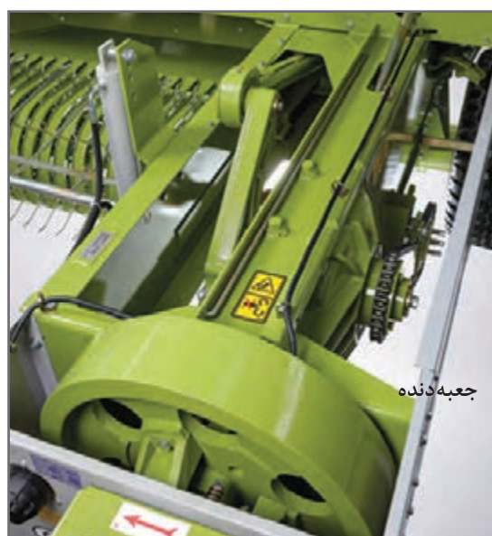
شکل ۱۲- مسیر انتقال توان در دستگاه بسته‌بند
