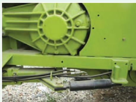
شکل ۳۲- جک هیدرولیک جهت تغییر وضعیت دستگاه از حالت حمل و نقل به حالت کار و بالعکس
