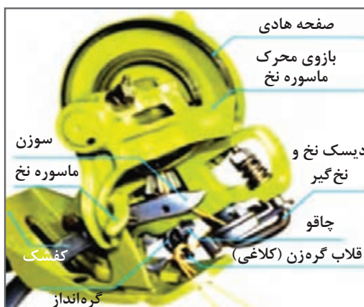
شکل ۷- اجزای واحد گره زن و محل قرارگیری آن بر روی دستگاه
