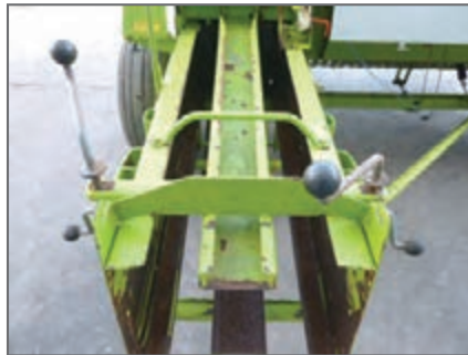
شکل ۱۸- تیرک‌های فشار دهنده و نحوه تنظیم آنها
