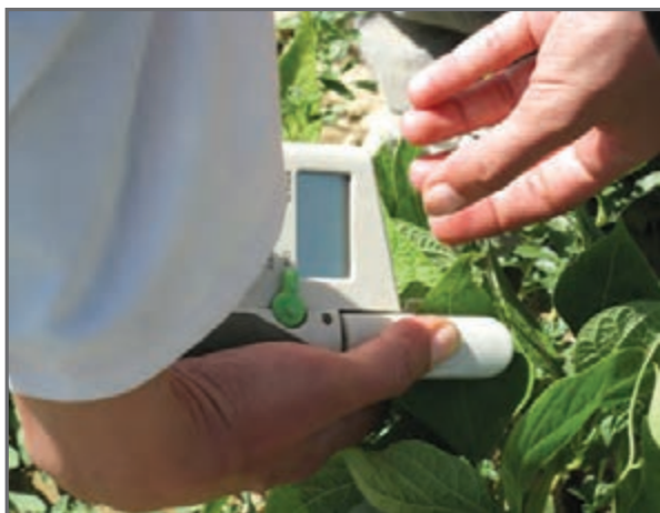
شکل ۸۲- تشخیص وضعیت عناصر غذایی در گیاه لوبیا با (SPAD) استفاده از دستگاه قابل حمل (پورتال) سنجش برگ
