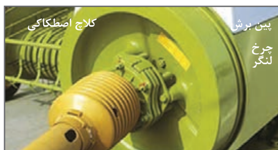
شکل ۱۱- پین برشی و کلاچ ایمنی در دستگاه بسته‌بند
