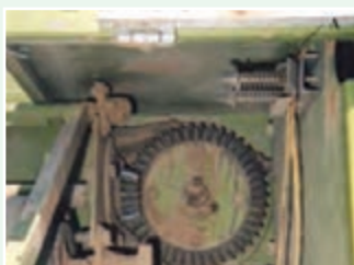
شکل ۲۵- تنظیم کننده کشش نخ
