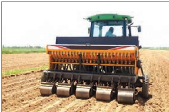
شکل ۱۲- بذر کار یونجه مجهز به چرخ های فشاردهنده جلویی و عقبی
