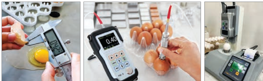
شکل ۴۷- اندازه‌گیری استحکام و ضخامت پوسته تخم مرغ
