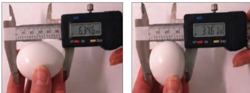
شکل ۴۴- اندازه‌گیری طول و عرض تخم مرغ با کولیس دیجیتال
