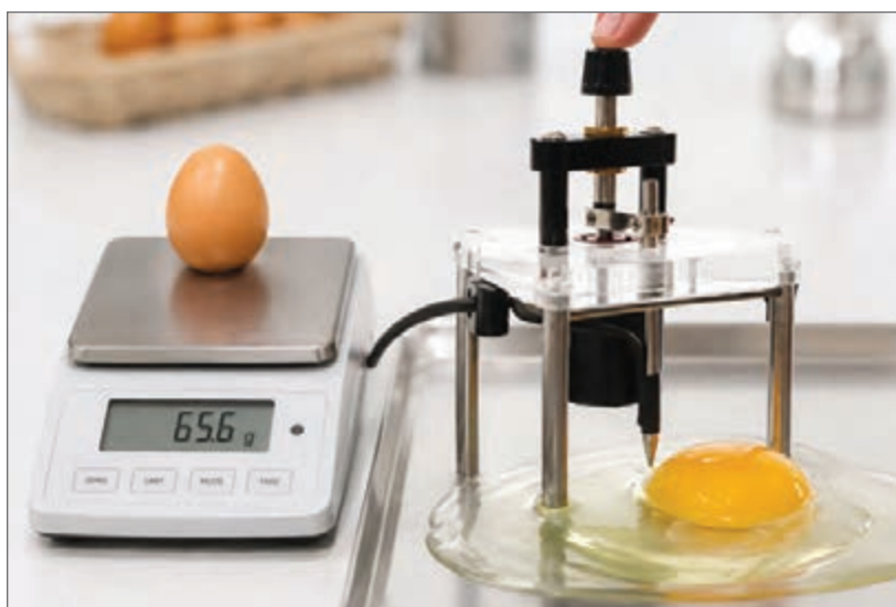
شکل ۴۰- اندازه‌گیری ارتفاع سفیده غلیظ تخم مرغ برای تعیین شاخص هاو
