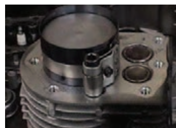
شکل ۴۹- جا زدن پیستون
