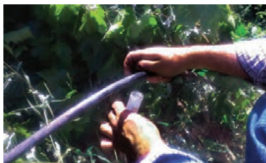
شکل ۸۴- اندازه‌گیری دبی قطره چکان‌ها در آبیاری قطره‌ای
