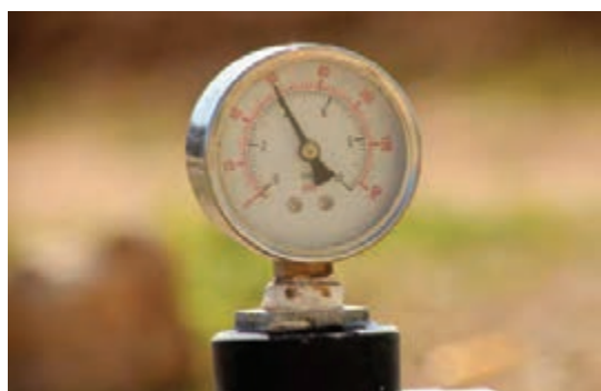
شکل ۴۲- فشارسنج استفاده شده در سامانه آبیاری بارانی
