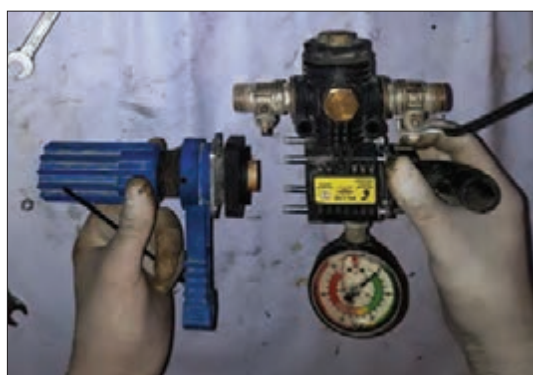
۱- پیچ های پوسته را باز کرده و دو قسمت رگولاتور را از هم جدا کنید.
