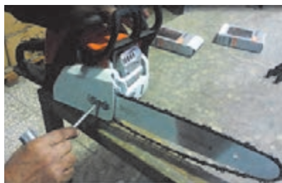
شکل ۱۹- تنظیم کشیدگی زنجیر
