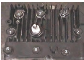
شکل ۵۱- ترتیب بستن پیچ‌های سرسیلندر
