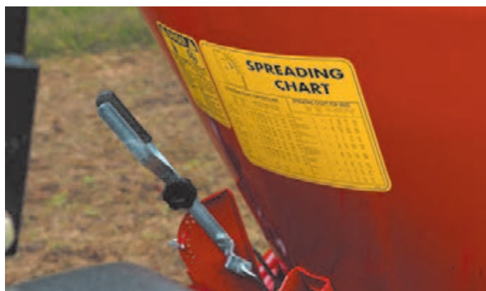
ب) اهرم تنظیم دریچه تخلیه مخزن در کودپاش دورانی
