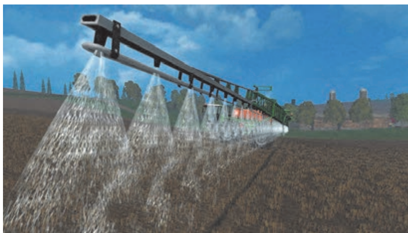
شکل ۱۵- با افزایش ارتفاع میزان همپوشانی و میزان بادبردگی افزایش می‌یابد.
