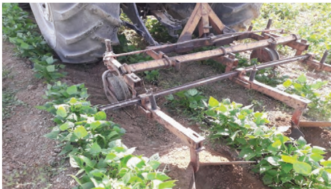
شکل ۲۵- وجین کن بیلچه ای عریض در حال وجین لوبیا با فاصله ردیف ۷۵ سانتی متر
