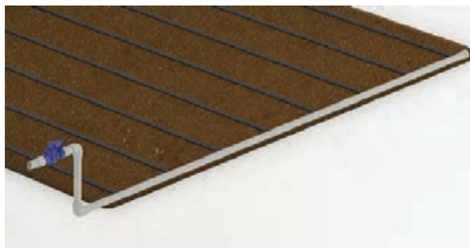
شکل ۸۹- شماتیک مانیفلد شست‌وشو در آبیاری قطره‌ای
