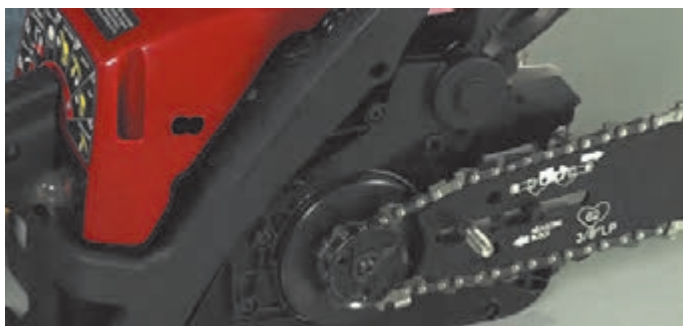
شکل ۷- کلاچ گریز از مرکز
