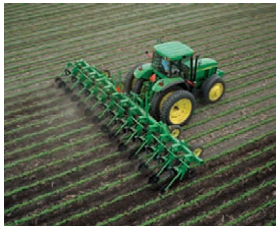
شکل ۶- عملیات مکانیزه وجین و سله شکنی
