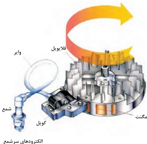
شکل ۲۸- طرز کار سیستم جرقه‌زنی
