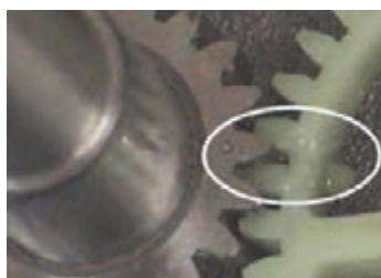
شکل ۵۰- علامت تایم کردن میل بادامک
