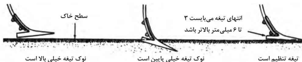
شکل ۲۷- تنظیم زاویه نفوذ تیغه
