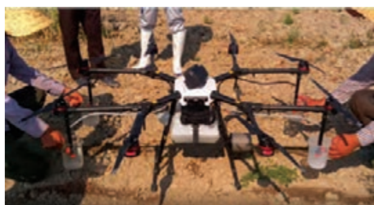
شکل ۲۰- اندازه گیری دبی نازل پهپاد سم پاش
