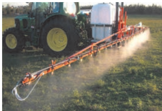
شکل ۶- سم پاش بوم دار در دو حالت کار و حمل و نقل
