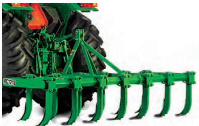
شکل ۲۲- اتصال پنجه سوار به تراکتور
