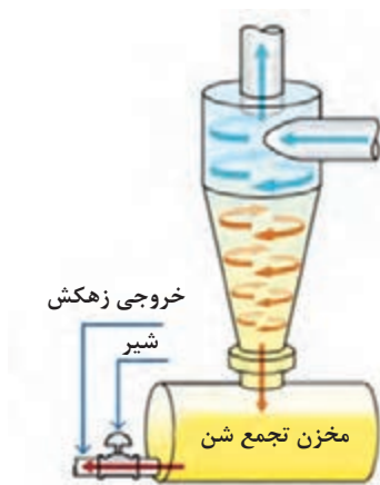
شکل ۵۶- مکانیسم جداسازی ذرات شن از آب در هیدروسیکلون
