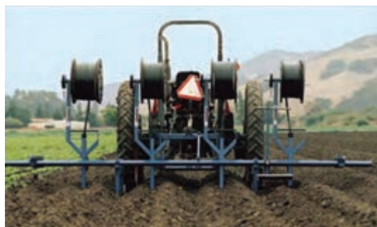
شکل ۶۹- دستگاه مکانیزه خواباندن نوارهای آبیاری تیپ در مزرعه
