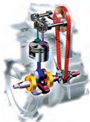
شکل ۲۵- میل سوپاپ بالای سیلندر
