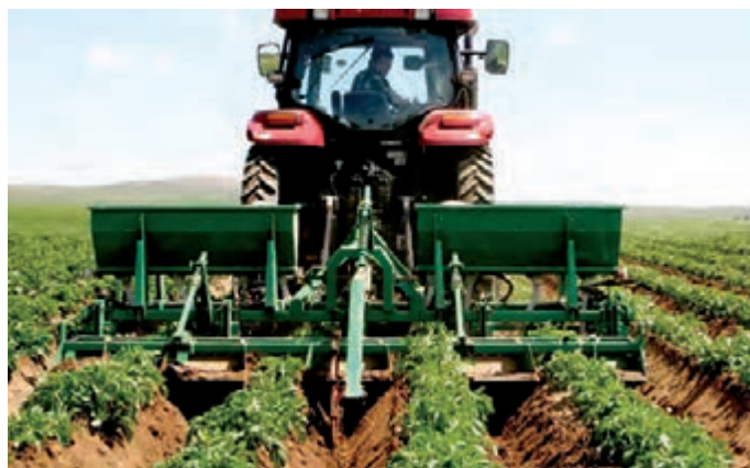
شکل ۲۸- اجرای عملیات وجین، سله‌شکنی و خاک‌دهی پای بوته
