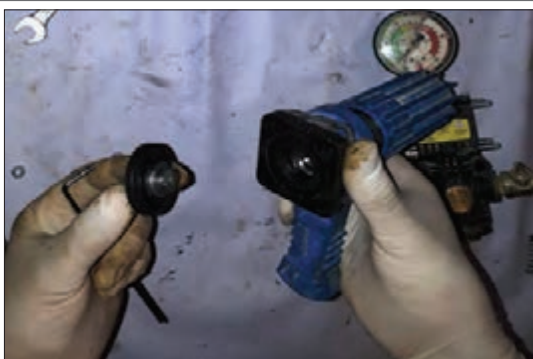
۴- دیافراگم فرسوده را تعویض نموده مجدداً در جای خود قرار دهید. سپس قطعات را عکس مراحل باز کردن مونتاژ کنید.
