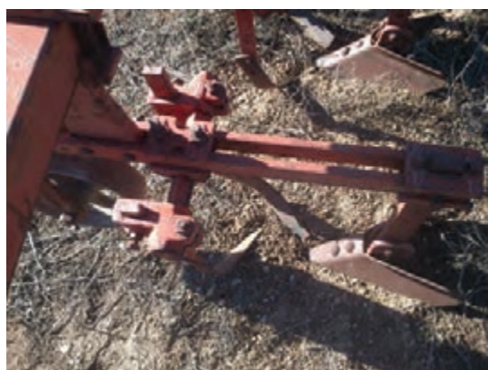
شکل ۲۶- وجین کن نوع پنجه غازی با تیغه های کاردی شکل
