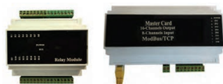
شکل ۴۶- کارت خروجی رله
