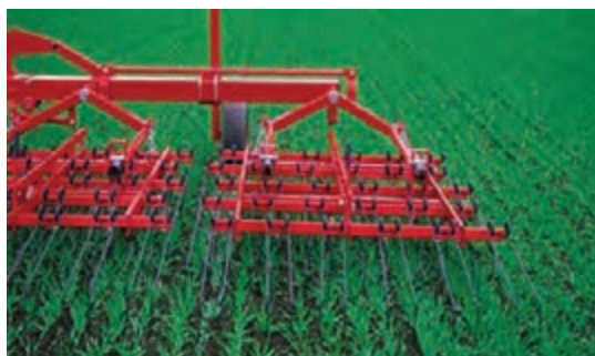
شکل ۱۴- چنگه دندان‌انگشتی در حال شکستن سله بین ردیف‌های محصول
