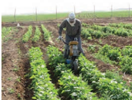
شکل ۱۲- وجین کن دوار موتوری (راه رونده) در حال کار
