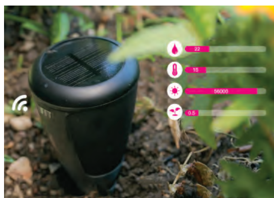
شکل ۲- یک حسگر کاربردی در سیستم کنترل هوشمند کیفیت خاک
