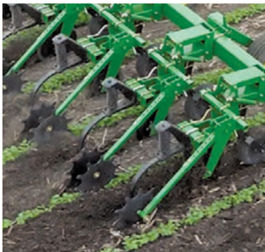
شکل ۸- پنجه شاخه‌ای دارای سپر محافظ با شاخه‌های مجهز به ضامن فنری
