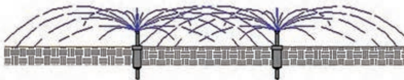
شکل ۴۷- یکنواختی پاشش آبپاش‌ها
