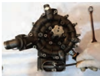
شکل ۳۸- باز کردن درپوش سوپاپ‌ها
