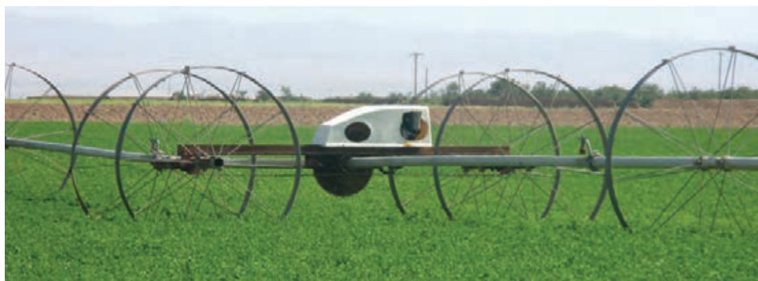
شکل ۸- موتور بنزینی و ارابه چهار چرخ دستگاه ویل موو
