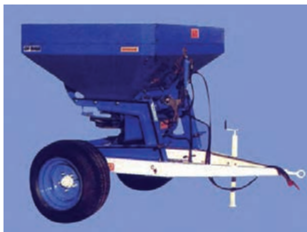
شکل ۳۰- کودپاش دورانی سوار و کششی
