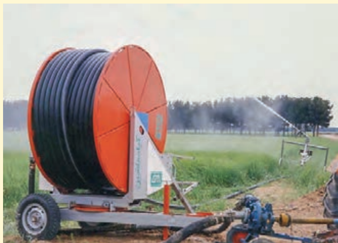
ماشین آبیاری قرقه‌ای در حال کار با پمپ آب متصل به تراکتور
