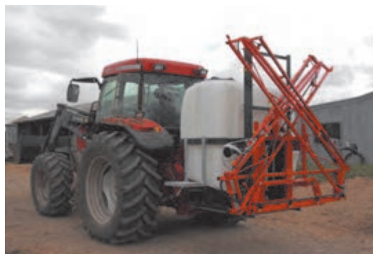
شکل ۶- سم پاش بوم دار در دو حالت کار و حمل و نقل
