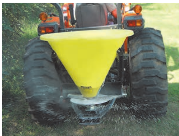
شکل ۳۰- کودپاش دورانی سوار و کششی
