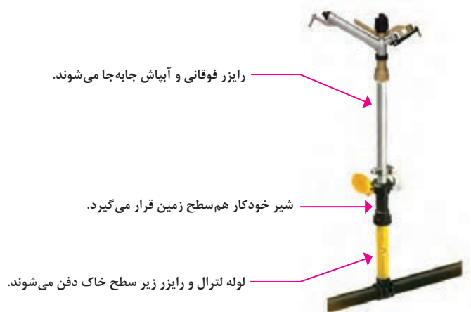
شکل ۵- جابه‌جایی و نصب آبپاش در آبیاری کلاسیک با آبپاش متغیر
