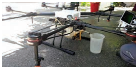
شکل ۱۹- اندازه گیری دبی پمپ
