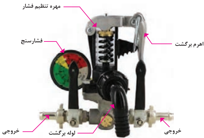
شکل ۳۳- شیر تنظیم فشار مدل کم
