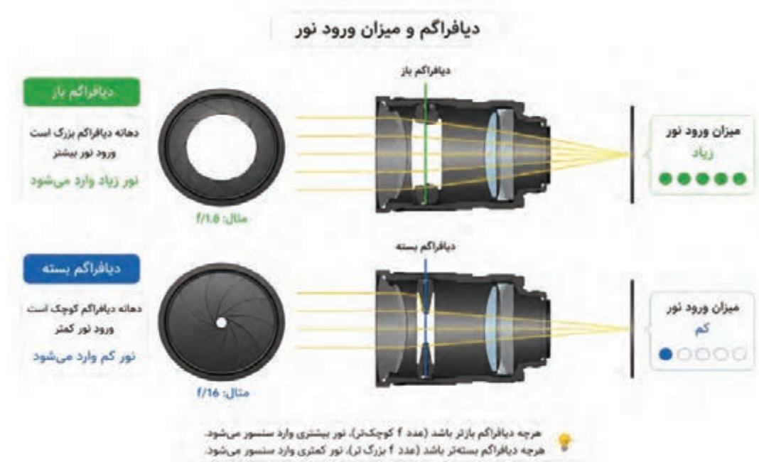
تصویر ۷- دیاگرام دیافراگم و میزان ورود نور
