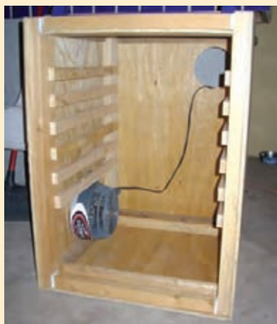
تصویر ۵۲- نمونه‌ای از اتاق تاریک همراه با هواکش و قفسه‌های قرارگیری شابلون
