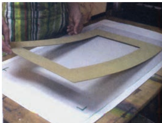
تصویر ۸۴- استفاده از یک قاب مقوایی ضخیم برای جفت و جفت کردن صفحه لینولئوم
