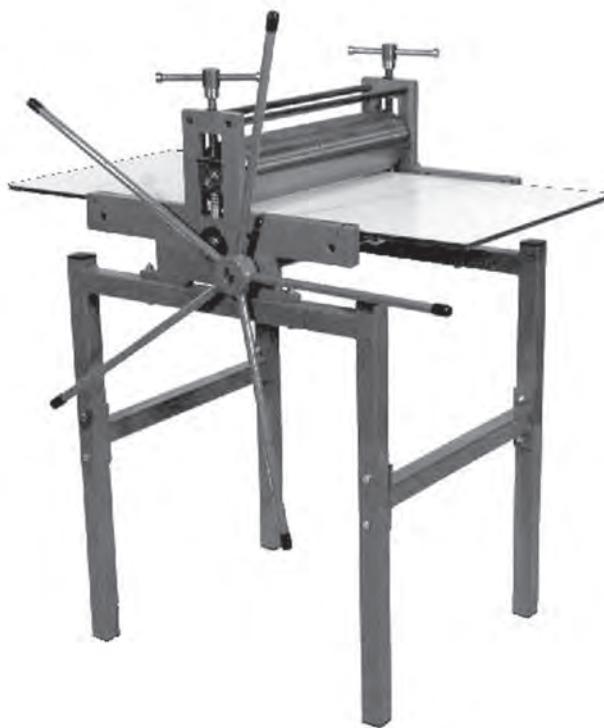
ب) پرس سیلندری مخصوص کالکوگرافی
