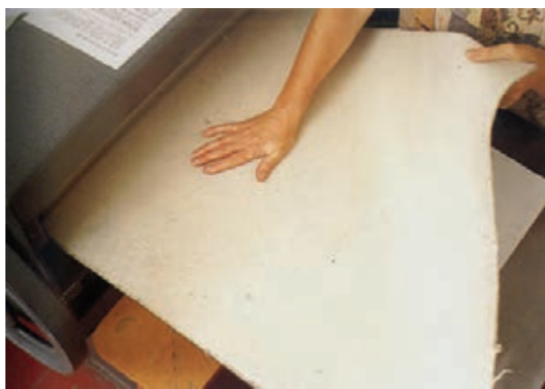
تصویر ۱۸۴- قرار دادن نم‌روی کلیشه و مقوا
