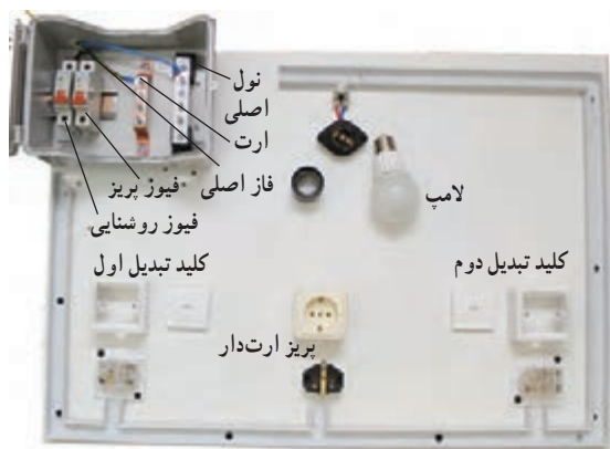
شکل ۶-۲۰- جانمایی قطعات مدار کلید تبدیل
