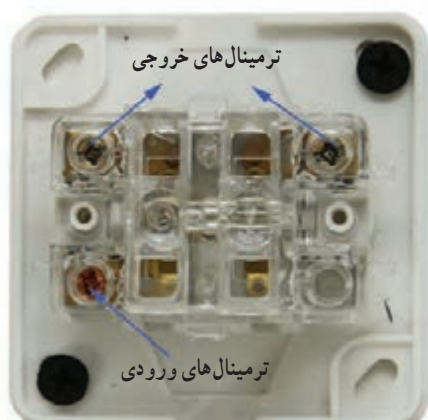
شکل ۱۴-۶- مدار داخلی کلید دو پل
