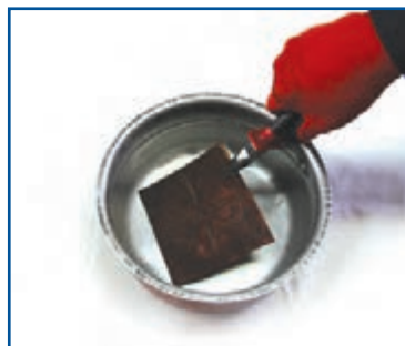
شکل ۹-۱۱- سرد کردن پلاک مسی با آب
