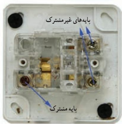
شکل ۶-۱۹- نمای داخلی یک نمونه کلید تبدیل
