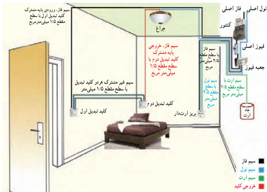
شکل ۱۸-۶ - سیم‌کشی مدار کلید تبدیل
