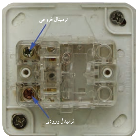
شکل ۴-۶- نمای داخلی یک نمونه کلید یک پل
